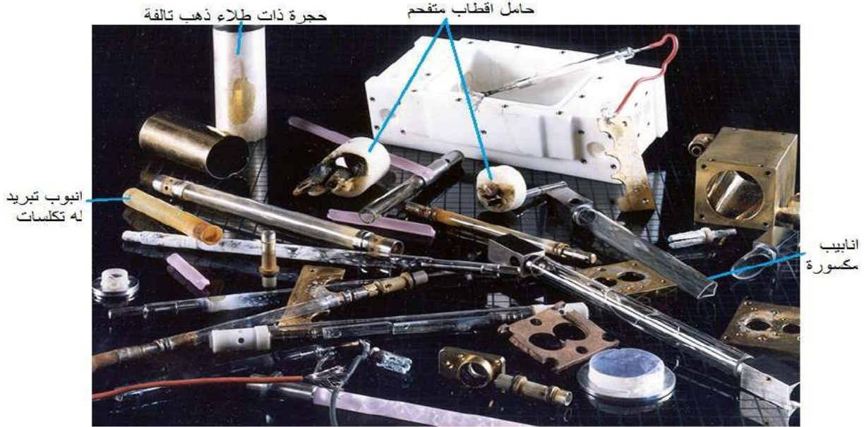
شكل (4-4): توضح بعض من الحجرات العاكسة ومكوناتها التالفة.
