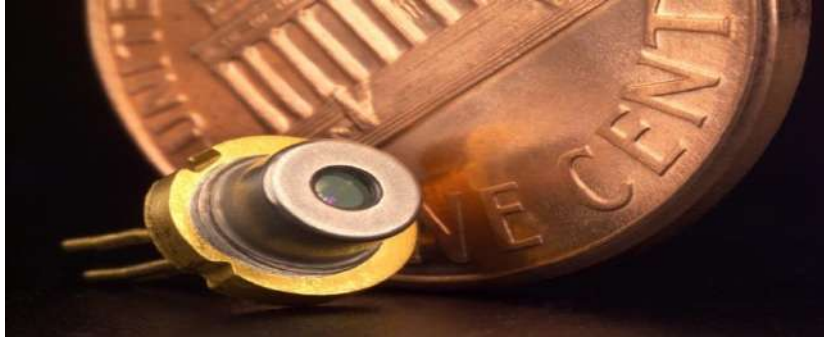
شكل (2-7) يوضح صغر حجم ليزر الدايدود مقارنة بعمله نقدية
