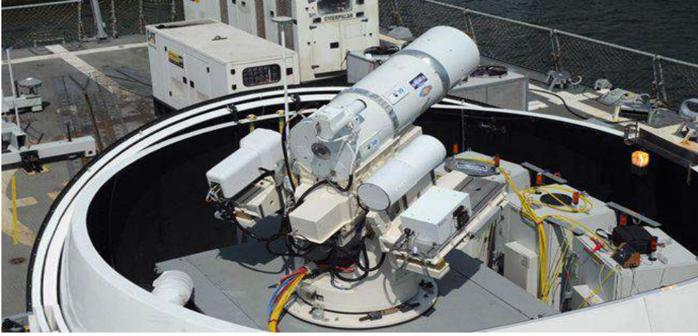
شكل (1-4) : صورة لليزر الحالة الصلبة ذي حجم كبير منصوب على بارجة حربية
