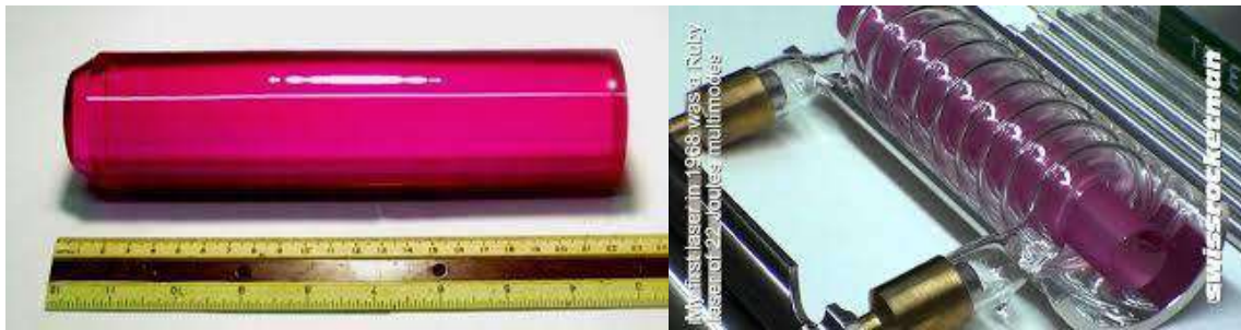
شكل 2 - 10: مقطع جانبي لليزر الياقوت
