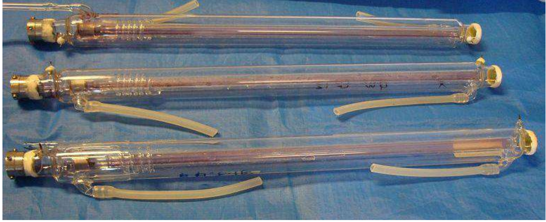
شكل (5-10): يوضح حجرة الوسط الفعال لليزر الغاز المختوم بأحجام مختلفة مضاف إليه خزان الماء للتبريد
