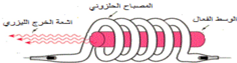
شكل (4-11): يوضح موضع البلورة او الوسط الفعال الليزري داخل المصباح
