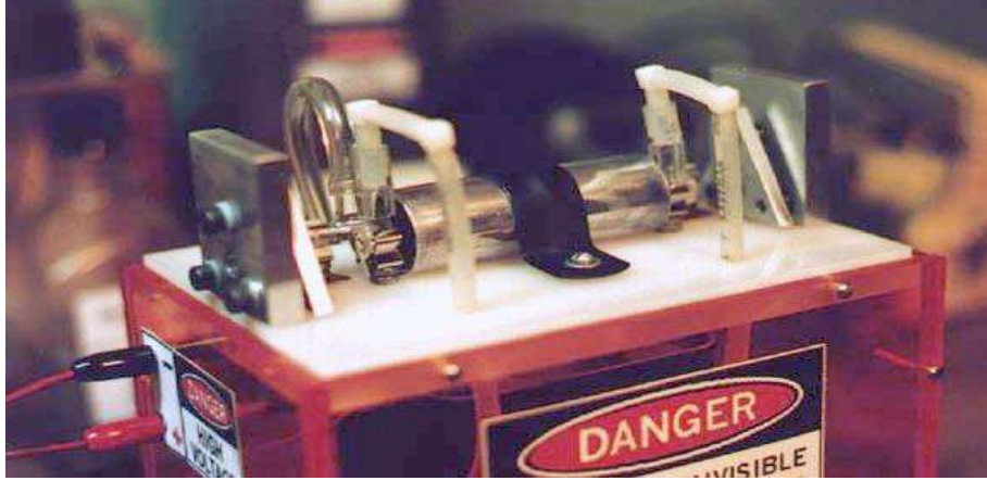
الشكل (4-6): يوضح منظومة لليزر الصبغة مصنعة بشكل حرفي وذات إمكانيات بسيطة
