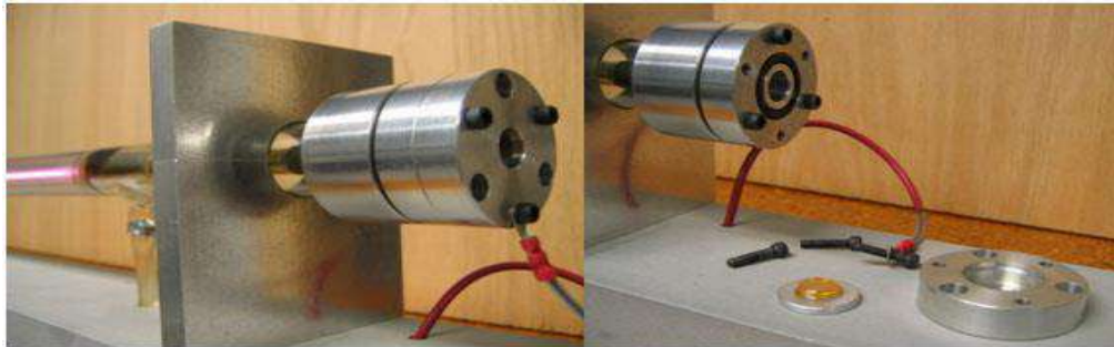
شكل (1-7): اقطاب التفريغ الكهربائية لمنظومة ليزر CO 2 .
