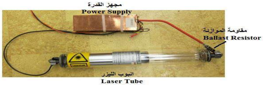
شكل (5-16): يوضح صورة لمجهز القدرة مع المقاومة مع الانبوب الليزري
