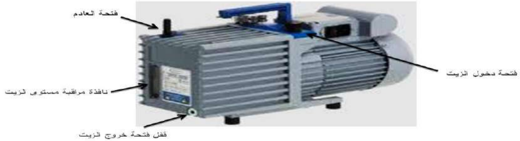
الشكل 8-9: يوضح أجزاء المضخة المؤشرة والمطلوبة عند تبديل الزيت
