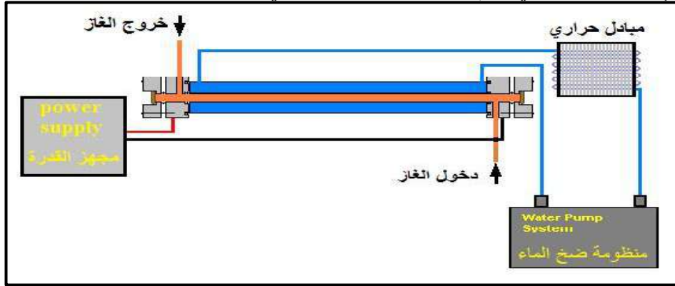
شكل (8-1): مخطط لتوضيح منظومة التبريد باستخدام الماء
