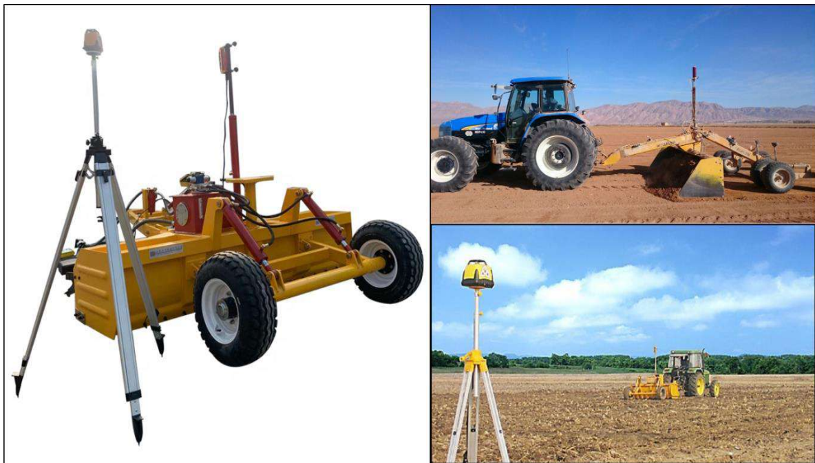
الشكل (3 – 2) تسوية الاراضي الزراعية بواسطة الجهاز الليزري
