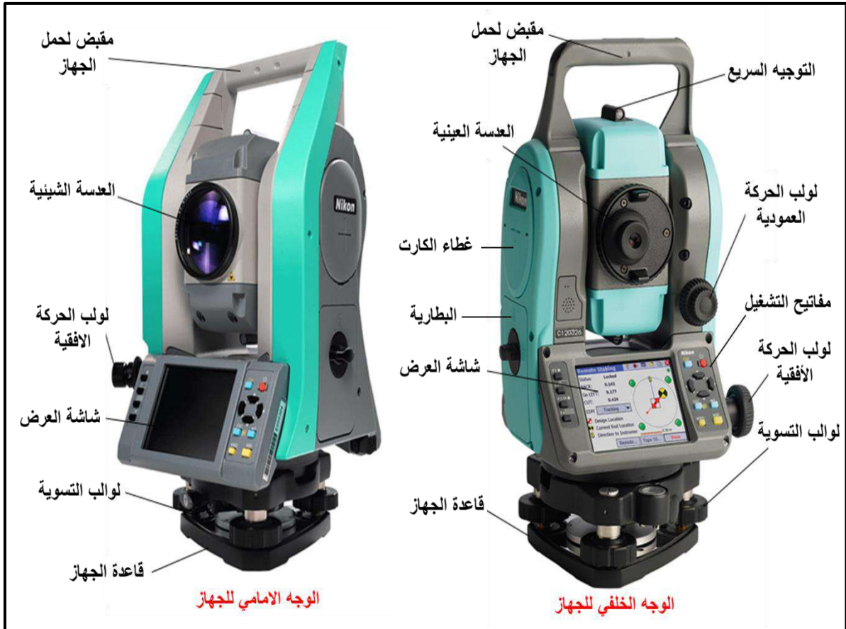
الشكل (1 - 28) اجزاء جهاز المحطة المتكاملة
