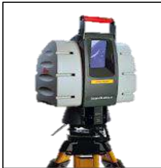
الشكل (1 - 14) جهاز المحطة المتكاملة بالمسح الليزري
