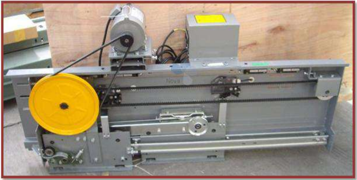
شكل 4 - 23 المحركات المستعملة لفتح وغلق باب عربة المصاعد
