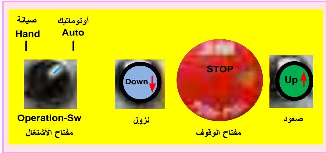
شكل 3 - 6 الأجزاء الرئيسية لصندوق الصيانة
