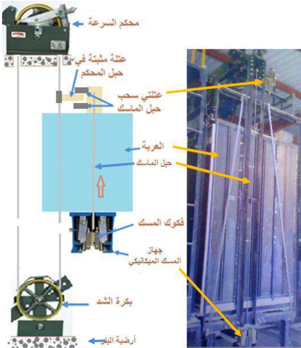
شكل 23-1 عمل جهاز الأمان الميكانيكي
