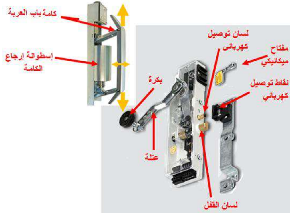
شكل 1- 21 القفل الميكانيكي لـ (Swing door)
