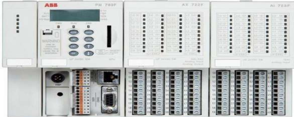
شكل 5-26 أجهزة (PLC) نوع الهجينة
