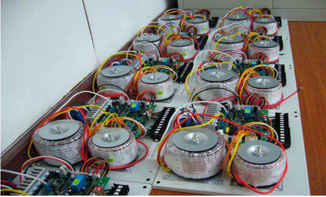
شكل 3- 50 لوحة مجهز القدرة الأضراري للمصعد الكهربائي بقدرات مختلفة
