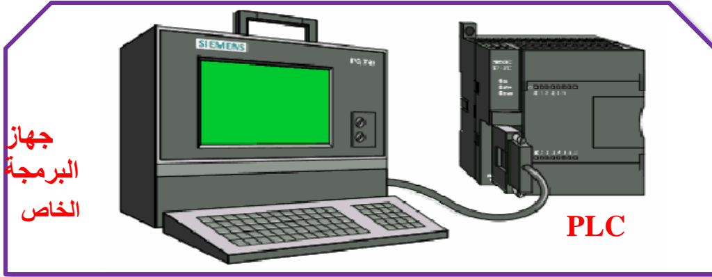
شكل 19-5 برمجة (PLC) بواسطة جهاز البرمجة الخاص
