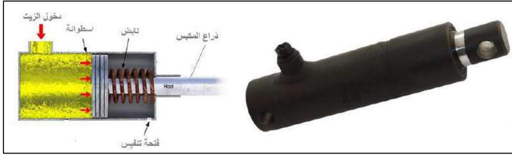
شكل 4-10: مقطع في أسطوانة هيدروليكية أحادية الفعل.
