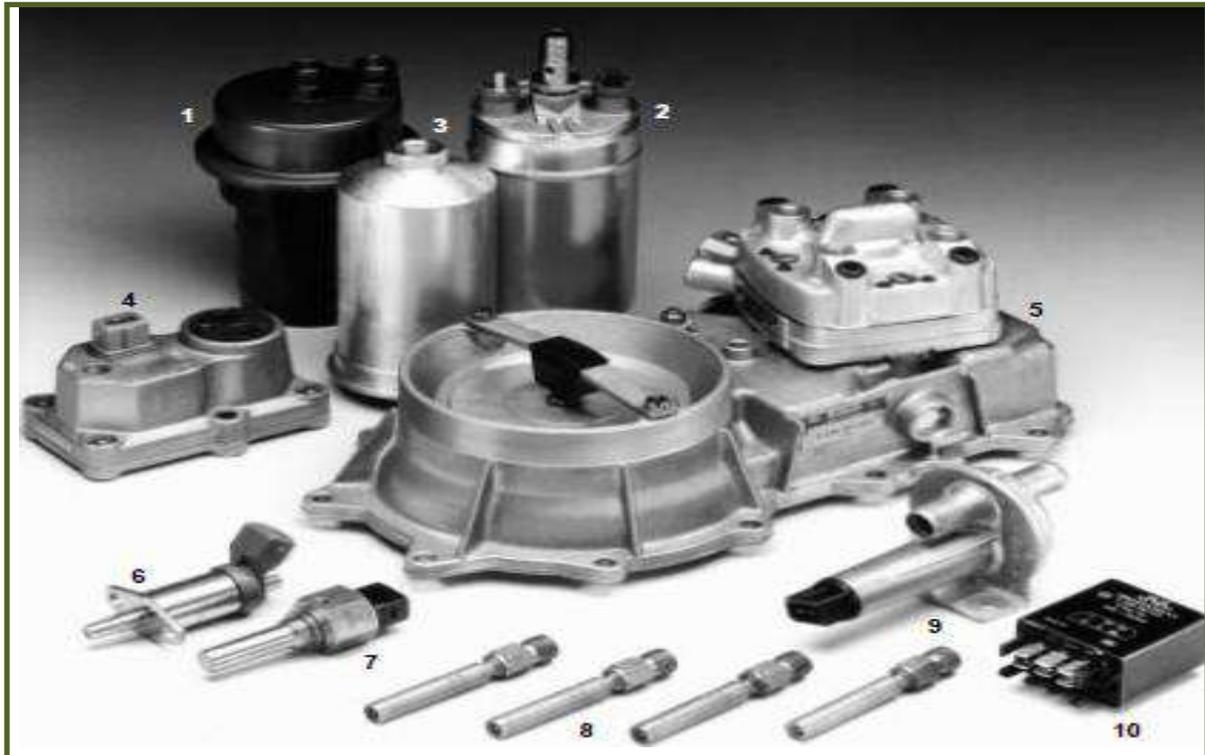
1- مراكم الوقود 2- مضخة الوقود 3- مرشح الوقود 4- منظم الحرارة 5- وحدة الخلط مع حساس تدفق الهواء وموزع الوقود 6- صمام البدء البارد 7- مفتاح مؤقت حراري 8- صمامات الحقن 9- أجهزة هواء مساعدة 10- مرحل.
