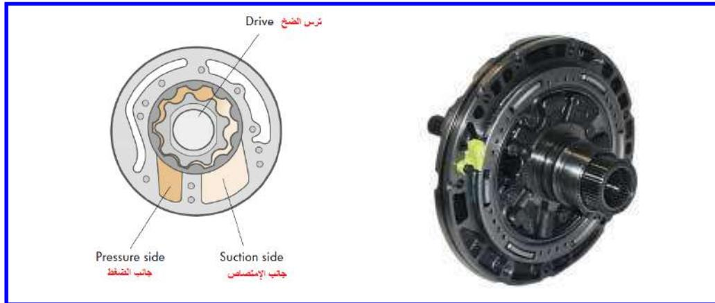
تقوم المضخة بامتصاص الزيت من حوض من خلال مصفي الزيت. وتقوم المضخة بتوليد الضغط اللازم لعمل ازدواج متعدد الأقراص (multi-disc coupling) وكبح متعدد الأقراص (multi disk brakes)، كما تقوم بعملية تدوير الزيت وتبريده.
