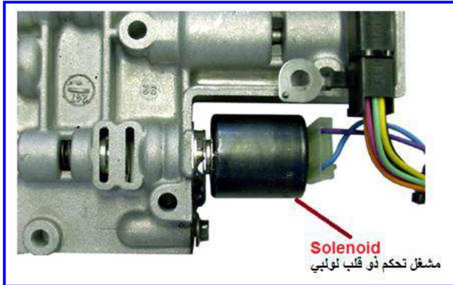
الشكل (11-2) مشغل التحكم بالضغط الهيدروليكي
