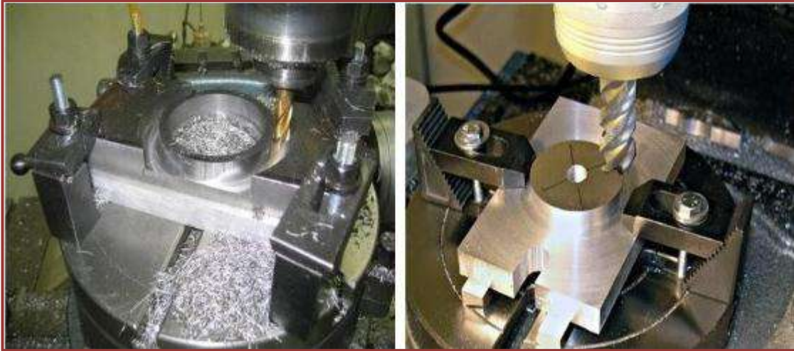
الشكل (28-2) طريقة عمل الصينية الدائرية.
