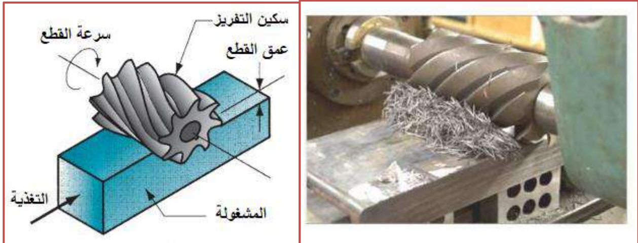
الشكل (19-1) التفريز المحيطي.
