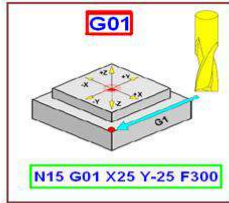
الشكل (3-12) كيفية الانتقال بحركة قطع خطية باستعمال الدالة G01 .
