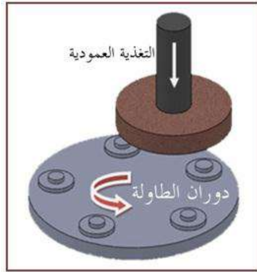
الشكل ( 4 - 20 ) : التجليخ الجبهي بالطاولة الدوارة.
