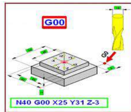
الشكل ( 3-11 ) كيفية الانتقال السريع باستعمال الدالة G00 .
