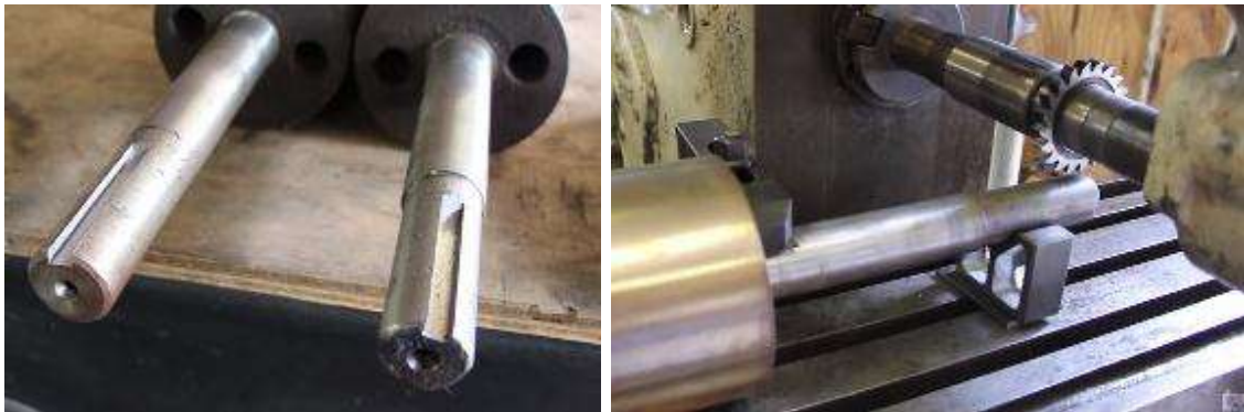
الشكل (2-21) تشغيل الأخاديد النصف مفتوحة.
