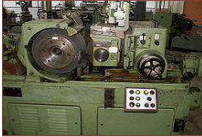
الشكل (4 - 11): ماكينة التجليخ اللامركزي
