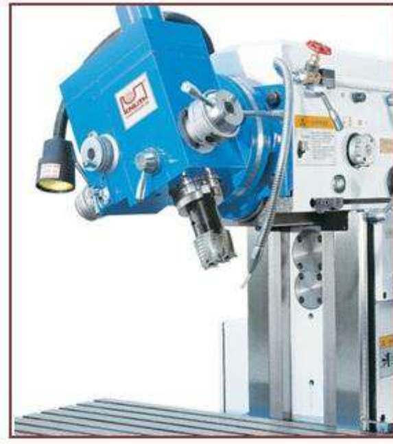
الشكل (8-1) رأس حامل عمود سكين التفريز.
