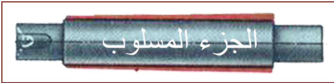
الشكل (2-41) العمود المستعمل لتثبيت المشغولات.
