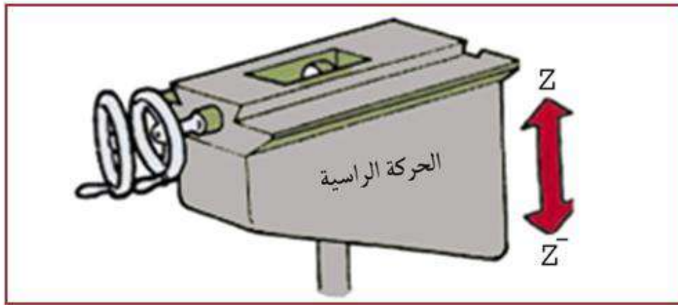
الشكل (2-1) الحركات الرئيسية لماكينة التفريز.
