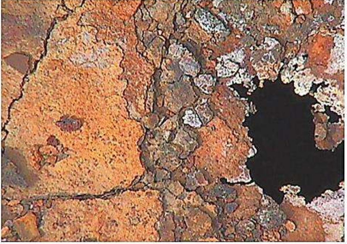
شكل (2-5) التآكل المنتظم لأنبوب معدني
