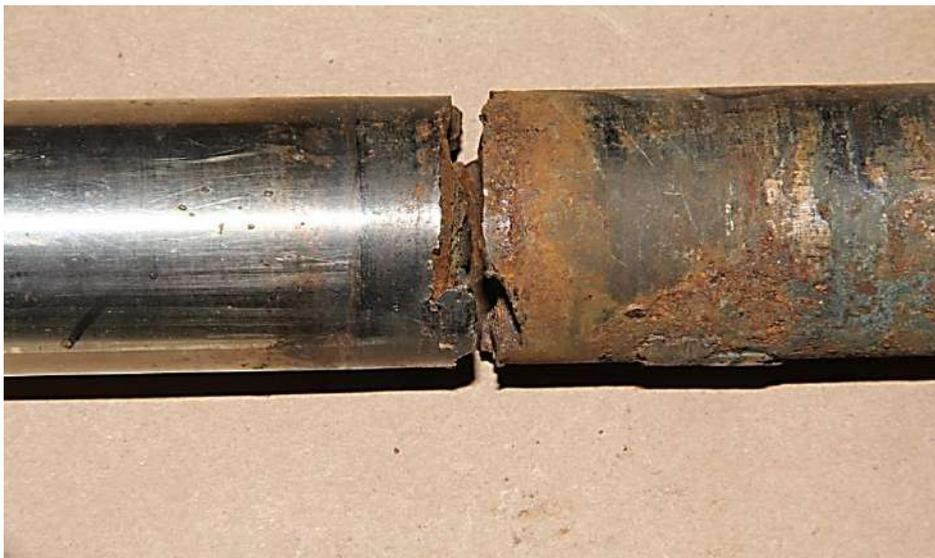
شكل (8-5) التآكل الكلي لجزء دوار
