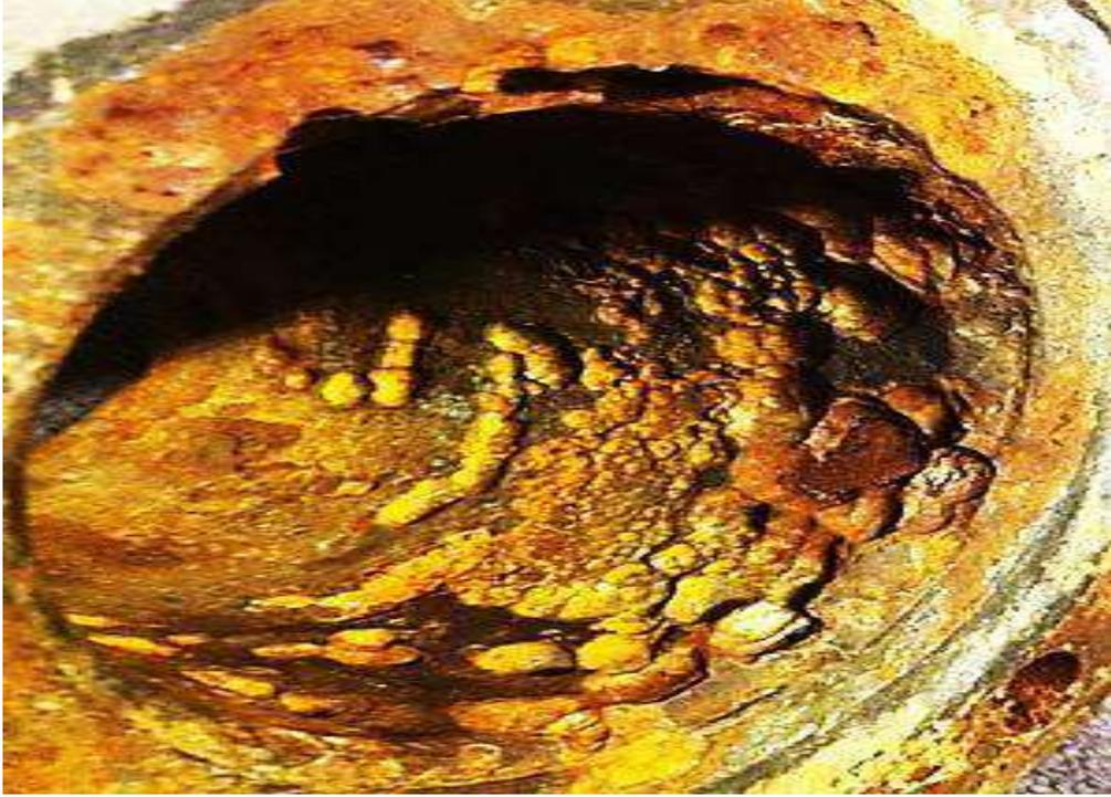
شكل (10-5) التآكل الميكروبي داخل أنبوب
