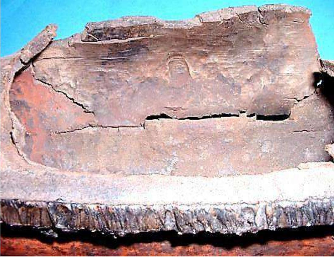
شكل (7-5) جزء من انبوب متكسر بسبب التآكل بالهيدروجين
