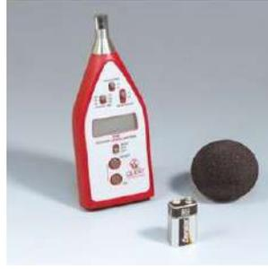
الشكل (6-21) جهاز قياس شدة الصوت
