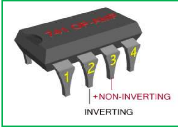
شكل 47-1 يوضح شكل مكبر العمليات وترقيم الأرجل
