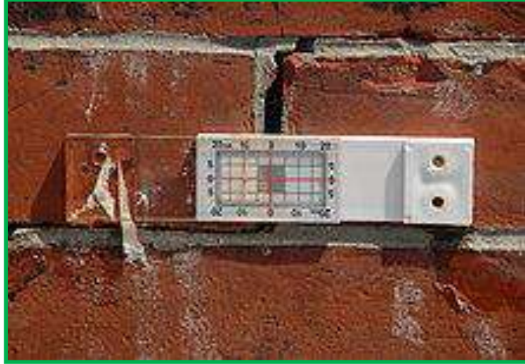
الشكل 19-1 يبين متحسس قياس الانفعال
