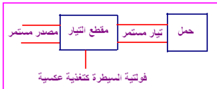
( chopper الشكل (3-26) المخطط الكتلي لمقطع التيار )
