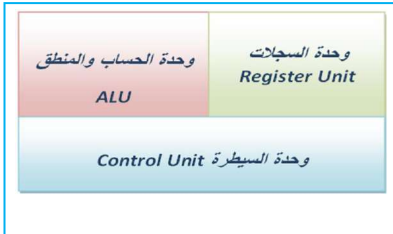
الشكل (2-2) المكونات الداخلية للمعالج الدقيق
