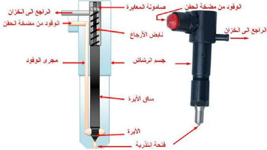
شكل ( 6 - 26 ) يوضح الرشاش وأجزائه
