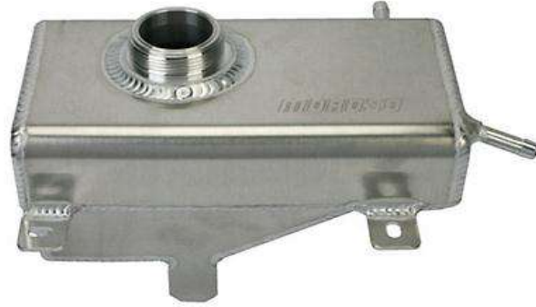
شكل ( 6 - 38 ) يوضح خزان الماء في منظومة التبريد
