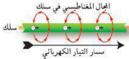
شكل ( 1 - 7 ) يوضح نشوء مجال مغناطيسي في سلك يسرى فيه تيار كهربائي
