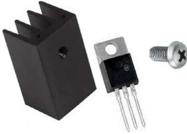
شكل ( 7 - 2 ) يوضح تثبيت الثايرستور على مخفض الحرارة
