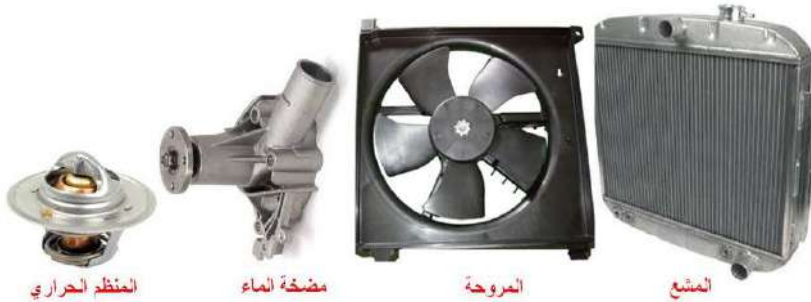
شكل ( 6 – 37 ) يوضح مكونات منظومة التبريد في محركات الاحتراق الداخلي
