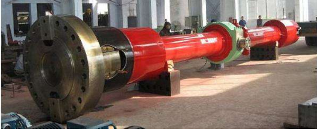
شكل ( 6 - 44 ) يوضح الجزء الناقل للحركة بين التوربين والمولد الكهربائي في المحطات الحرارية
