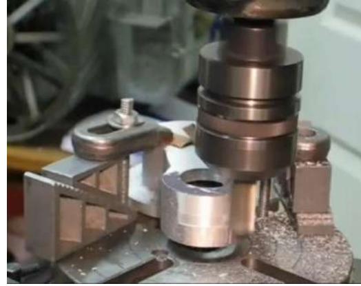
الشكل (5-16) تفريز سطح المسبوكة الشكل (5-17) تجليخ المسبوكة على ماكينة التجليخ
