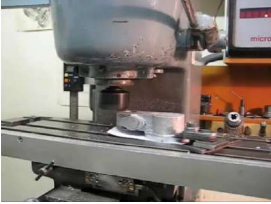
الشكل (5-16) تفريز سطح المسبوكة الشكل (5-17) تجليخ المسبوكة على ماكينة التجليخ
