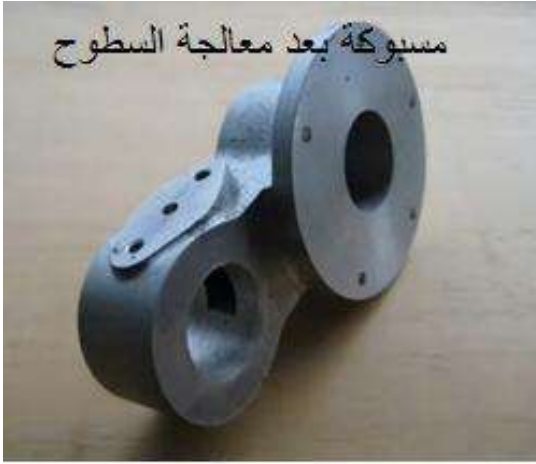
الشكل (5-18) المسبوكة قبل وبعد أنجاز السطوح
