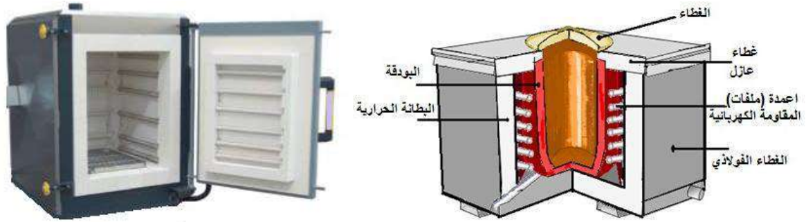
شكل (1-26) يوضح الأجزاء الرئيسية لفرن مقاومة كهربائية
