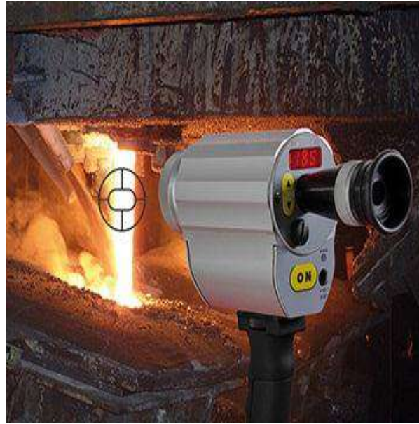
شكل (2-11) صور للمقياس الإشعاعي لقياس درجة الحرارة أثناء تفرغ منصهر المعدن
