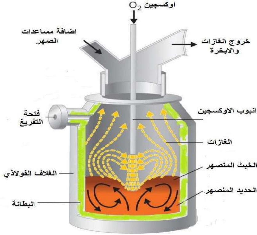
شكل(1-10) صورة توضيحية لفرن الأوكسجين القاعدي
