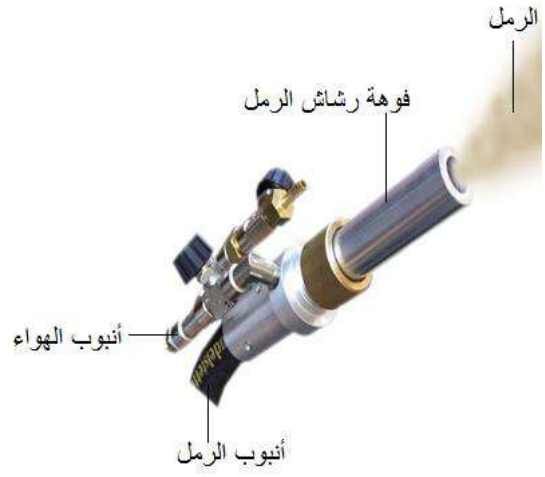
الشكل (5-8) مسدس رشاش الرمل والرشاش المعدني
