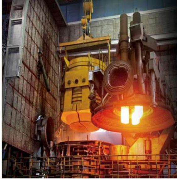
شكل ( 22-1 ) صورة فرن قوس كهربائي اثناء رفع السقف
