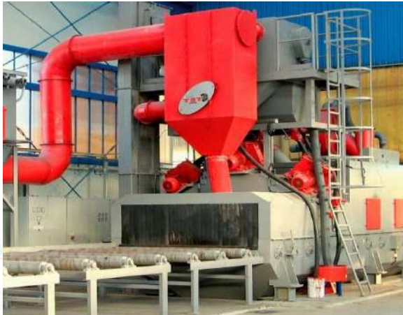
الشكل (5-11) ماكينات تنظيف للمسبوكات الكبيرة
