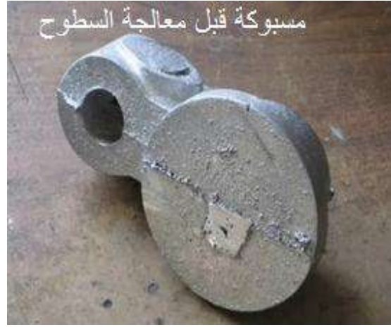
الشكل (5-18) المسبوكة قبل وبعد أنجاز السطوح
