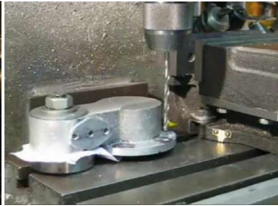
الشكل (5-14) عمل عدة ثقوب في المسبوكة
