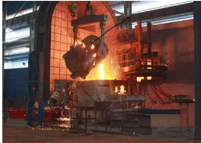
شكل (24-1) فرن قوس كهربائي أثناء تفريغ مواد الشحنة المنصهرة داخل الفرن
