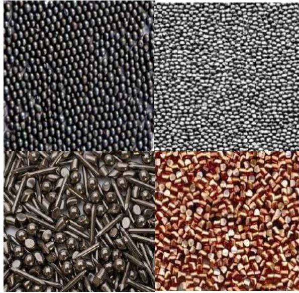
الشكل (4-5) المواد المعدنية المستخدمة بطريقة القذف
