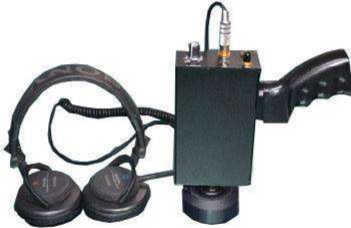
الشكل (5-21) جهاز إلكتروني للفحص بالصوت والطرق
