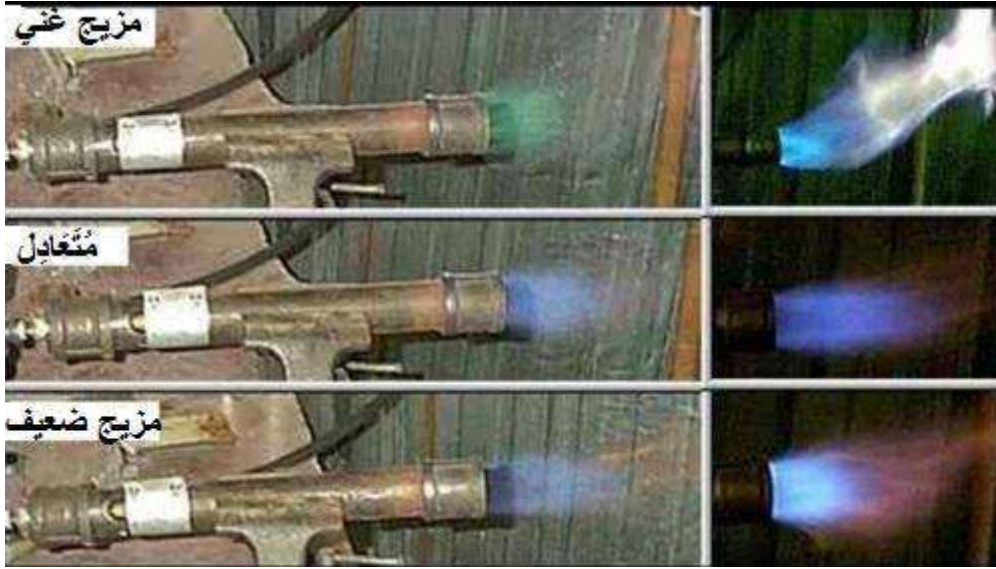
الشكل (7-1) صورة محراق يعمل بالغاز
