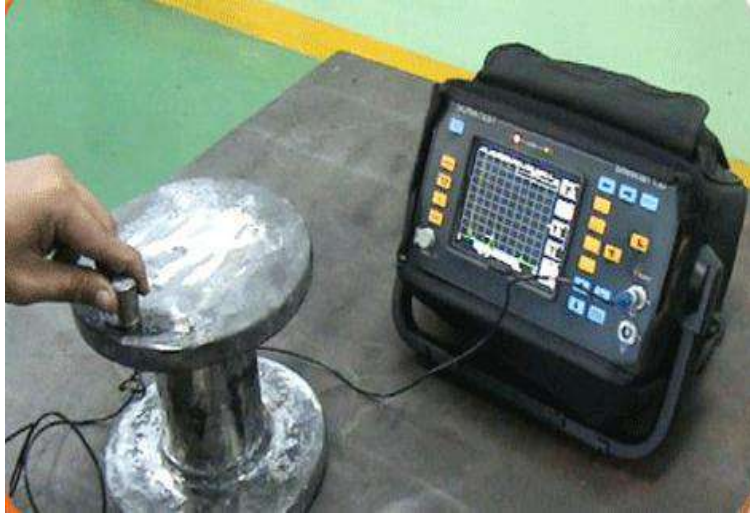
الشكل (5-25) جهاز فحص بالذبذبات فوق الصوتية
