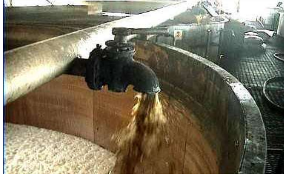
شكل ( 23 ) أحواض تجميع عصير القصب بعد إستخلاصه
