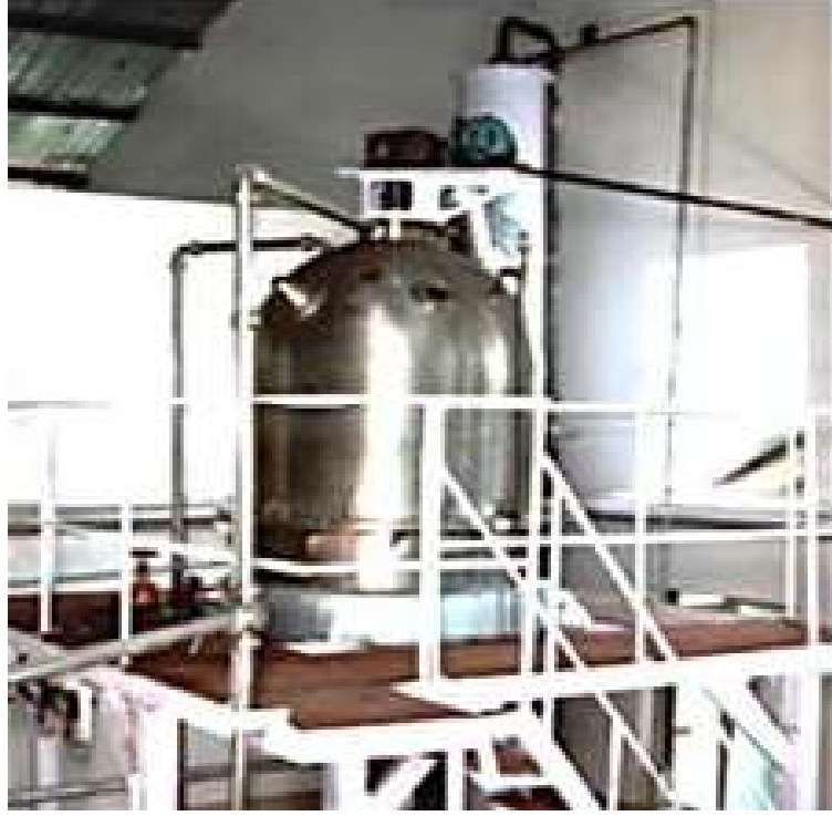
شكل ( 43 ) جهاز ال-Evaporator المستخدم في تركيز العصائر والمنجز تحت التفريغ
