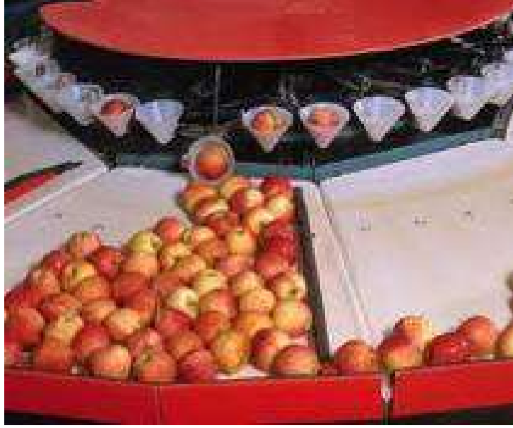
شكل ( 16 ) آلات ذات فتحات مقفلة يتحكم في مقدارها لتعطي أوزان معينة
