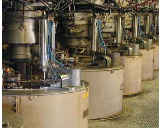
شكل (25) أجهزة الطرد المركزي المستخدمة لفصل بلورات السكر
