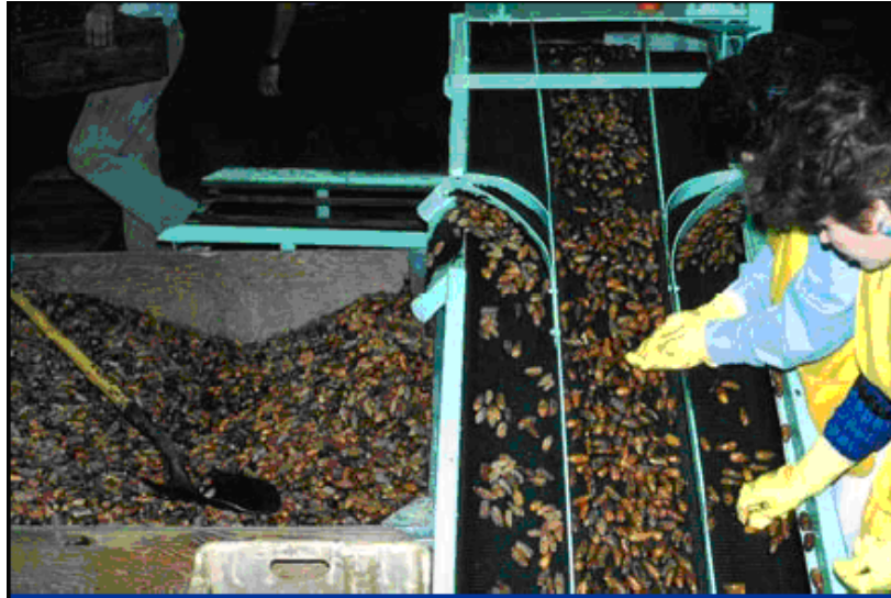
شكل (30) طريقة فحص التمور للتأكد من مطابقتها للمواصفات
