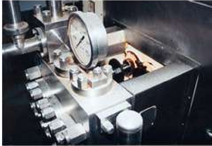
شكل ( 64 ) جهاز التجنيس ويتضح فيه وجود مؤشر الضغط المسلط
