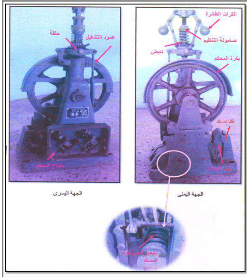
شكل 1 - 32 محكم السرعة ذو الكرات الطائرة
