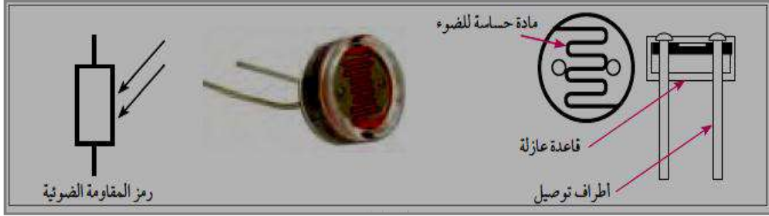
شكل 5-20 شكل المقاومة الضوئية
