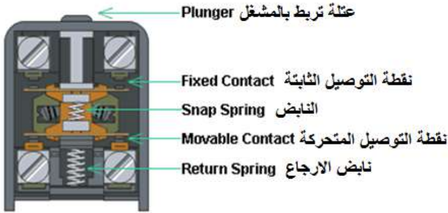
شكل 5-15 أجزاء وعمل صندوق المفاتيح
