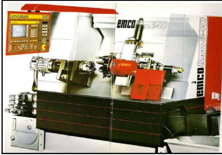
الشكل (7-8) ماكينة ذات الفرش المائل
