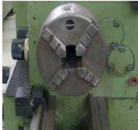
الشكل (26-2) الظرف رباعي الفكوك (اللقم).
