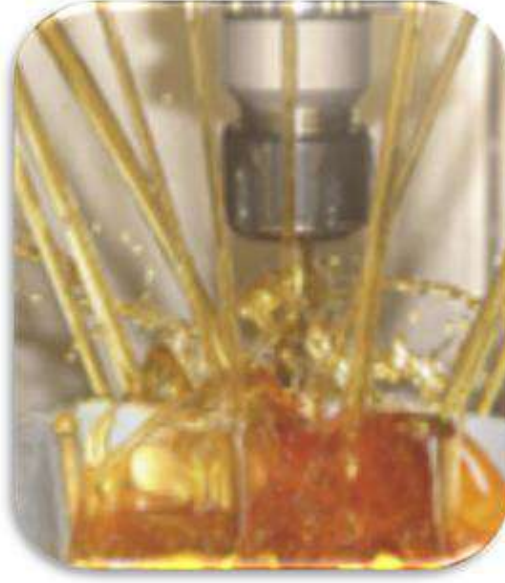
الشكل (4-7) يوضح استعمال الزيت المعدني الثقيل
