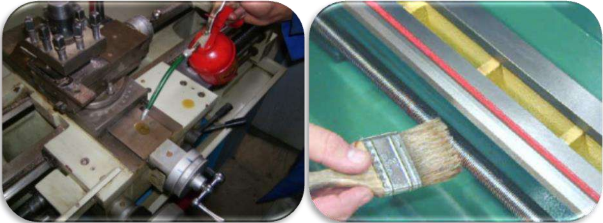
الشكل(7-12) تزييت أجزاء متحركة في المخرطة.
