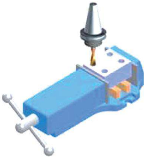
الشكل ( ) تثبيت المشغولات الصغيرة على الطاولة
