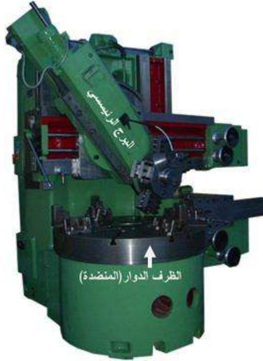
الشكل (19-1) ماكينة الخراطة ذات البرج العمودي.
