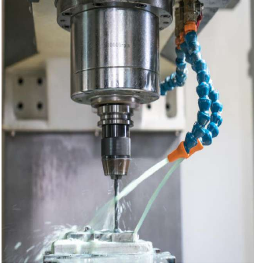
الشكل (7-10) يوضح عملية تدفق سائل التبريد على قطعة العمل
