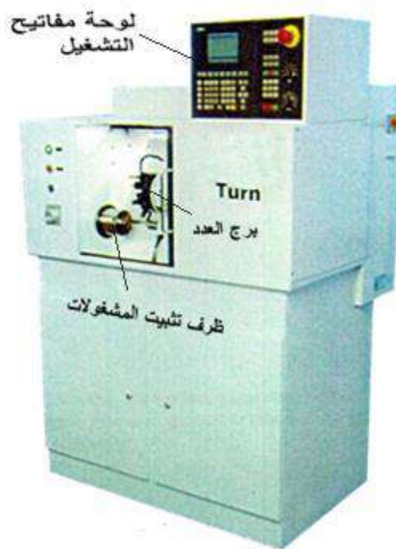
الشكل(1-23) ماكينة خراطة CNC .
