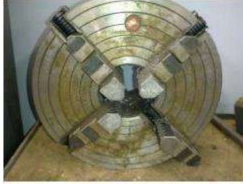
الشكل (27-2) الظرف الرباعي الفكوك ذو اللقم المستقلة.
