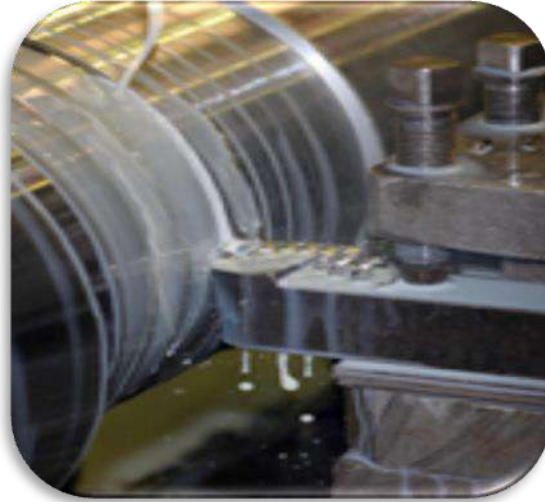
الشكل (5-7) يوضح استعمال المستحلب للتبريد والتنظيف.
