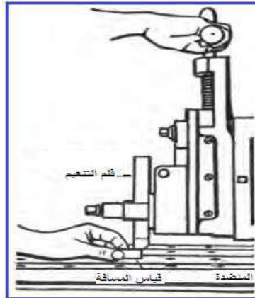
الشكل (5-16) ضبط المسافة بين المشغولة والحد القاطع
