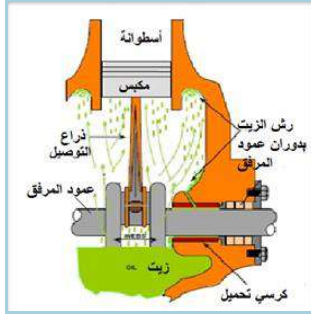
الشكل (7- 24) يوضح طريقة التزييت بالرش.
