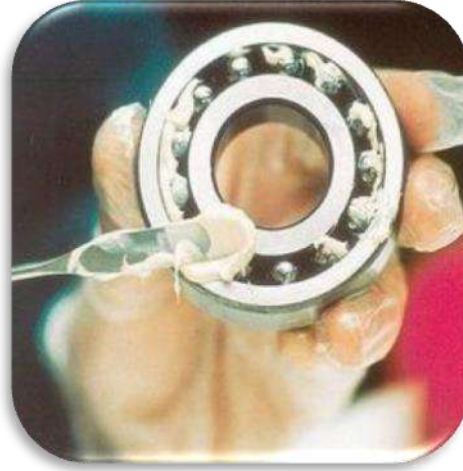
الشكل (7-17) تزييت كرسي التحميل.
