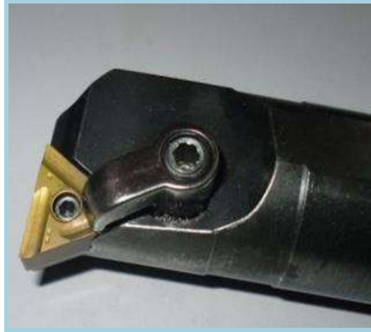
الشكل(2-16) طريقة استعمال الفقل لتثبيت اللقم .
