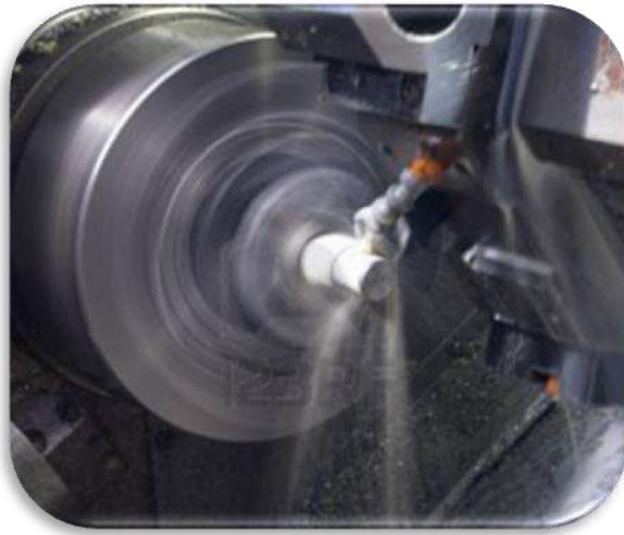
الشكل (7-8) توجيه شعاع سائل التبريد وتثبيته أثناء الخراطة.
