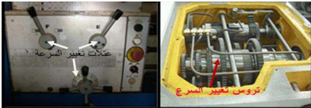
الشكل (15-1) صندوق التروس وجدول السرعة وعتلات التغيير.
