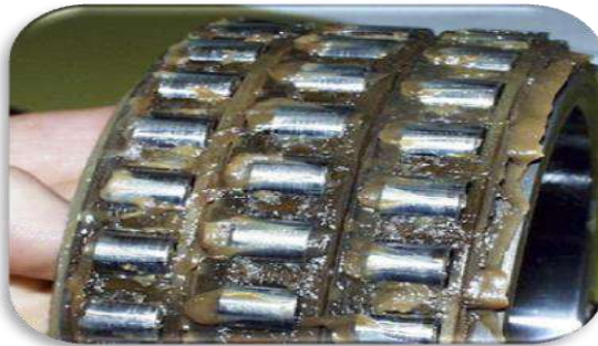
الشكل (7-16) تشحيم كراسي تحميل مخروطي.
