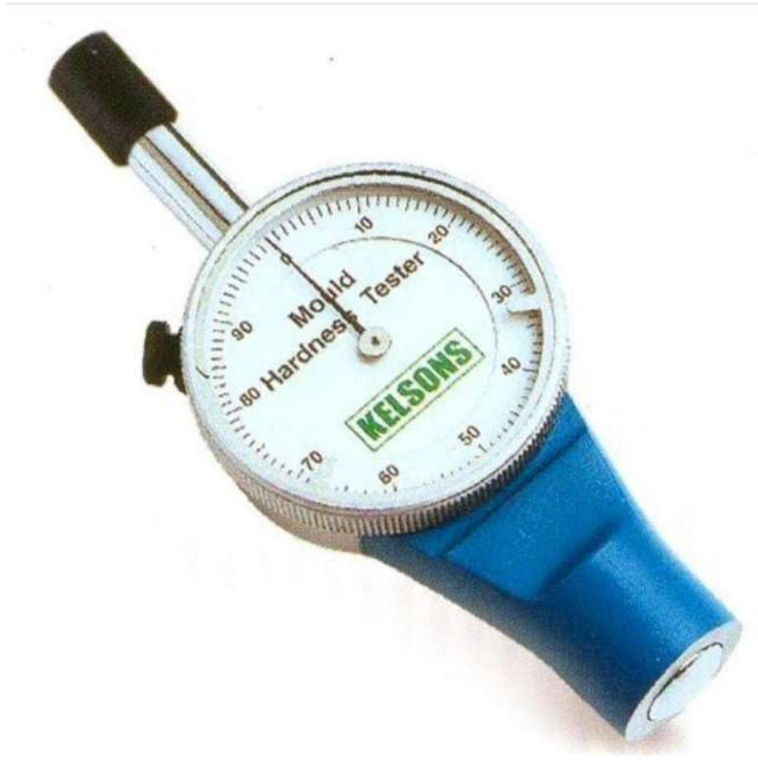
الشكل ( 5 - 12 ) جهاز اختبار صلادة القالب الرملي
