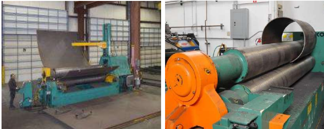
الشكل (2-5) عمليات درفلة لإنتاج شكل اسطواني
