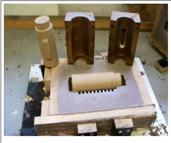
الشكل ( 6 – 23 ) صندوق اللب الشكل ( 6 – 24 ) يوضح طريقة وضع اللب في القالب الرملي
