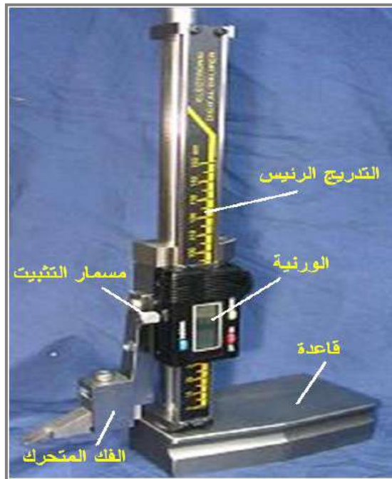
الشكل (4-8) قدمة قياس الارتفاع
