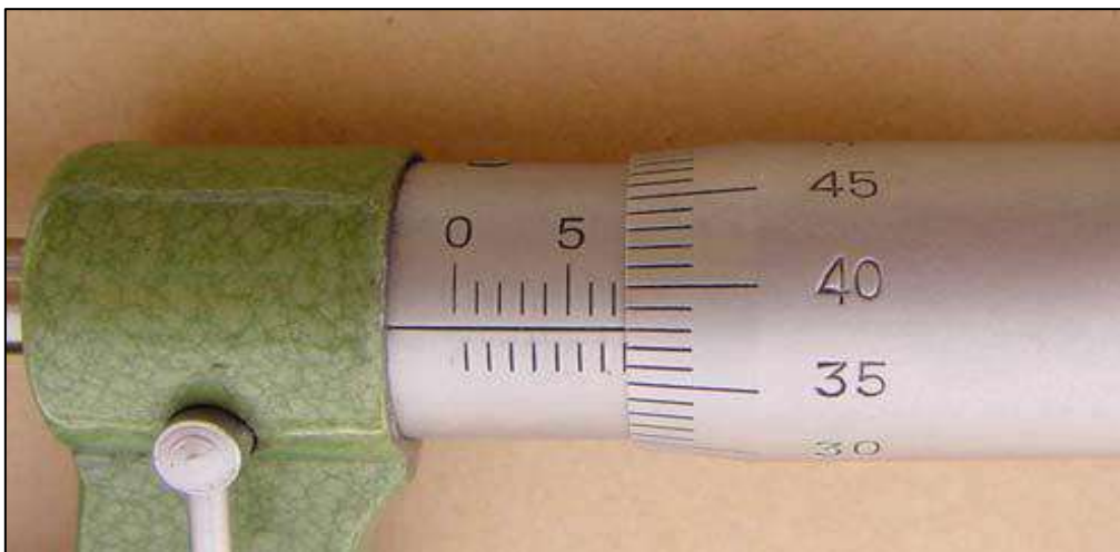
الشكل ( 4-23 ) قراءة قياس مايكروميتر الأبعاد الخارجية
