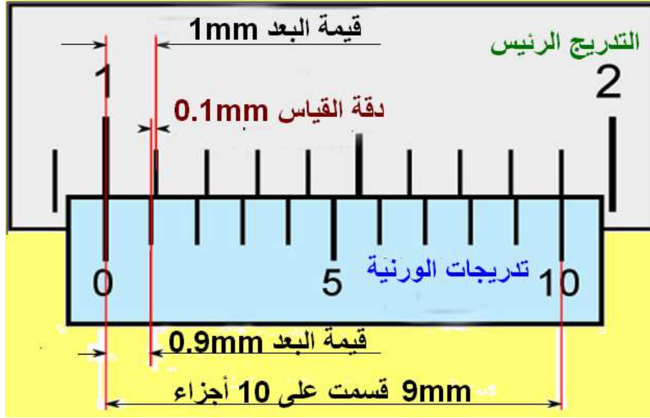
الشكل ( 4-12 ) القدمة ذات الدقة (0.1mm)
