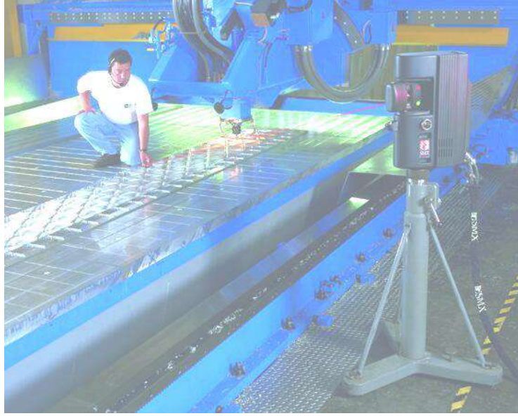
الشكل 6-14 : عملية الترصيف باستعمال المعقب الليزري.
