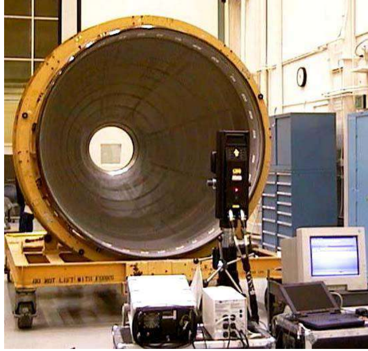
الشكل 6-13 : استعمال المعقب الليزري في المعاينة والفحص.
