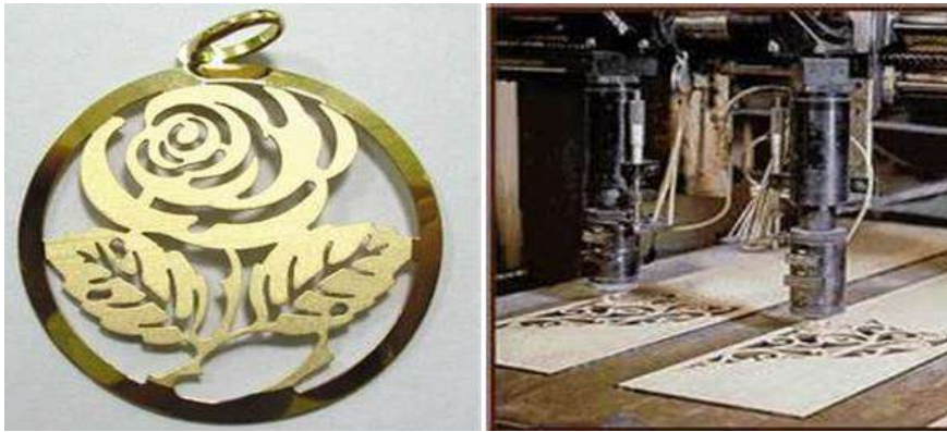
الشكل 3-16 : دقة عملية القطع بالليزر.
