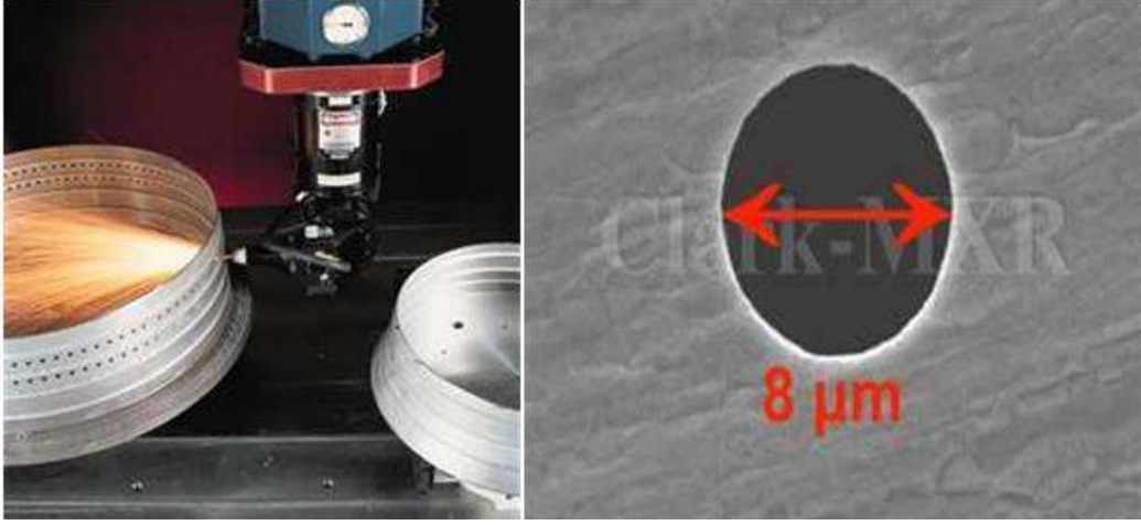
الشكل 3-15 : عمل الثقوب الدقيقة باستعمال الليزر.
