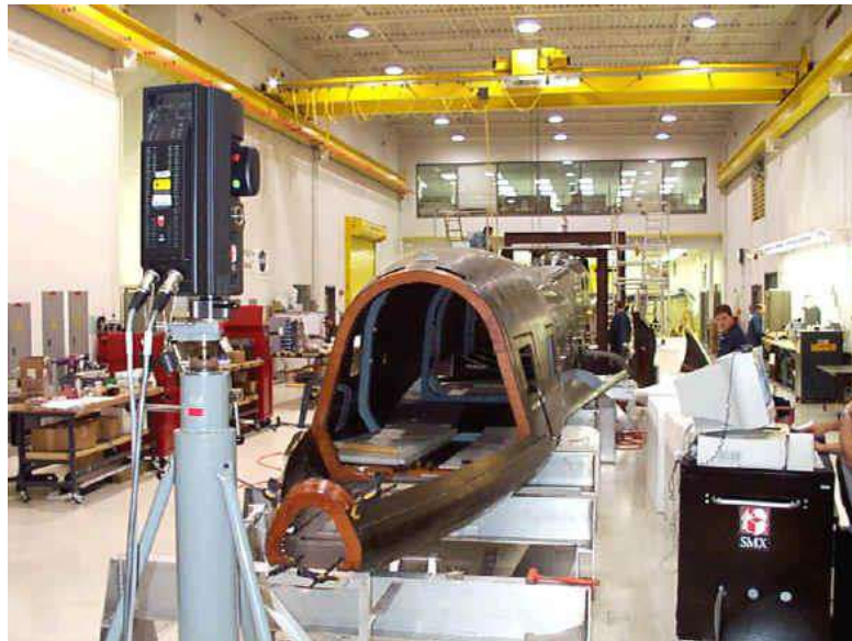
الشكل 6-12 : استعمال تعقب الليزر في الهندسة العكسية.
