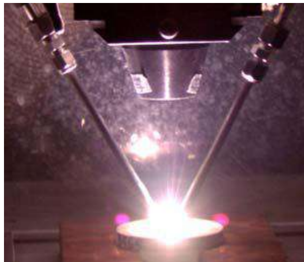
الشكل 3-14 : منظومة استعمال الغازات المساعدة مع الليزر.
