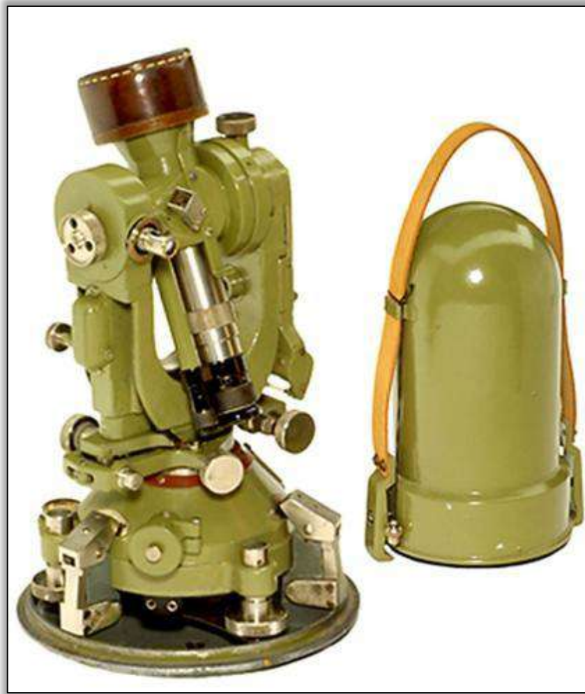
الشكل (5-11) جهاز ثيودولايت نوع T2 الشهير من شركة Wild السويسرية.
