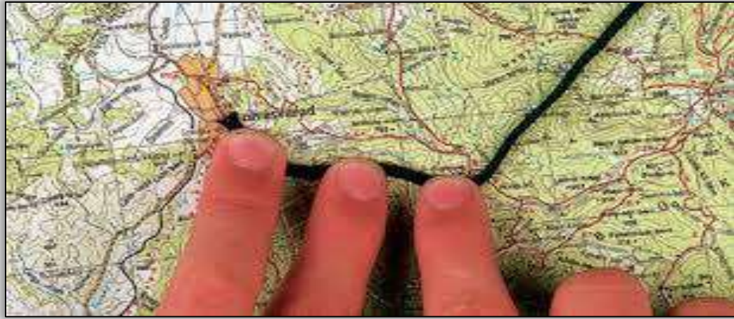
الشكل (4-11) يوضح قياس مسافة منحنية من الخريطة باستخدام الخيط.
