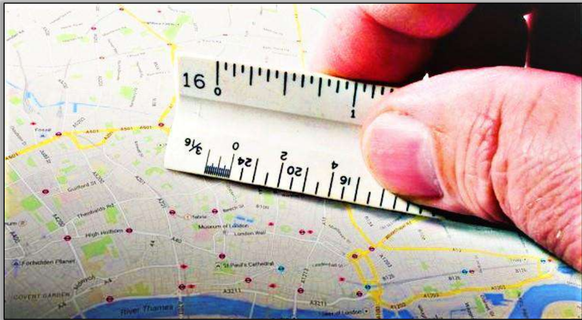
الشكل (9-4) يمثل قياس المسافة المستقيمة من الخريطة باستخدام المسطرة.
