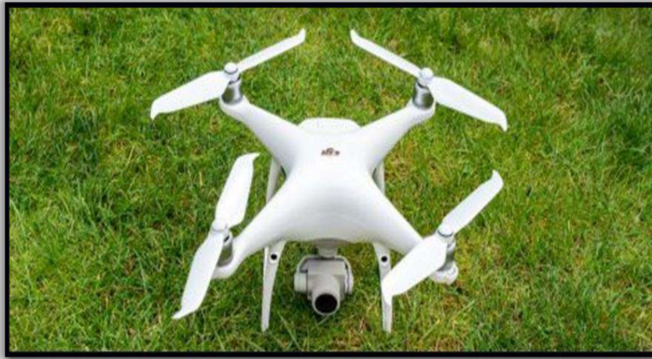
الشكل (2-2) طائرة مسيرة تستخدم في المسح التصويري في مراقبة المنشآت.
