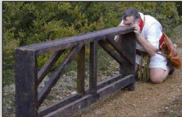
الشكل (2-1) جهاز الكوروبيتس (chorobates).
