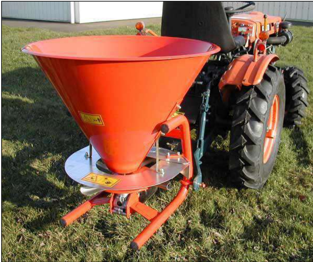
الشكل 3-31 : آلة نثر السماد الكيماوي ذات الطرد المركزي.
