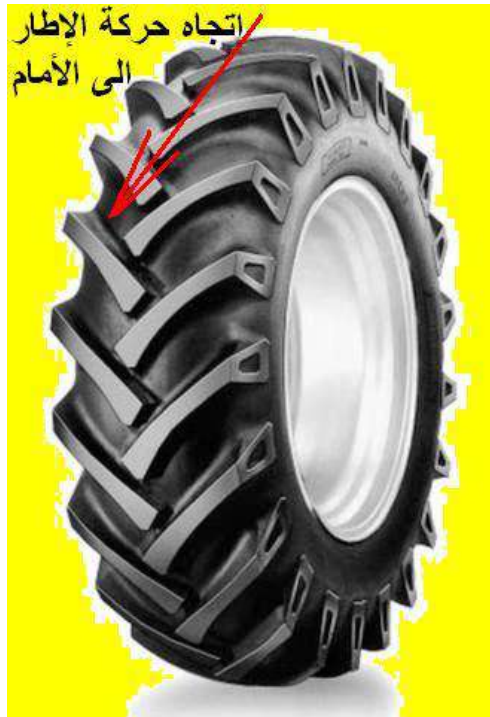
الشكل ٥-٣٧ : اتجاه أخاديد إطار السحب.
