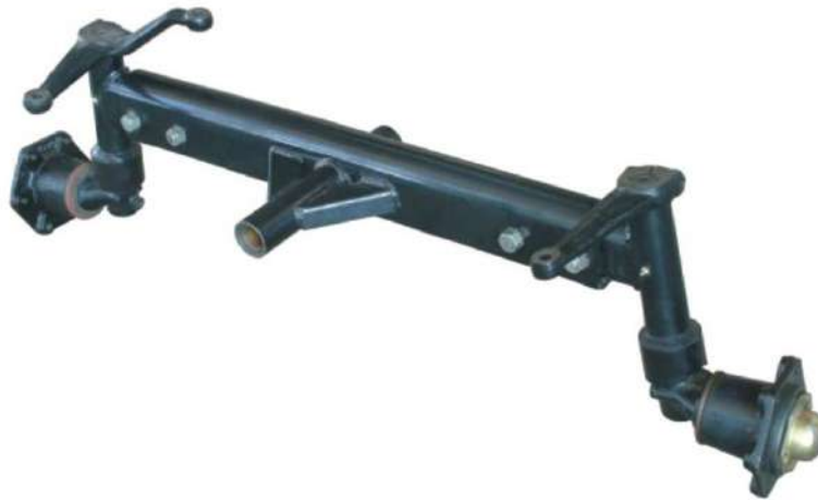
الشكل 4-11 : المحور الأمامي لساحبة ثنائية الدفع.
