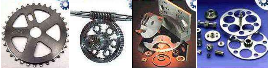
العجلة المسننة التروس غير المطوية تروس السايكلود تروس الدرجة الرفيعة الشكل 2-28 : أنواع أخرى للتروس.
