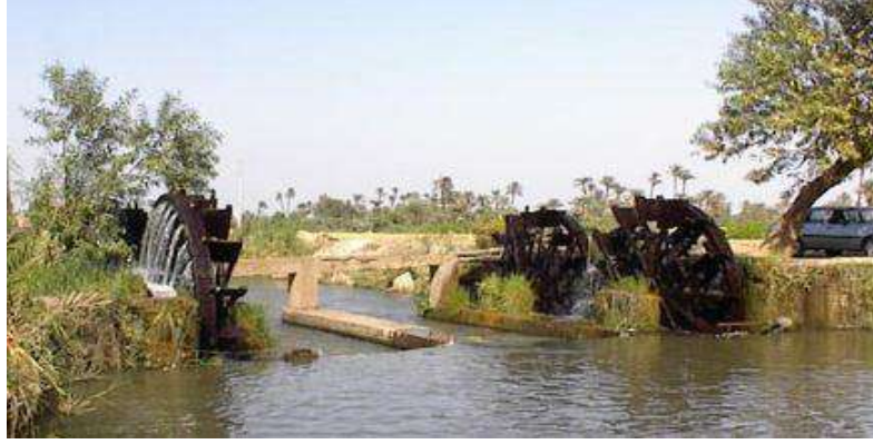
الشكل 3-12 : رفع مياه السقي عن طريق الناعور.
