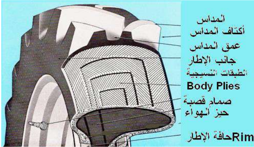
الشكل ٥-٣٣ : مقطع في الإطار القائد للساحة الزراعية.
