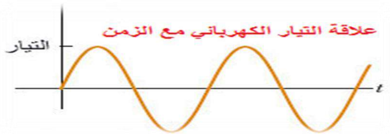
شكل 3-7 : التيار الكهربائي الناتج عن المولد ويسمى التيار المتردد.
