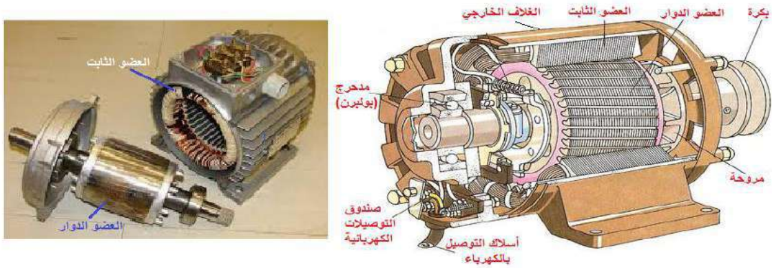
شكل 7- 12: المكونات الرئيسية للمحرك الكهربائي
