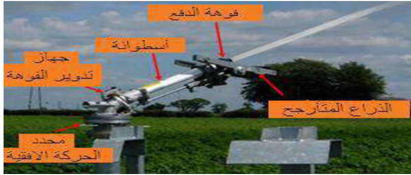
شكل 4 - 9 مدفع ماء ذو الذراع المتأرجح
