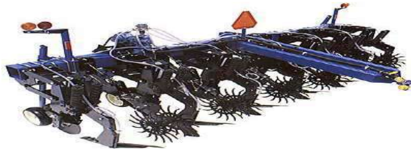
الشكل 5 - 10 طريقة عمل العازقة الدوارة في مجاميع منفصلة.
