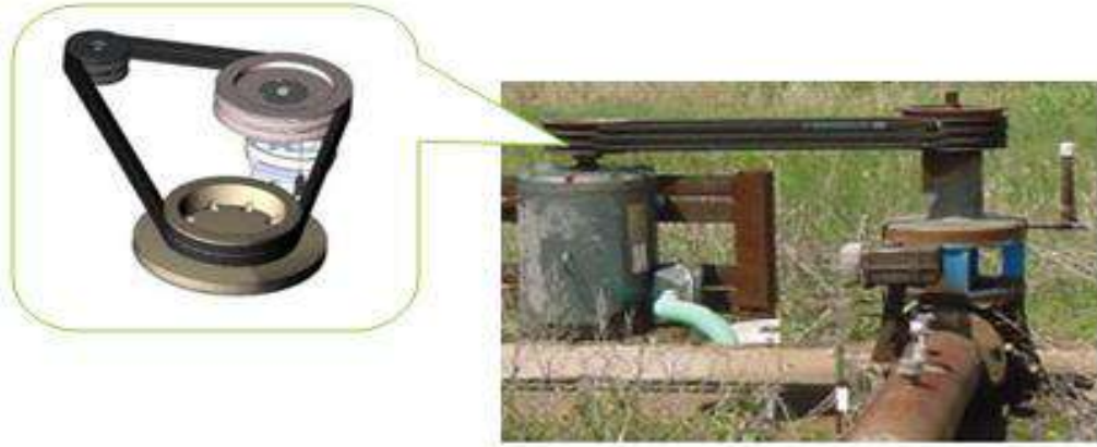
شكل 4 - 31 نقل الحركة بواسطة السيور
