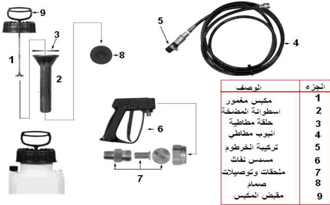
الشكل 5 - 14 : أجزاء آلة الرش الظهرية ذات المضخة المتصلة.
