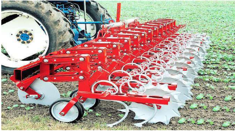
الشكل 4-5 : العازقة المركبة ذات المدى الواسع.
