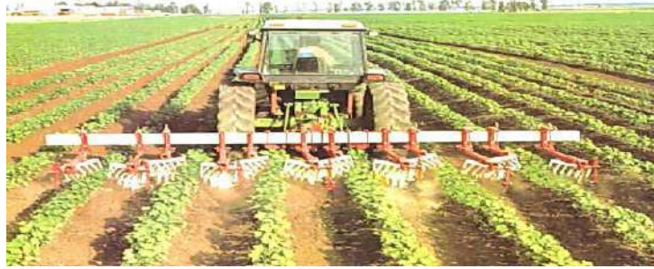
الشكل 5 - 9 العازقة ذات الاسلحة الدائرية المدببة في أثناء العمل.
