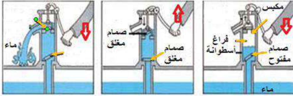
شكل 4 - 23 لاحظ حركة الذراع والصمامات في المضخة الترددية
