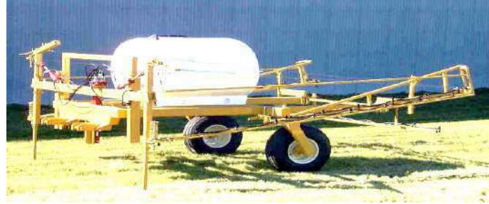
الشكل 5 - 19 البخاخات بنظام الطي الهيدروليكي أو اليدوي الآلي.
