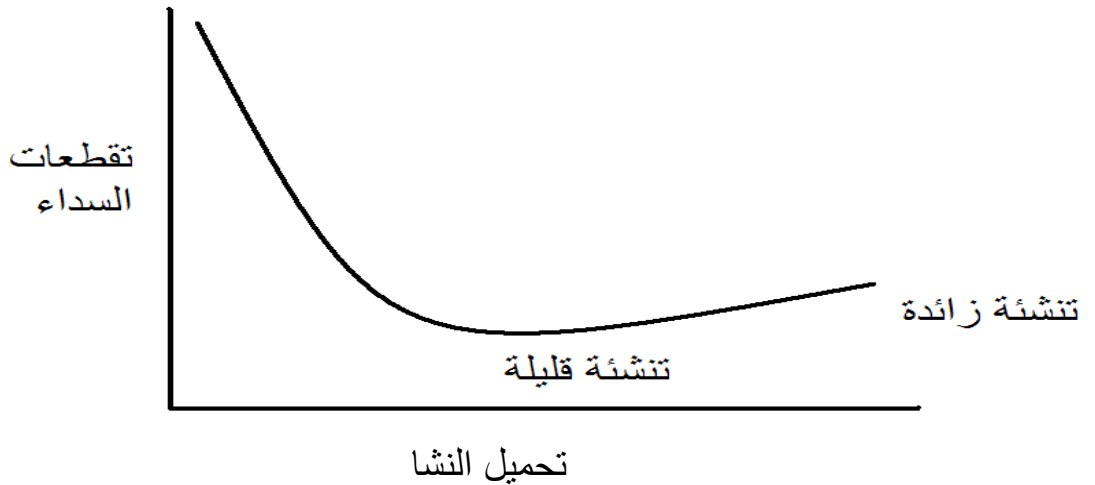
الشكل رقم ( 11 ) يبين العلاقة بين تحميل النشا وتقاطعات السداء
