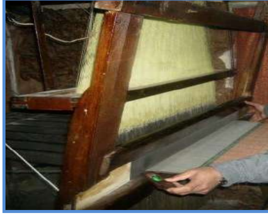
الشكل رقم ( 16-1 ) يبين عملية قذف المكوك يدويا
