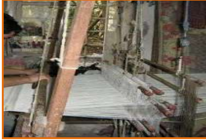
الشكل رقم ( 17-1 ) يبين عملية ضم خيط اللحمة يدويا
