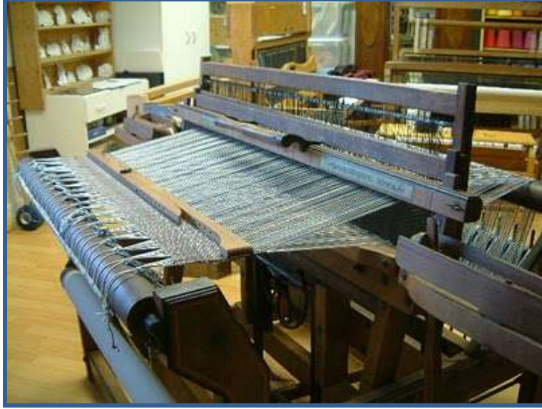
الشكل رقم ( 1 - 1 ) يبين ماكينة نسيج يدوية ( النول اليدوي )
