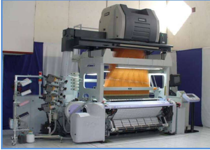
الشكل رقم ( 28-1 ) يبين ماكينة الجاكارد
