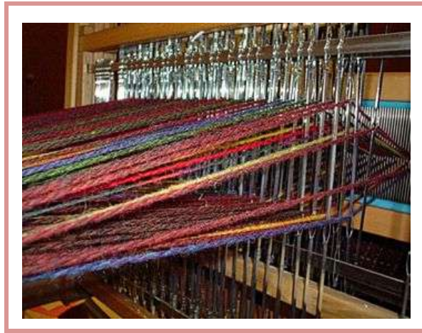
الشكل رقم ( 15-1 ) يبين عملية فتح النفس
