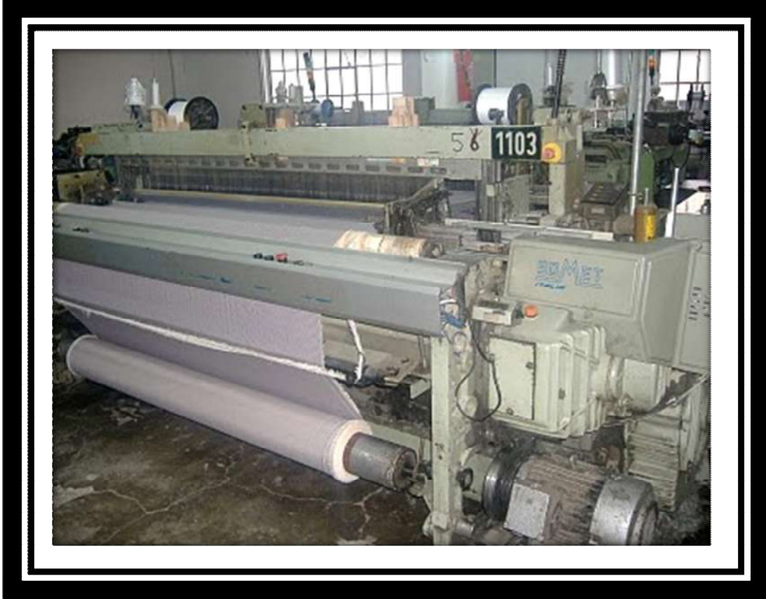
الشكل رقم ( 4-1 ) يبين ماكينة نسيج اللامكوكية ( الأنوال اللامكوكية )
