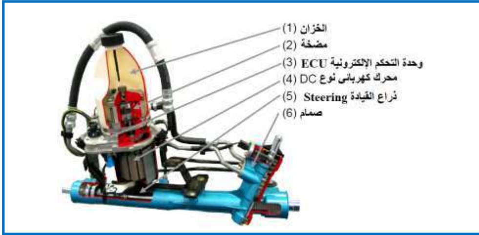
الشكل (8.3) منظومة توجيه قدرة (power steering)
