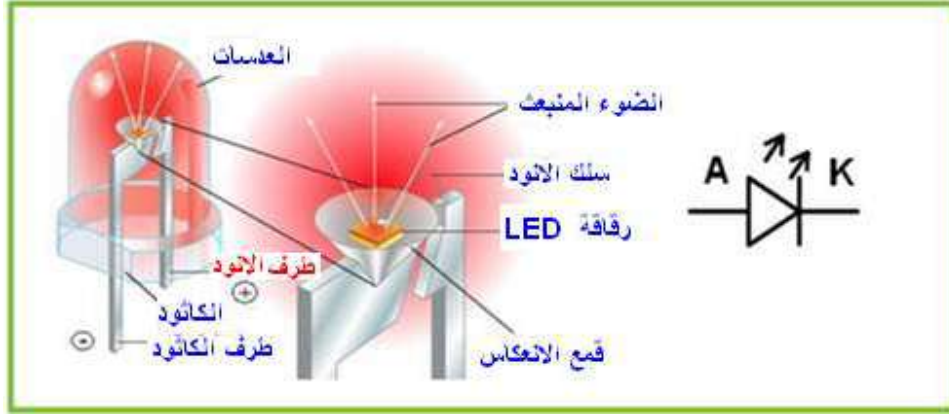
الشكل ( 2 - 2 ) تركيب ورمز ثنائي الانبعاث الضوئي
