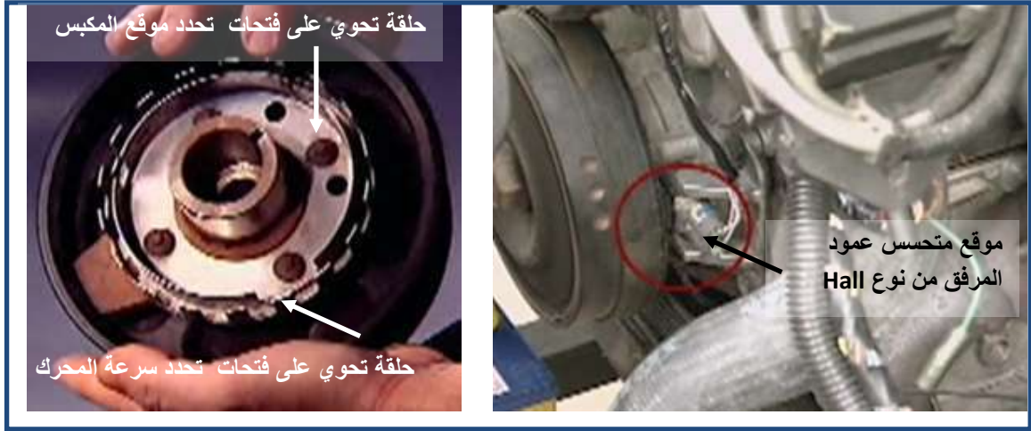
الشكل (3-18) متحسس عمود المرفق من النوع هول
