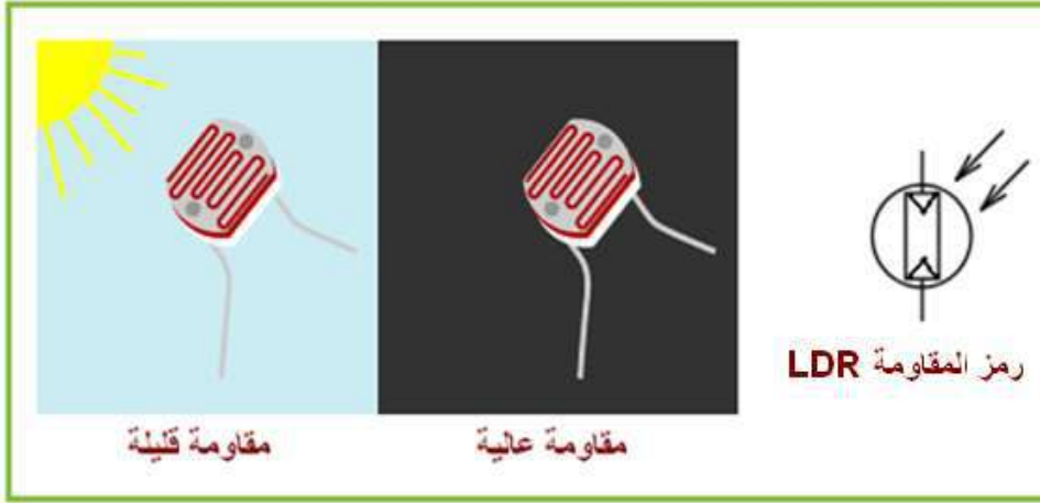
الشكل ( 2 - 5 ) شكل المقاومة LDR ورمزها
