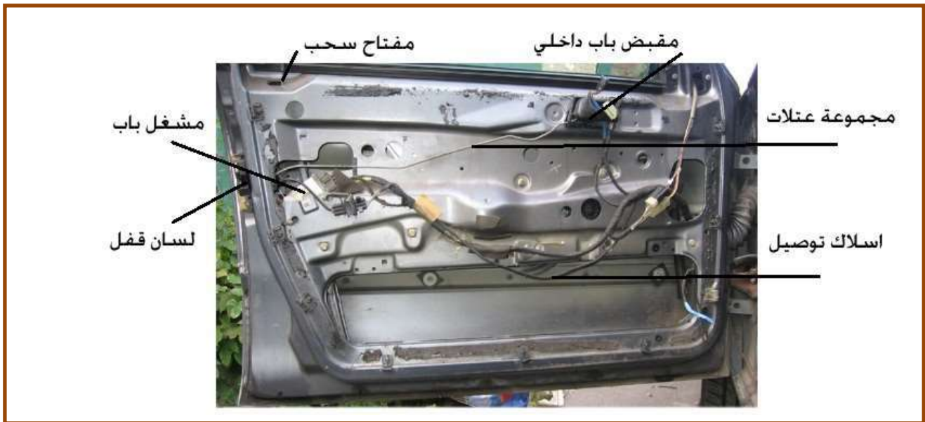
الشكل (3-1) أجزاء باب سيارة (منظومة قفل كهربائي)
