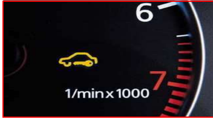
الشكل (1- 27 ) ضوء المبين لنظام شل الحركة (المفتاح المستخدم ذو رمز صحيح )
