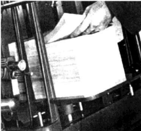
الشكل (2) ترتيب الورق في طاولة التلقيم
