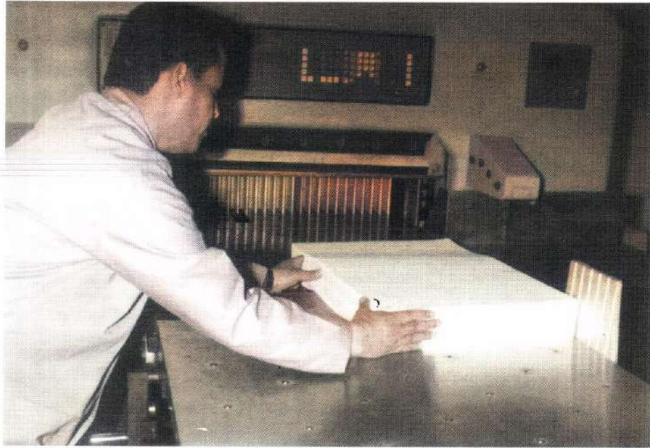
الشكل ( ٤ ) : دفع رزمة الورق باتجاه سطح المقص .
