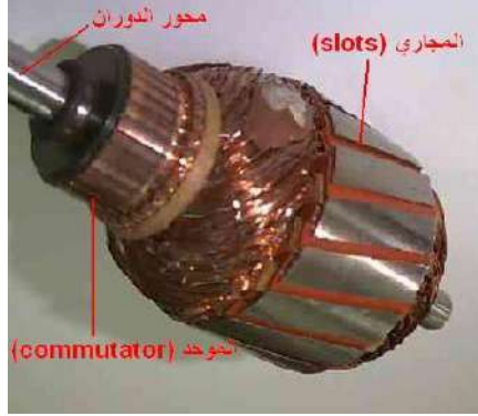
شكل (5-11) الجزء الدوار مثبت عليه الموحد
