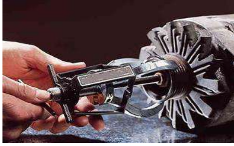
شكل ( 9-11 ) إزالة البكرة (إن وجدت) من طرف عمود الدوران باستعمال القالعة
