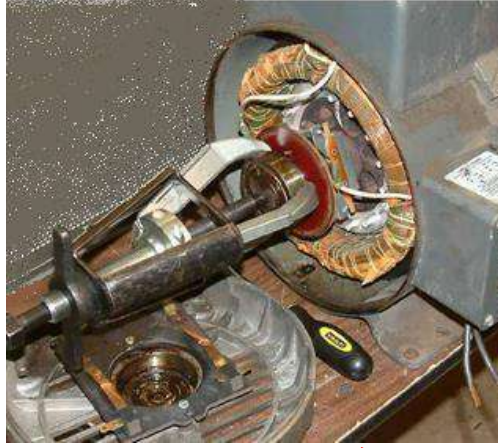
شكل ( 22-11 ) عملية سحب كرسي التحميل باستخدام الخالعة
