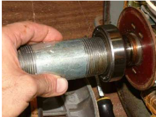
شكل ( 23-11 ) عملية تركيب كرسي التحميل على العمود
