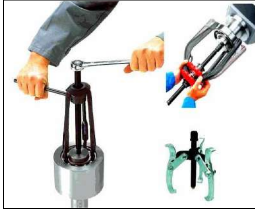
شكل ( 11-20 ) طريقة تثبيت الخالعة على كرسي التحميل
