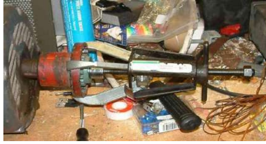
شكل ( 9-11 ) إزالة البكرة (إن وجدت) من طرف عمود الدوران باستعمال القالعة
