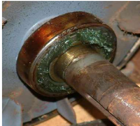
شكل ( 11-21 ) ضرورة تنظيف العمود قبل عملية سحب كرسي التحميل
