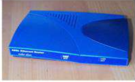
الشكل (6 - 8) مثال لراوتر الـ ADSL
