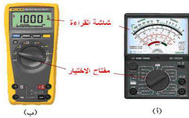
الشكل (1 - 1أ, ب) الملتيميتر التماثلي والرقمي
