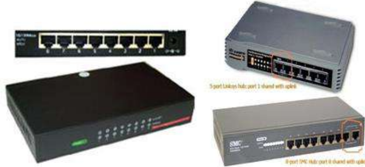
الشكل (6 - 2) بعض أشكال الـ HUB
