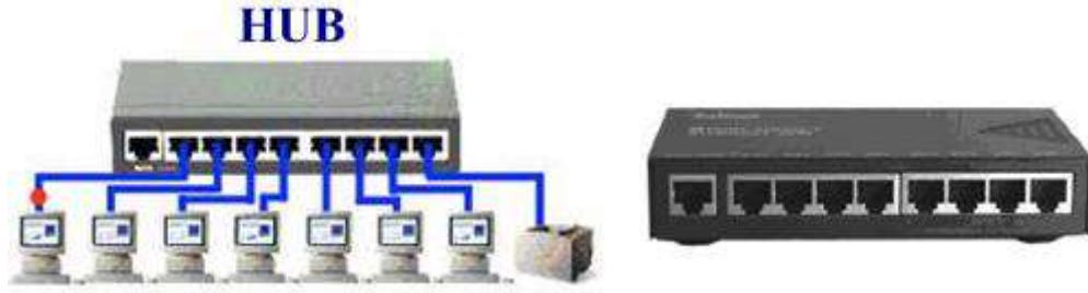
الشكل (6 - 1) المجمع المركزي HUB
