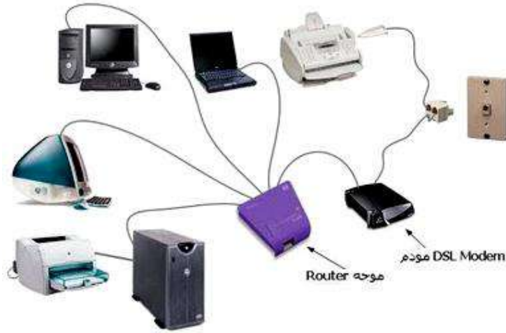
الشكل (7 - 3) نموذج لطريقة الاتصال DSL
