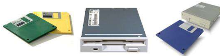
شكل رقم (4 - 22) مشغل الأقراص المرنة مع الأقراص
