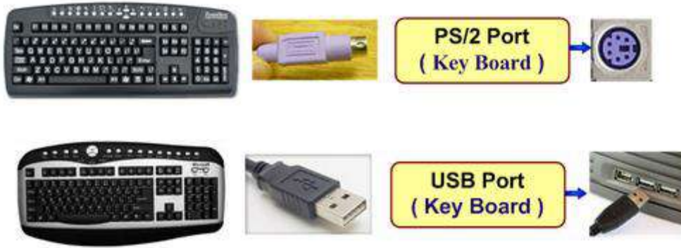
شكل ( 4 - 2 ) أنواع من لوحات المفاتيح (Keyboard)
