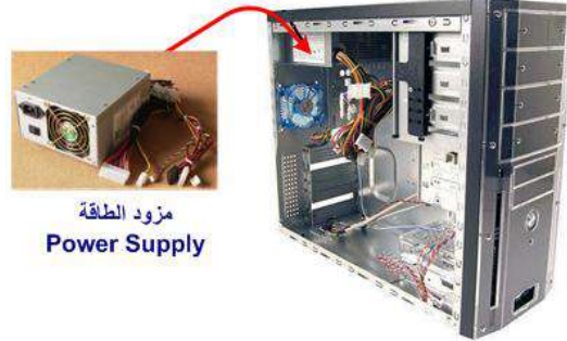
شكل (4 - 17) مزود الطاقة داخل صندوق الحاسوب
