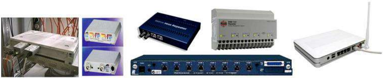
الشكل (6 - 4) أنواع من مكرر الإشارة Repeater
