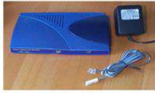
الشكل (6 - 8) مثال لراوتر الـ ADSL
