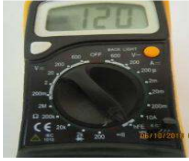
الشكل (16-7) فحص قيمة hfe لترانسستر نوع npn برقم BC337 .
