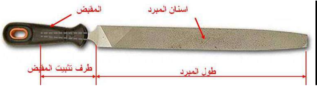
الشكل ( 1 - 2 ) يوضح أجزاء المبرد
