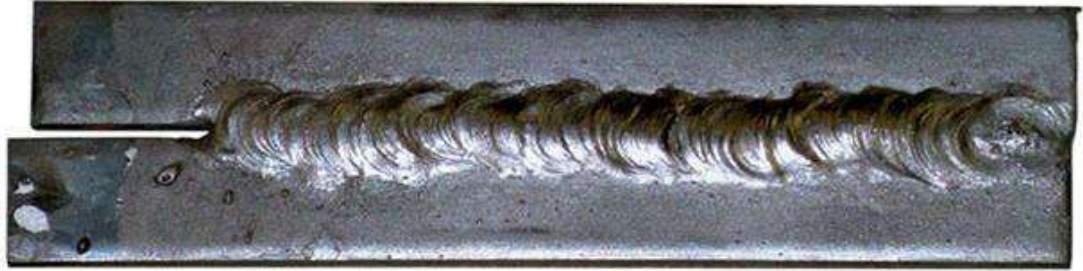
الشكل رقم ( 10 - 11 ) يوضح عملية لحام قطعتين متقابلة
