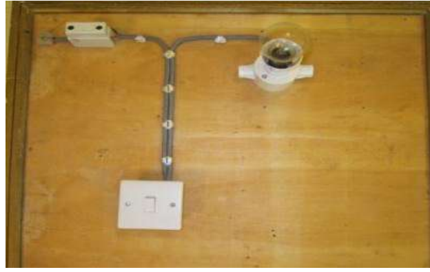
الشكل (17-4) ربط الكيبيلات الممددة الى العناصر الكهربائية بحسب المخطط
