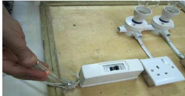
الشكل (4-38) الكشف عن الخط الحار بواسطة درنفييس الفحص
