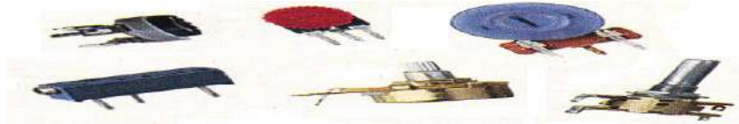
الشكل ( 21-2 ) الشكل المقاومة المتغيرة الكربونية
