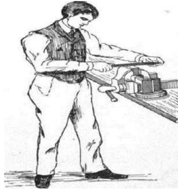
الشكل ( 2 - 6 ) يوضح الوقوف الصحيح أثناء عملية البرادة
