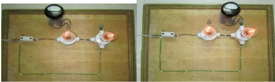
الشكل (19-2) قياس جهد المصباح 100w قياس جهد المصباح 60w .
