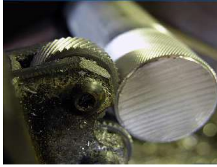
( 8 - 17 ) صورة توضيحية لقطعة العمل وعدة التحزيز
