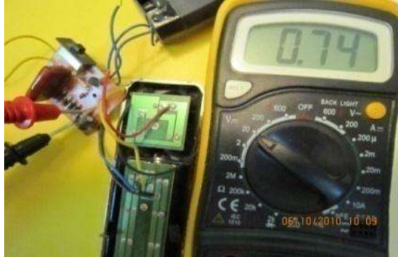
الشكل (4-7) فحص صلاحية الدايمود الاعتيادي نوع Si وهو مركب في الدائرة.
