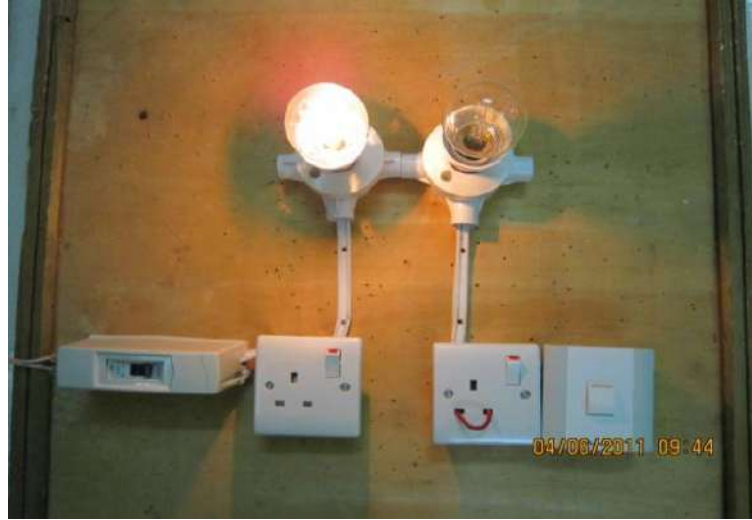
الشكل (4-39) الكشف عن القصر بواسطة دائرة التوالي (100W)
