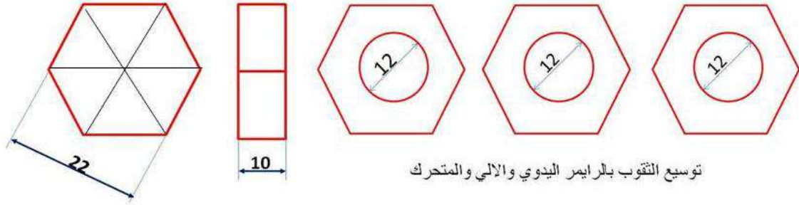
الشكل ( 4 - 15 ) يوضح قطعة العمل قبل وبعد التشغيل
