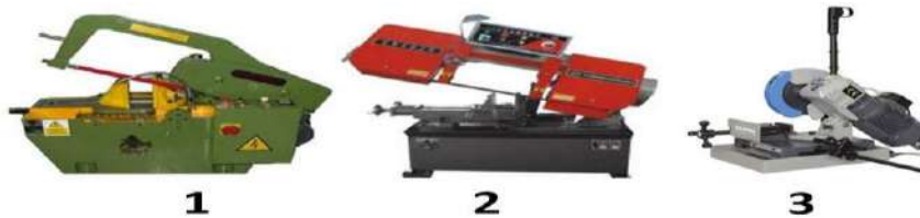
الشكل ( 5 - 9 ) يوضح بعض أنواع المنشار الآلي
