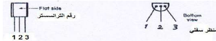
الشكل (7- 13) نرقم أطراف الترانزستور تحت الفحص تسجيل رقم الترانزستور (BC377)
