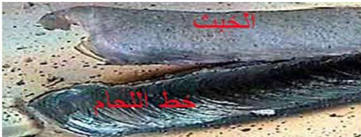
الشكل ( 7 - 3 ) يوضح تحول المادة العازلة لسلك اللحام الى ( الخبث ) بعد عملية اللحام
