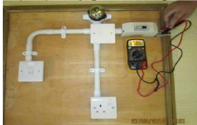
الشكل (27-4) قياس قيمة جهد مصدر التغذية بواسطة AVO
