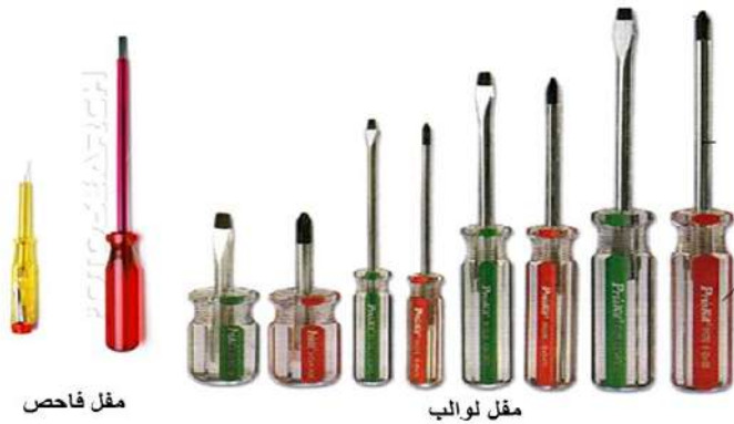
الشكل ( 1 - 7 ) يوضح المفل بأنواعه المختلفة
