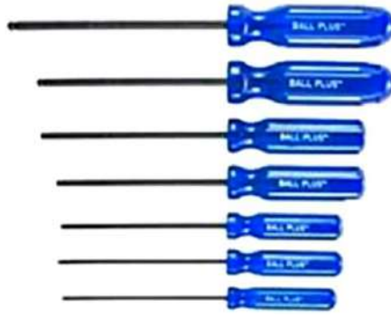
الشكل ( 8-1 ) يوضح أنواع من المفكات ذات الرؤوس النجمية والسداسية
