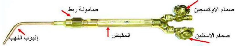
الشكل ( 7 - 20 ) يوضح أجزاء مقبض اللحام ( المشعل )
