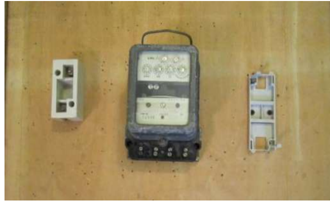
الشكل (50-4) تثبيت عداد الساعة 1Ph وقاعدة المصهر وغلاف القاطع على اللوحة.
