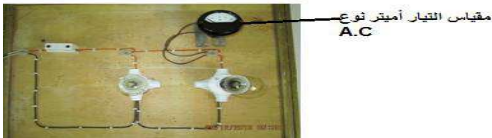
الشكل (13-2) يوضح ربط الأسلاك بعد قشطها بالمصهر والترنل وماسكي المصباح
