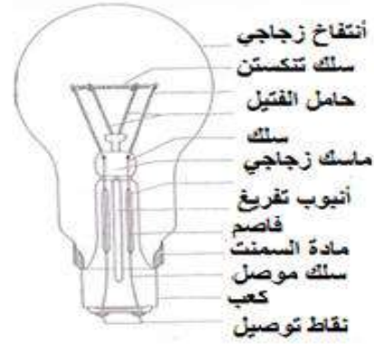
الشكل ( 4- 10 ) الشكل وأجزاء مصباح التنكستن .
