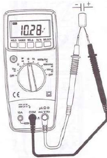
الشكل (5-22) فحص قيمة سعة المتسعة بواسطة جهاز المتعدد الاغراض.
