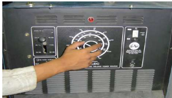
الشكل ( 7 - 4 ) يوضح ضبط قيمة التيار بماكنة اللحام
