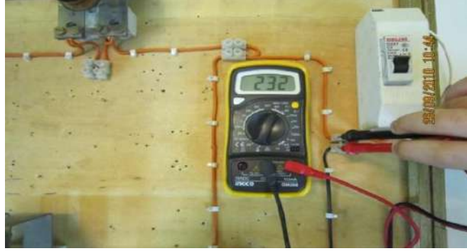
الشكل (5-30) قياس قيمة جهد المصدر المتناوب المغذي 220v/50Hz .
