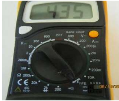
الشكل (17-7) فحص قيمة hfe لترانسستر نوع pnp برقم BC214 .
