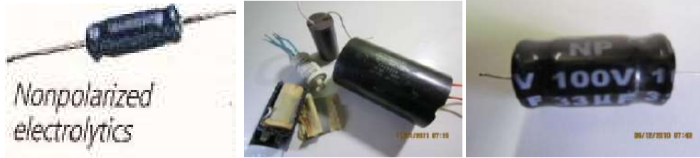
الشكل (5-8) الشكل المتسعة غير المستقطبة الالكتروليتية .
