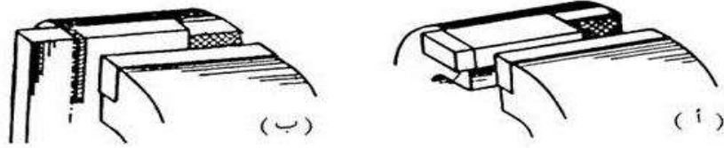
الشكل ( 5 - 7 ) يوضح طريقتين لربط قطعة العمل عند النشر
