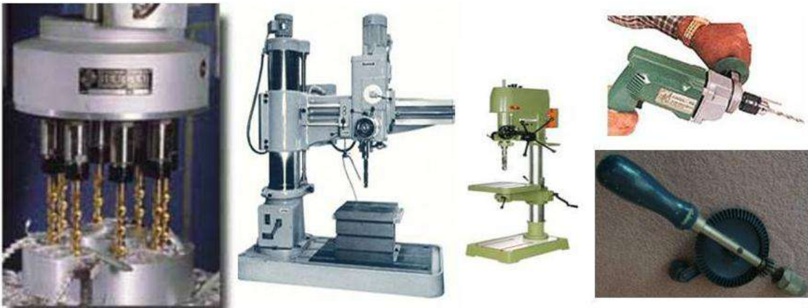
الشكل ( 4 - 6 ) يوضح أنواع المثاقب ( من اليسار مثقب متعدد المحاور ، مثقب الدف ، مثقب منضدي ، مثقب يدوي كهربائي ، مثقب يدوي ميكانيكي )
