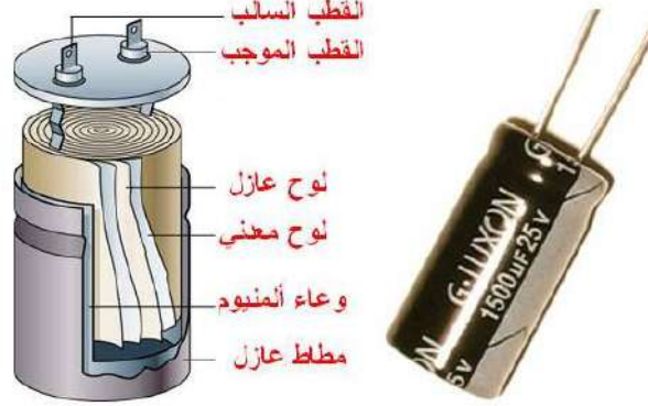
الشكل (3-5) تركيب المتسعة الالكتروليتيية (المستقطبة) وأشكالها.
