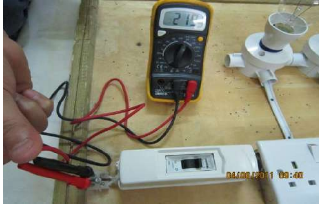
الشكل (4-37) قياس قيمة جهد المصدر المغذي بواسطة AVO
