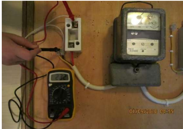
الشكل (4-52) قياس قيمة جهد مصدر التغذية للشبكة الكهربائية الوطنية .
