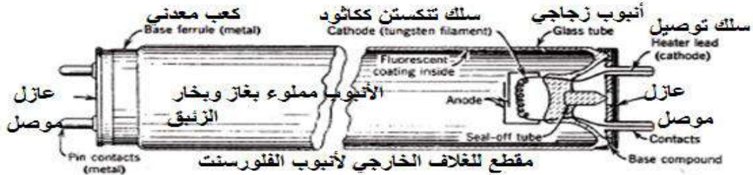
الشكل (4-11) أجزاء مصباح الفلورسنت
