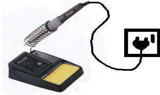
الشكل (1- 26) توصيل كاوية اللحام بمصدر التغذية الكهربائية
