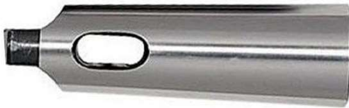
الشكل ( 8 - 18 ) يوضح أحد أنواع السلبات التي تستعمل في تثبيت البرايم
