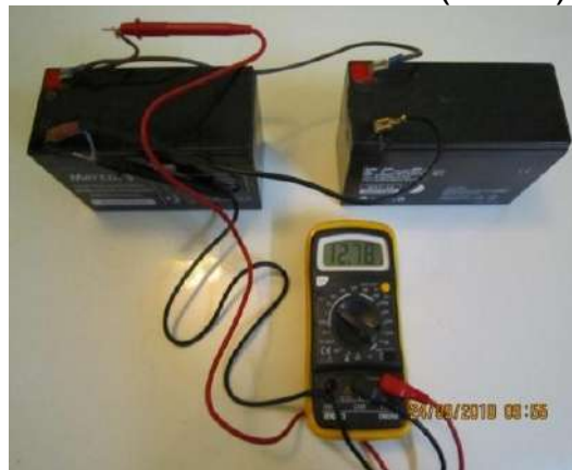
الشكل ( 6-16) قياس جهد بطاريتين جافتين على التوازي .
