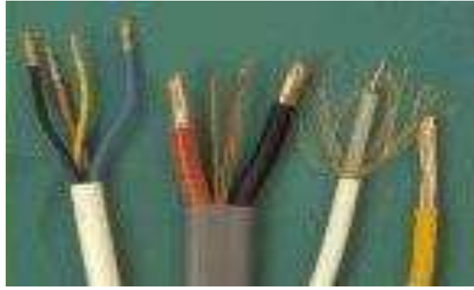
الشكل ( 1 - 4 ) يوضح كيبيلات موصلة معزولة بالبلاستيك .
