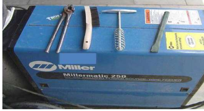
الشكل ( 1 - 9 ) يوضح العمل الخطأ بوضع العدد على الماكينة
