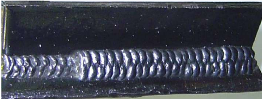
الشكل ( 7 - 14 ) يوضح بناء خطوط اللحام وتداخلها
