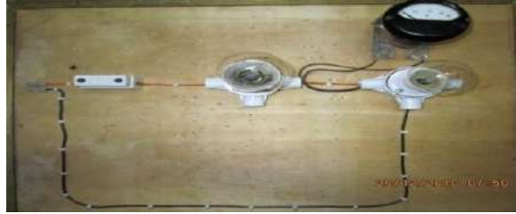
الشكل (18-2) توصيل الأسلاك الى هولدر المصباحين وقاعدة المصهر والكونتroller والمقياس
