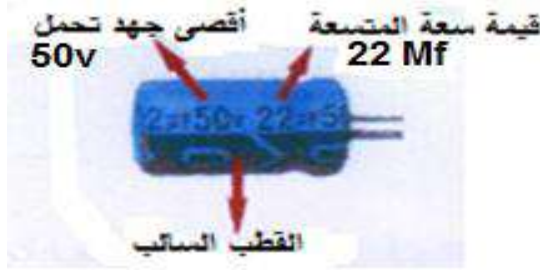
الشكل (4-5) قراءة مواصفات متسعة الكتروليتية .
