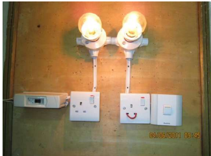
الشكل (4-40) الكشف عن القصر بواسطة دائرة التوالي (200W).
