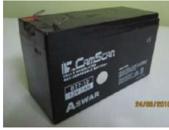
الشكل (5-6) بطارية نوع الرصاص المحكومة الجافة 12v/7Ah
