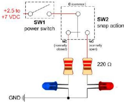
٣- نفذ الدائرة الكهربائية لتشغيل عنصر إضاءة باستخدام المفتاح Snap مستعيناً بالشكل المجاور.
