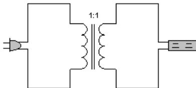
6- نفذ تأسيس محولة عزل في الورشة التي تعمل فيها وتأكد من الفولتتيات الداخلة والخارجة بالاستعانة بالمسؤول عن تدريبك.
