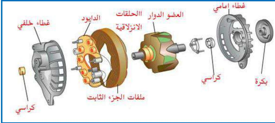
شكل (١٢-٥٦) أجزاء مولد التيار المتناوب
