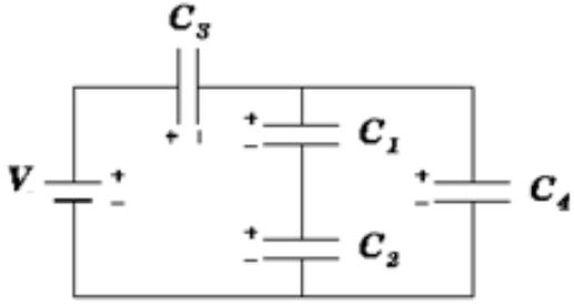
١- الدائرة الموضحة بالشكل المجاور مكونة من أربع متسعات موصلة بالتوالي والتوازي ( توصيل مركب) المطلوب تبسيط الدائرة لحساب السعة الكلية. استخدم جهاز RLC لقياس  $C_{12}$  أي  $C_1$  و  $C_2$  بالتوالي وقارن حساباتك العملية والنظرية.
