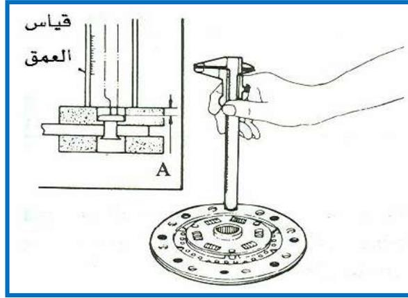
شكل ( ١٣-١٤ ) مقياسا للأعماق أو قدمة لقياس عمق الراس المبرشم لقرص الاحتكاك
