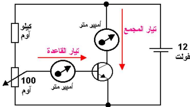
دائرة اختبار عامل تكبير التيار في الترانزستور
