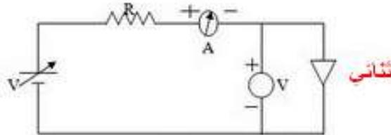
٤- غير فولتية البطارية بخطوات كل خطوة  $0.1V$  من  $(0 - 1) V$  وسجل التيار المار في الثنائي لكل خطوة.
