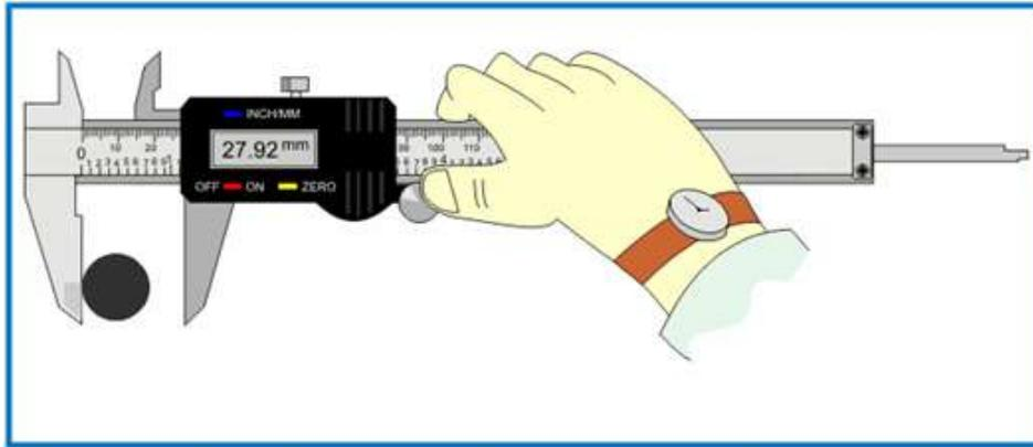
شكل ٩-٩ قياس وقراءة القدمة الرقمية للمسافات الخارجية
