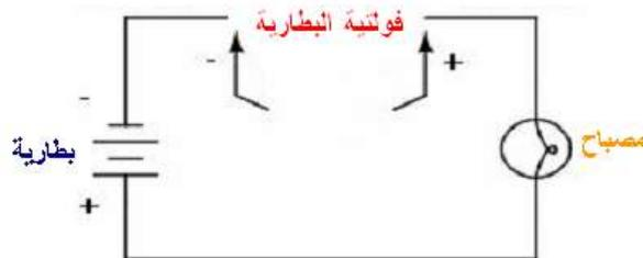
شكل 2 - 3 الدائرة الكهربائية المفتوحة
