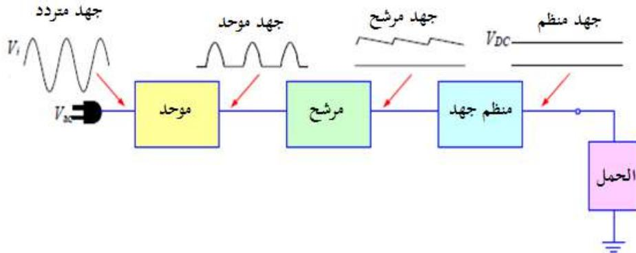
شكل ٧-٩ شكل الموجة الكهربائية بعد خروجها من كل مرحلة من مراحل مجهز القدرة
