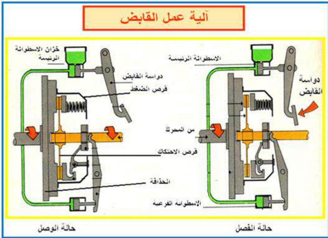
شكل (١٣-٤) آلية عمل القابض في الوصل والفصل باستعمال طريقة إيصال الحركة الهيدروليكية
