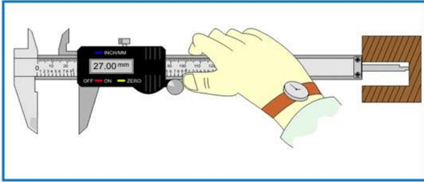
شكل ٩-١١ قياس القدمة الرقمية لمسافات العمق
