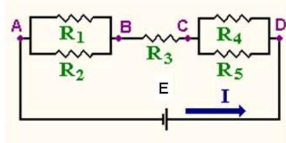
شكل ٢ - ١١ دائرة كهربائية توضح الربط المختلط
