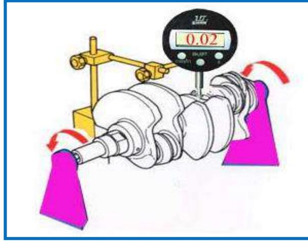
شكل ٩-٣٠ قراءة مقدار التآكل مباشر من الساعة الرقمية
