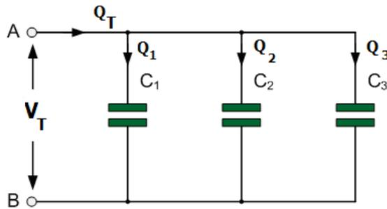
٢- تأكد من فحص المتسعات باستخدام جهاز الأفوميتر التناظري، اقرأ قيمة كل متسعة باستخدام جهاز RLC. سجل قيمة السعة الكلية عملياً وقارن حساباتك العملية والنظرية، استعن بالقانون الآتي:
