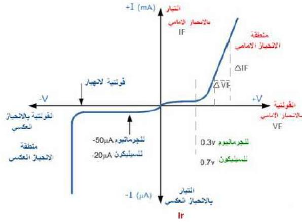
شكل ٦- ١٠ يوضح فولتية الانهيار
