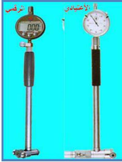
شكل ٩-٢٢ أنواع أداة قياس المؤشر القرصي لقياس قطر الأسطوانة
