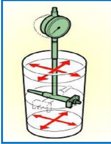
شكل ٩-٢٤ وضع أداة القياس بشكل عمودي
