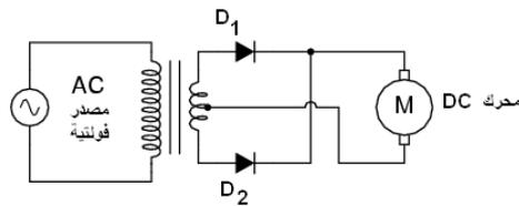
١١- باستخدام الأفوميتر اقرأ الفولتية المتناوبة الخارجة من جهاز القدرة.
