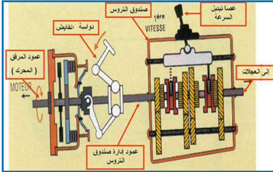
شكل (١٣-١) طريقة فصل ووصل الحركة التي يتحكم بها القابض
