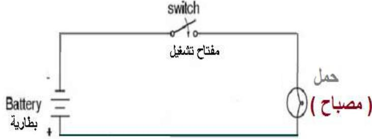
شكل 2 - 1 الدائرة الكهربائية البسيطة
