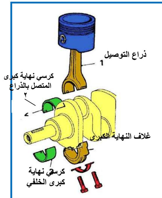
شكل ١١-١٥ يوضح أجزاء المكبس وذراع التوصيل
