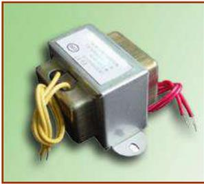
5- اقرأ مقاومة الملف الابتدائي والثانوي لمحولة نسبة التحويل فيها 1:1. سجل مقاومة الملف الابتدائي والملف الثانوي [تدعى هذه المحولات بمحولات العزل وتستخدم للحماية من الصدمة الكهربائية لأن الملف الثانوي يكون معزولاً عن الأرضي. لاحظ الشكل المجاور.
