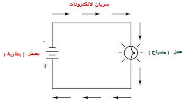
شكل 2 - 2 الدائرة الكهربائية المغلقة
