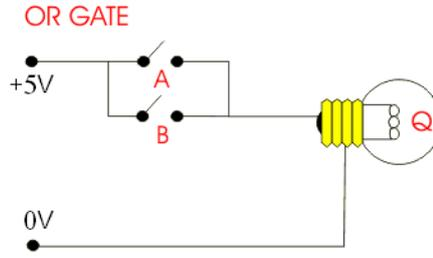
شكل ٣-٨ التوضيح بطريقة المفاتيح عمل دائرة OR
