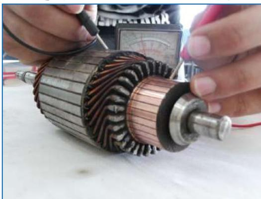
شكل (١٢-٢٢) فحص التوصيل بين موحد التيار وجسم العضو الدوار
