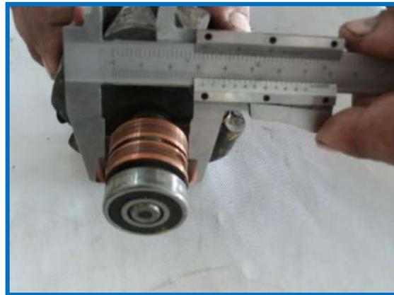
شكل ( ١٢-٦٤ ) قياس الحلقات الانزلاقية
