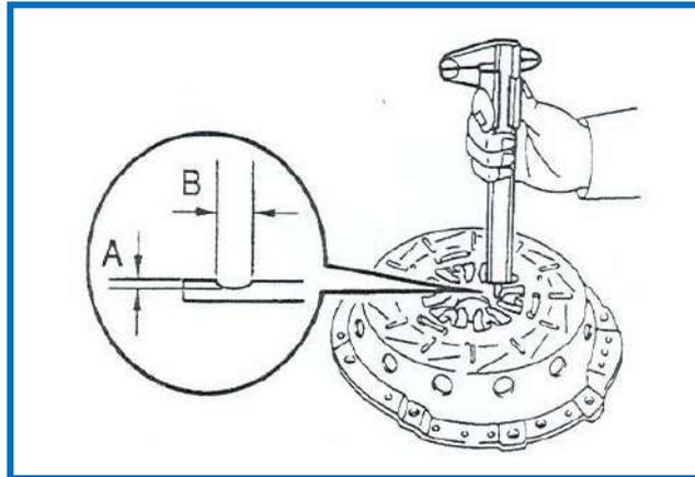
شكل (١٣-١٣) قياس عمق وعرض النابض الورقي لقياس مقدار التآكل
