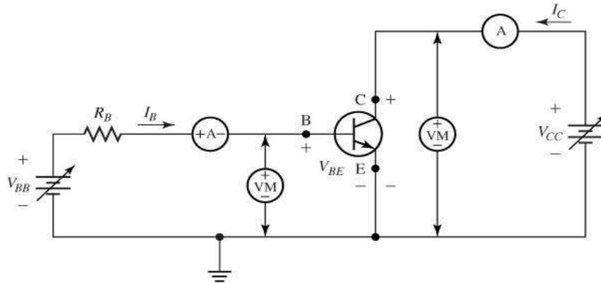
شكل ٧-٣ دائرة قياس خصائص الترانزستور
