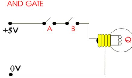
شكل ٢-٨ مبسط يوضح بطريقة المفاتيح عمل بوابة AND
