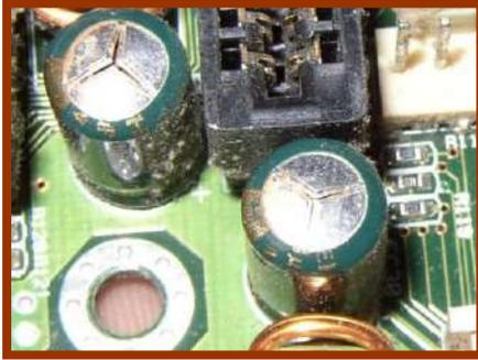
٩- في الشكل المجاور متسعات تالفة، كيف يمكنك تشخيصها بدون استخدام أجهزة القياس وباستخدام الآفوميتر الرقمي.
