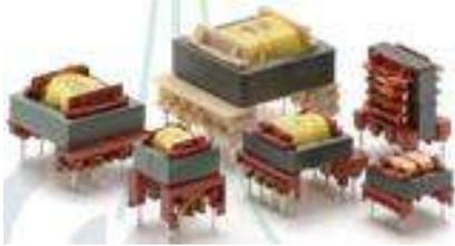
3- باستخدام الفولتميتر افحص المحولة 220V/6V .
