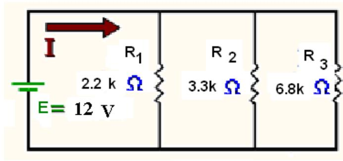
٥- بتغيير المقاومتين ( $R_1$  ,  $R_2$ ) بتوصيل التوازي بأحمال (Loads) مثل المصابيح الكهربائية يمكنك عزيزي الطالب المقارنة بين دائرتي توصيل المقاومات الكهربائية بالتوالي والتوازي كما في الشكل الآتي:
