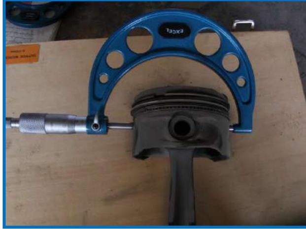
شكل ١١-25 قياس القطر الخارجي للمكبس
