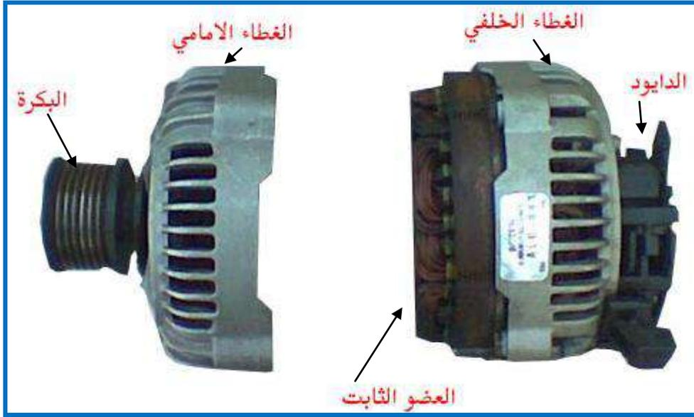
شكل ( ٥٩-١٢ ) أجزاء مولد التيار المتناوب
