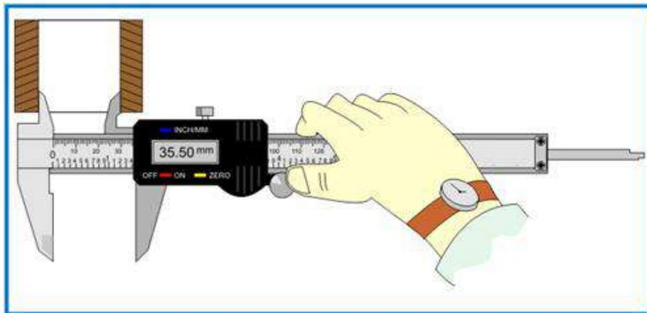
شكل ٩-١٠ قراءة قياس القدمة الرقمية للمسافات الداخلية
