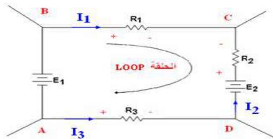
شكل ٢ - ١٦ تتبع التيار باتجاه عقرب الساعة
