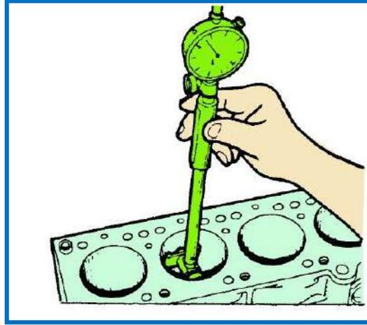
شكل 11-12 قياس القطر الداخلي للأسطوانات
