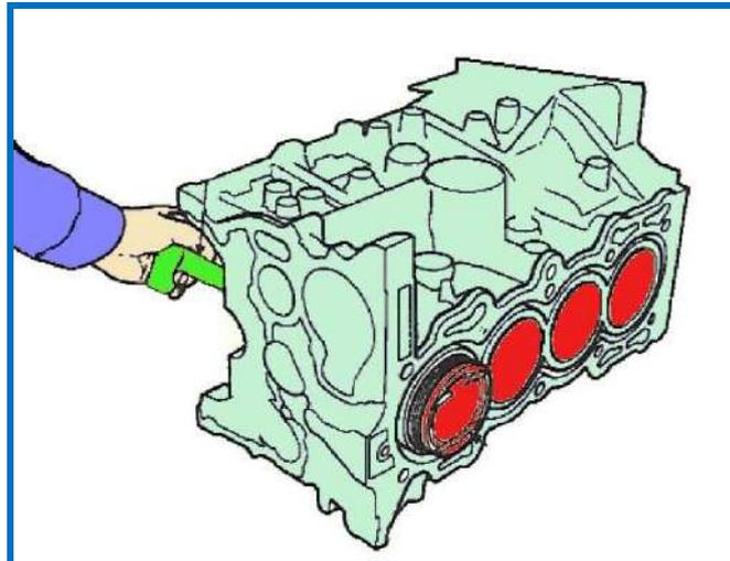
شكل ٥-١١ استخدام النهاية الخشبية للمطرقة البلاستيكية لدفع ذراع المكبس
