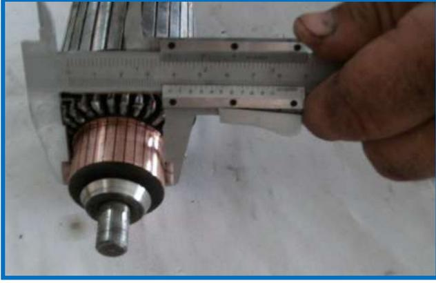
شكل (١٢-٢٥) قياس قطر موحد التيار
