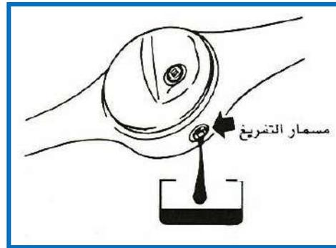
شكل (١٣-٥٦) تفريغ الزيت
