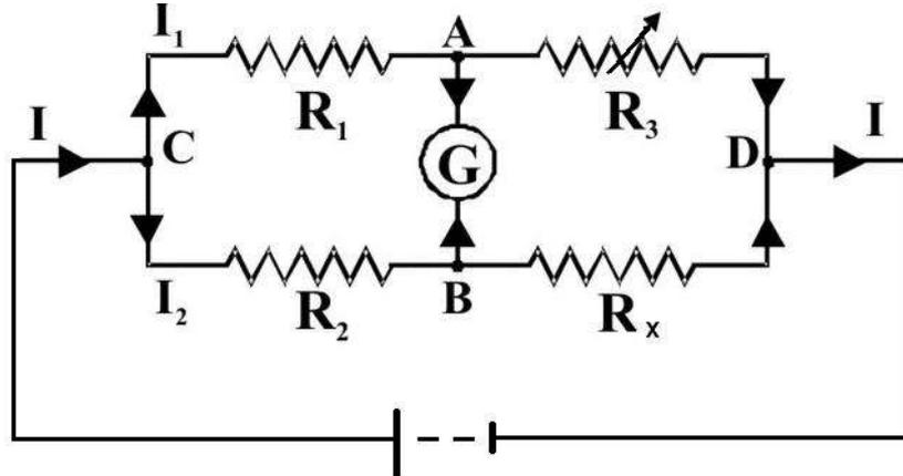
شكل ٢ - ١٢ مقاومات موصلة بطريقة قنطرة وتستون
