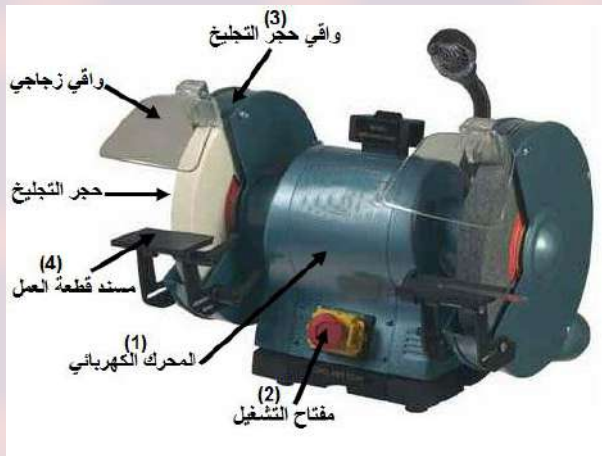
الشكل (4-9) أجزاء ماكينة التجليخ الثابتة
