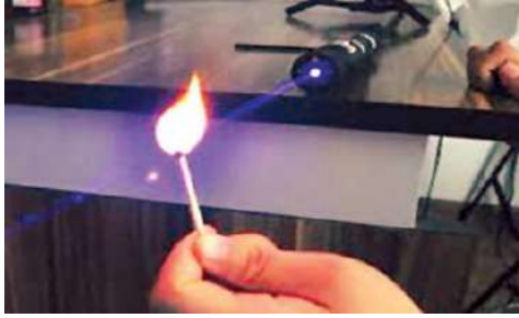
الشكل (4) يبين استعمال الدخان لظهور شعاع الليزر
