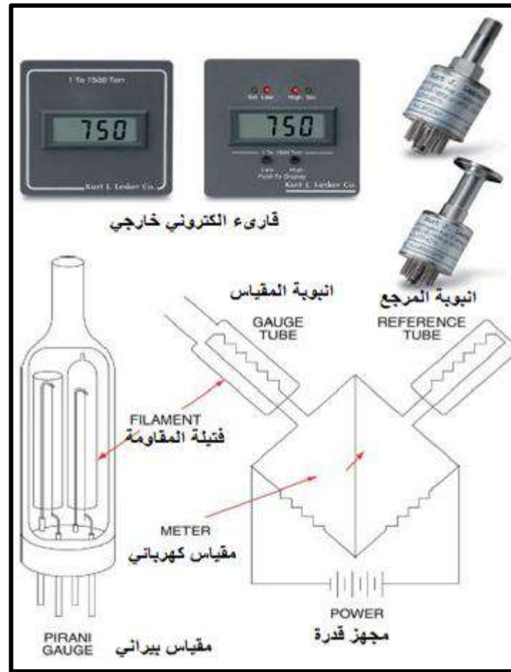
الشكل (8) يوضح قنطرة ويطستون ومقياس بيراني Pirani Gauge
