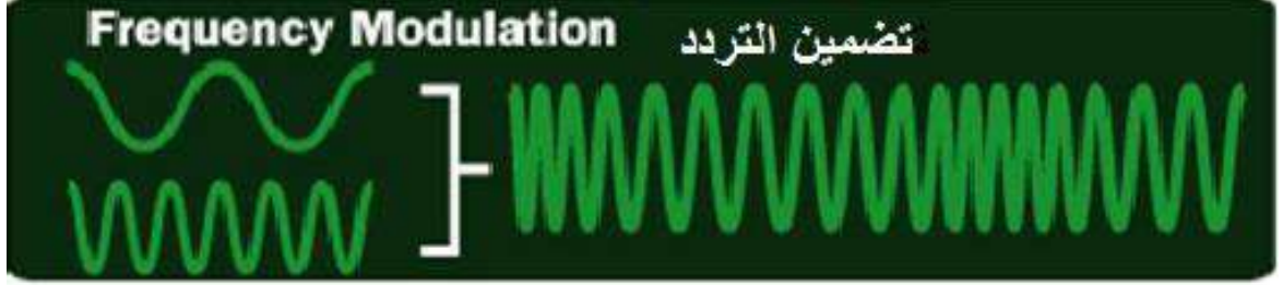
الشكل (3) يوضح موجات راديو مضمنة بنظام تضمين التردد
