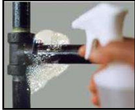
فحص التسريب بواسطة رغوة
