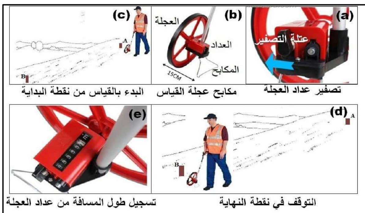
الشكل (1-25) خطوات قياس المسافة باستخدام عجلة القياس
