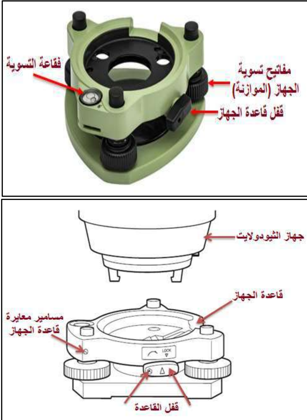
الشكل (6 - 11) قاعدة الجهاز (الترابريك)
