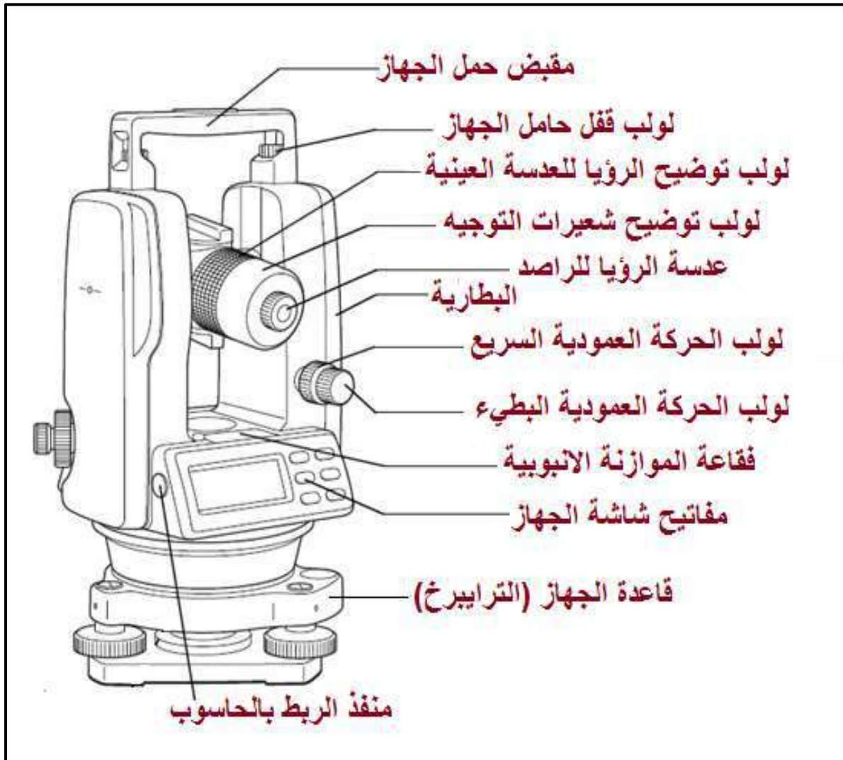
شكل (6 - 10 ، 1) أجزاء جهاز التيوبودولايت
