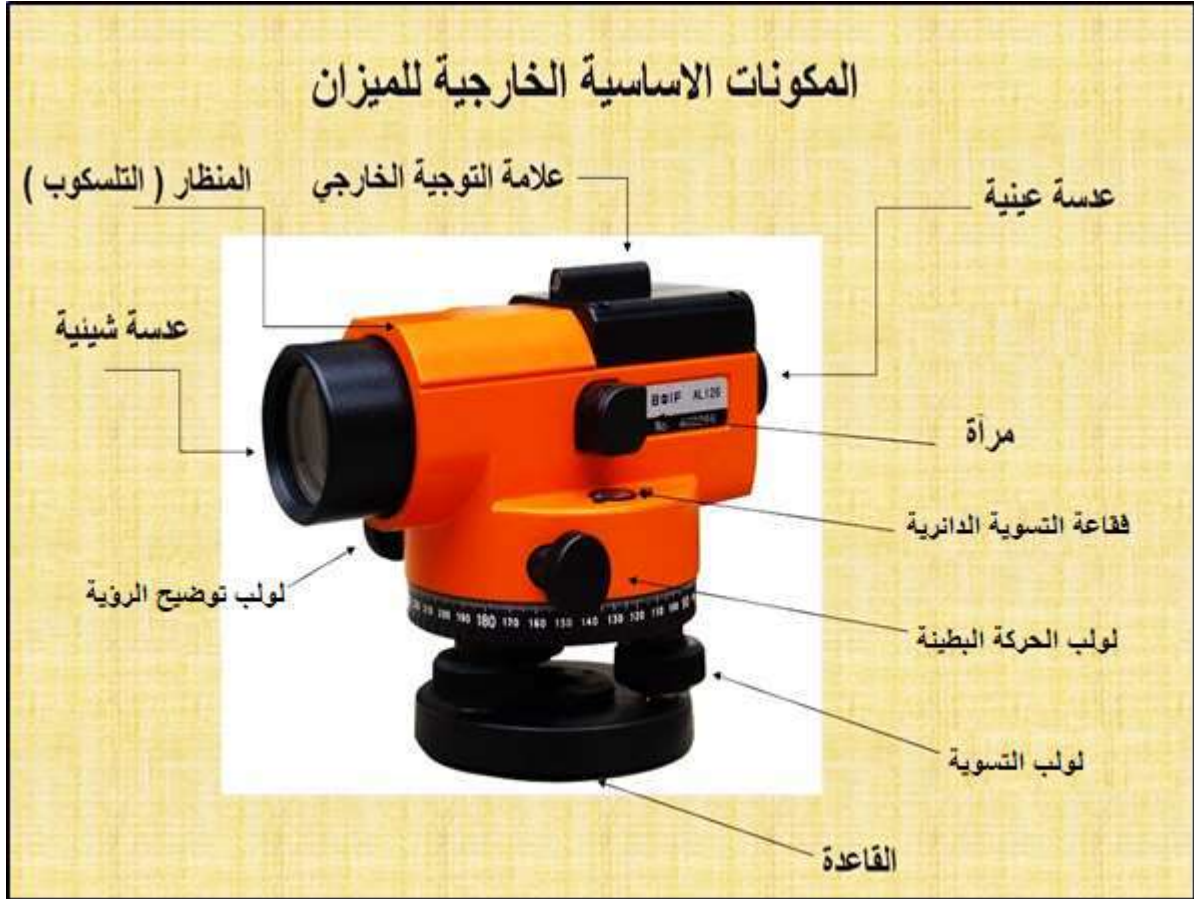
الشكل (5-9) اجزاء التلسكوب وملحقاته لجهاز الميزان
