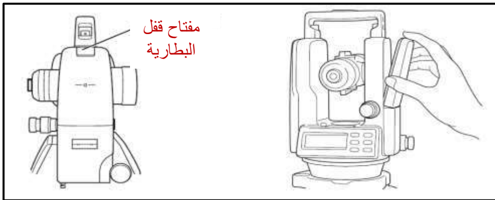
الشكل (6 - 26) تركيب بطارية الجهاز
