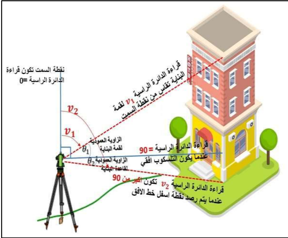
الشكل (6 - 34) الزاوية العمودية المقاسة بجهاز الثيودولايت
