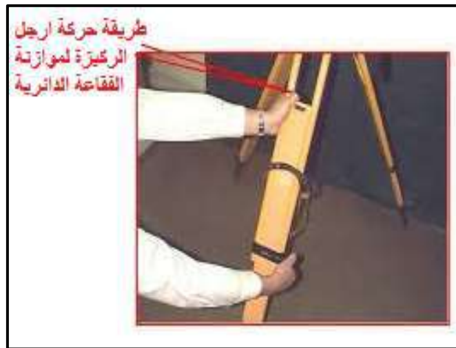
الشكل (6 - 23) موازنة فقاعة التسوية الدائرية بتحريك أرجل الركيزة
