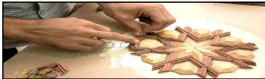
شكل رقم (3-20) يظهر إحدى خطوات تطعيم الخشب
