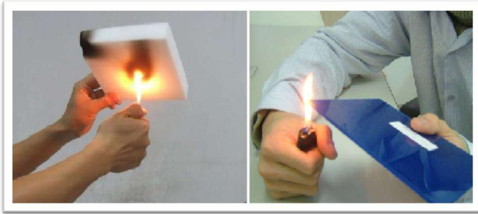
(شكل 5) ألواح عازلة مؤخره للحرائق
