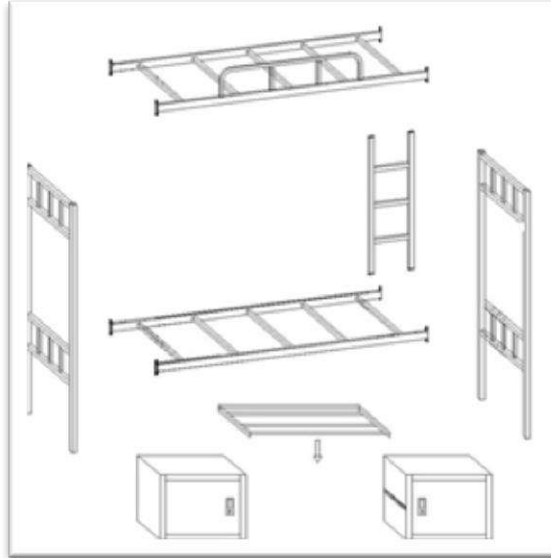
نموذج رقم (17) طريقة تركيب وتثبيت الاسره
