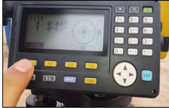
شكل (11-3) موازنة فقاعة الجهاز الالكترونية
