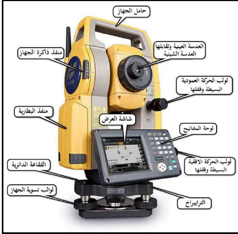
الشكل (1-1) يوضح الأجزاء الخارجية لجهاز المحطة المتكاملة
