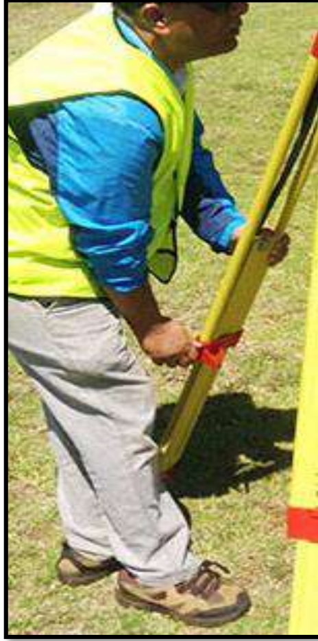
الشكل (8-1) تغيير ارتفاع الأرجل لضبط الفقاعة بشكل تقريبي
