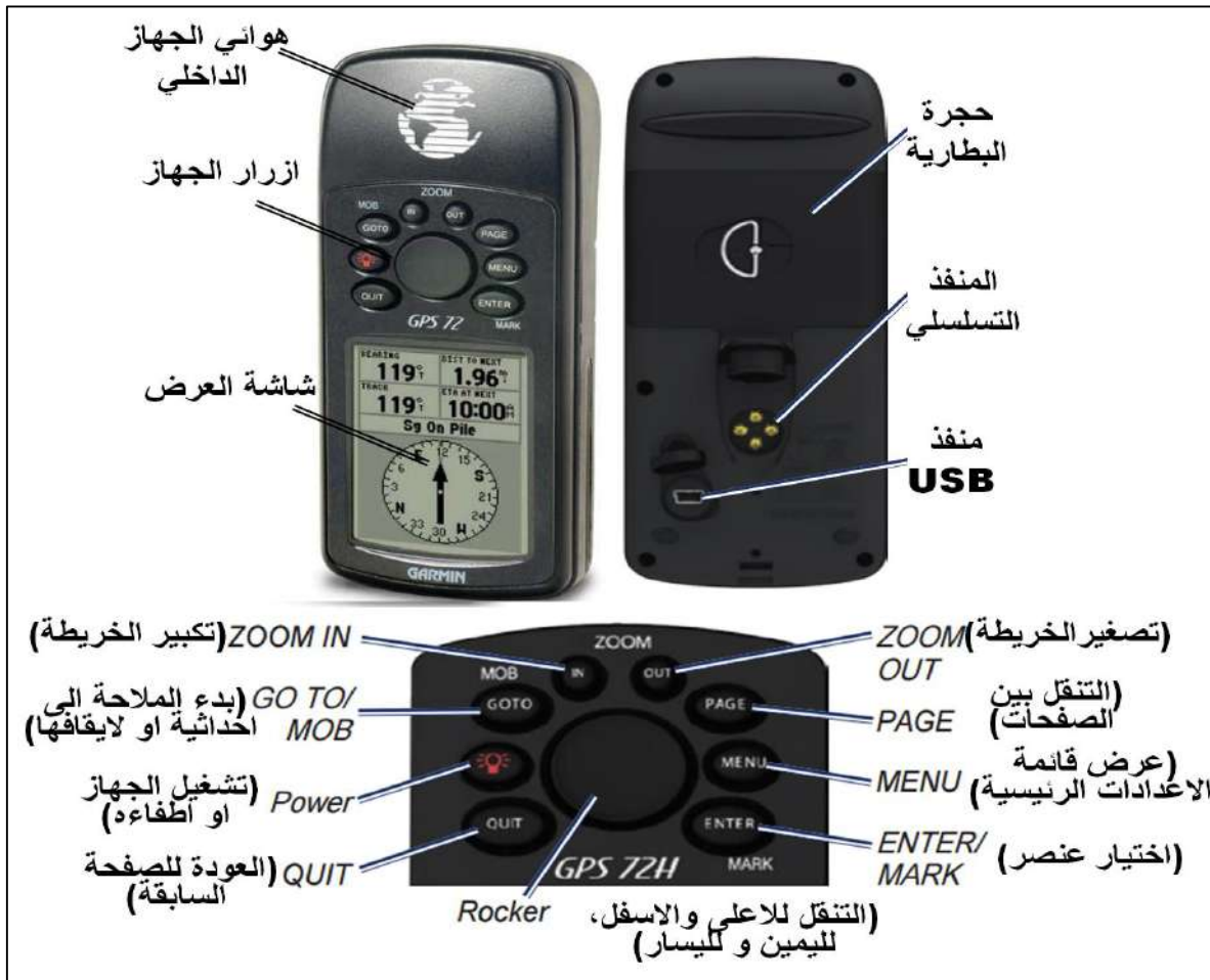
الشكل (2-14) الاجزاء والازرار الرئيسية لجهاز الكارمن 72 (GPS Garmin 72)
