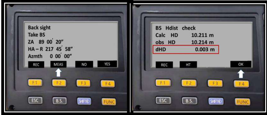
شكل (17-3) التحقق من صحة احداثيات نقطة B.S المدخلة
