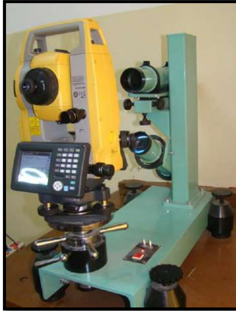
الشكل (12-1) طريقة تثبيت جهاز المحطة المتكاملة على جهاز المعايرة (الكولوميتز)
