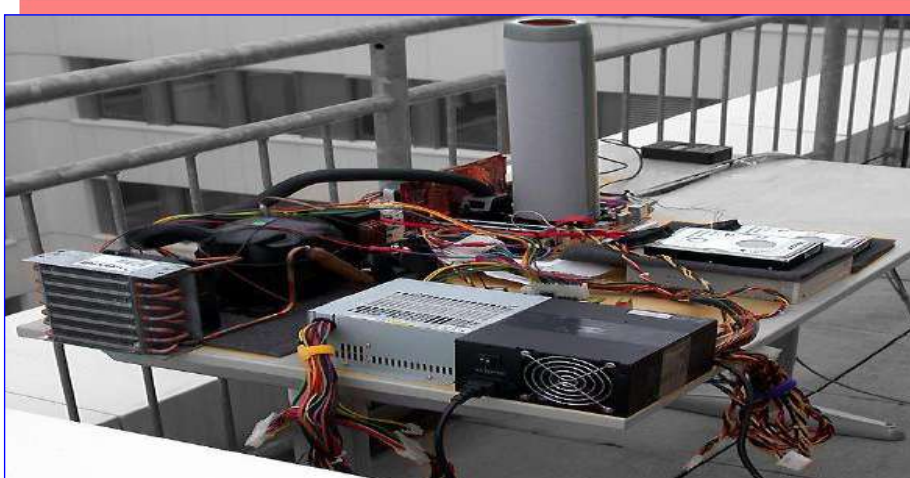
شكل 2-15 تبريد المعالج بالنيتروجين السائل
