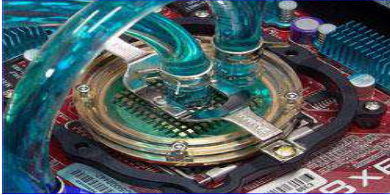
شكل 2-14 تبريد المعالج بالماء
