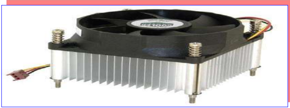
شكل 2-12 المبرد الحراري ملحق بمروحة تبريد
