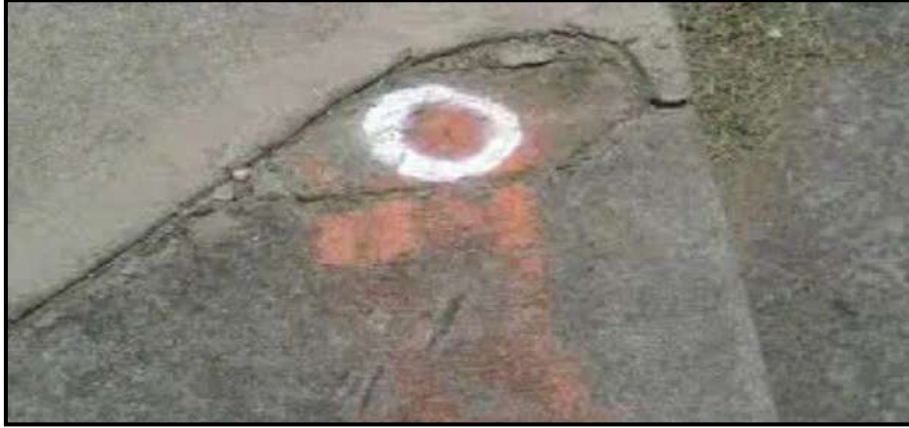
الشكل (2-6) راقم التسوية نوع المعيار المؤقت
