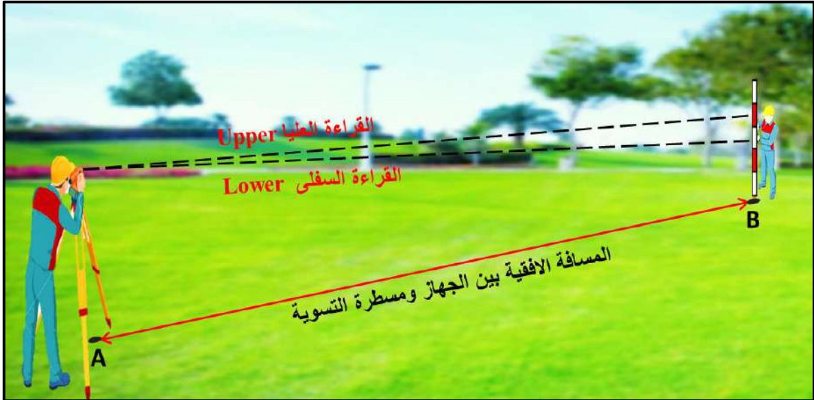
الشكل (16-2) قياس المسافة بين الجهاز والمسطرة
