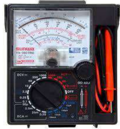
الشكل 3-2 جهاز قياس أفوميتر (تماثلي)
