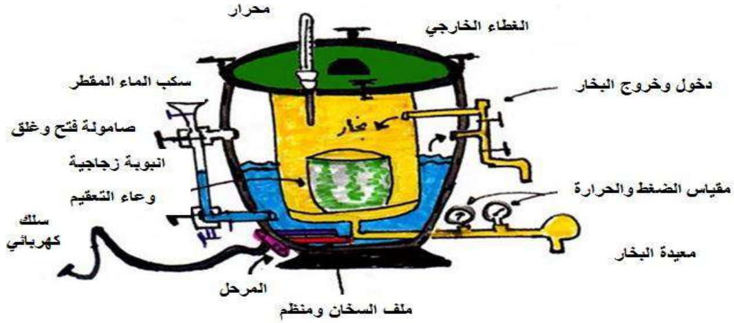
الشكل 9-10 الأجزاء الداخلية والخارجية لجهاز التعقيم
