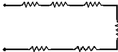
شكل 4-8 ربط مقاومات على التوالي
