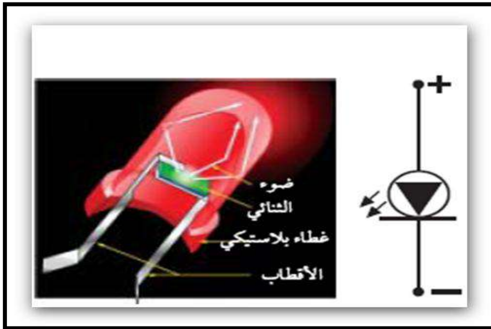
الشكل 9-12 ثنائي الإنبعاث الضوئي L.E.D
