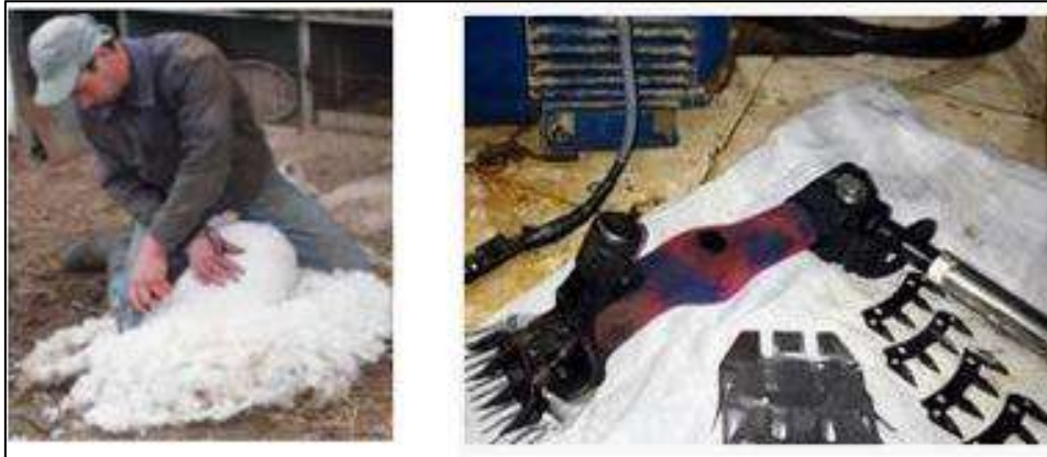
شكل 7-16: ماكينة جز الصوف وطريقة عملها.
