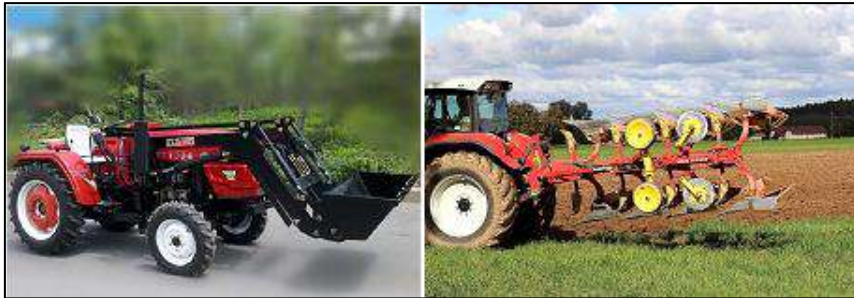
شكل 1-4: الجهاز الهيدروليكي في خلف الساحبة الزراعية ومقدمتها.
