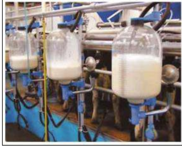
شكل 7-11: ماكينة ذات خطوط لسحب الحليب.
