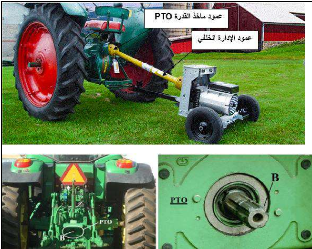
شكل 33-3: عمود مأخذ القدرة PTO.
