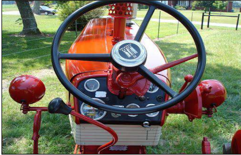
شكل 26-2 مبين مستوى الوقود في الخزان مبين درجة حرارة سائل التبريد المحرك.
