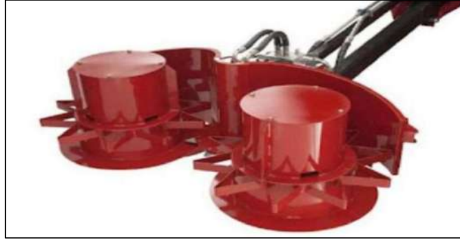
شكل 6-36: جهاز تقطيع القمم النامية للمحصول.
