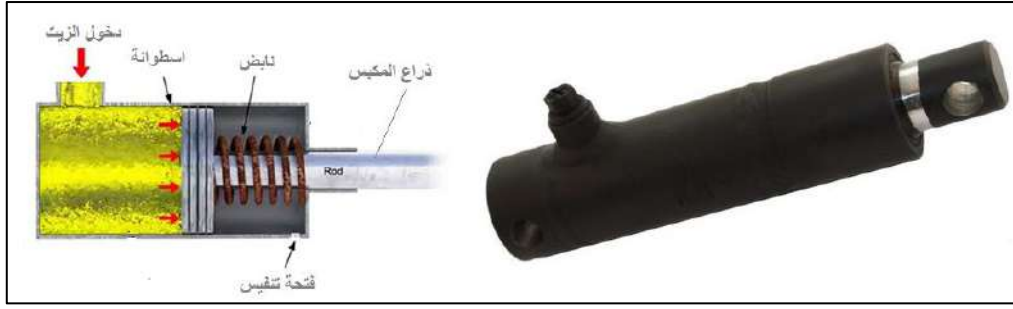
شكل 4-10: مقطع في أسطوانة هيدروليكية أحادية الفعل.
