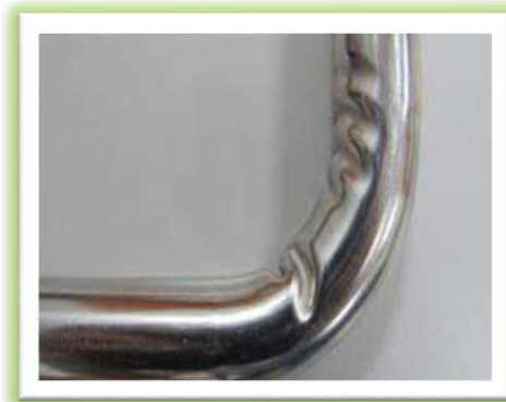
الشكل (17-1) عيوب تقويس الانابيب
