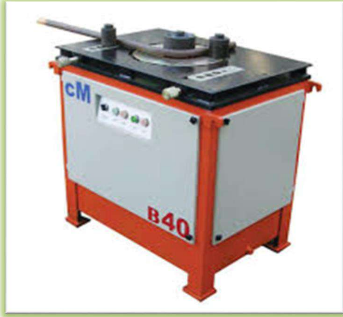
الشكل (20-1) مكائن حني الانابيب ذات الاقطار المختلفة
