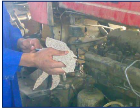
شكل 25-2 تنظيف عصا قياس الزيت
