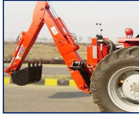
شكل 9-3 منظومة الرفع الهيدروليكية خلف الجرّار شكل 10-3 منظومة الرفع الهيدروليكية في مقدمة الجرّار
