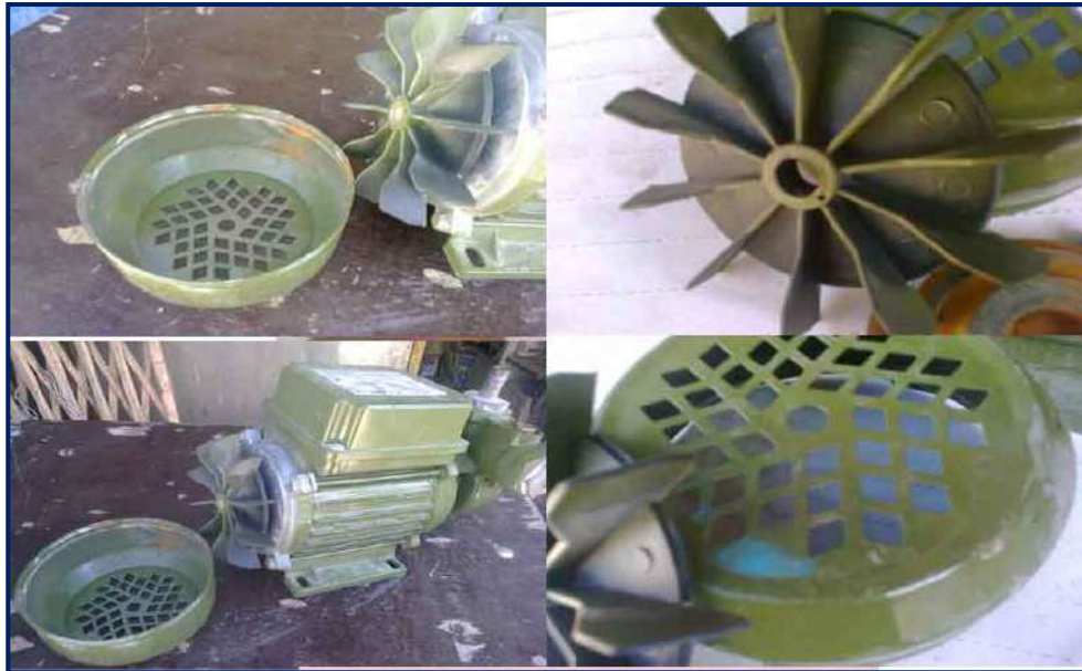
شكل 9-11 فتح الغلاف الخارجي لمروحة التبريد
