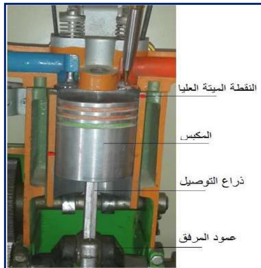
شكل 23-1 تحديد النقطة الميتة العليا
