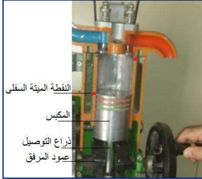
شكل 24-1 تحديد النقطة الميتة السفلى
