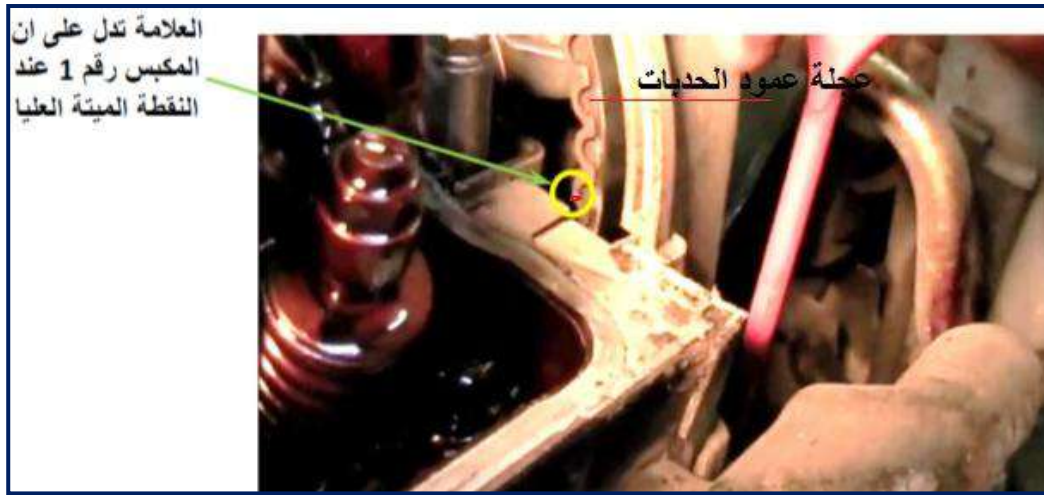
شكل 1-31 وجود علامة على عجلة عمود الكامات لتحديد النقطة الميتة العليا
