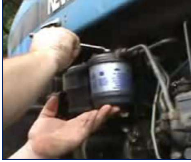
شكل 10-2 إرخاء برغي التنفيس من مرشح الوقود الابتدائي
