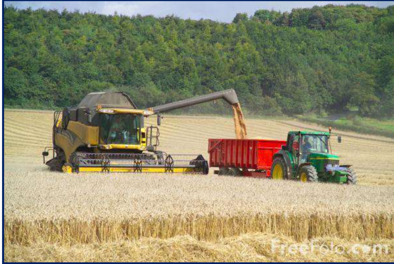
شكل 8-9 تفريغ الحبوب من خزان الحاصدة الى عربة النقل
