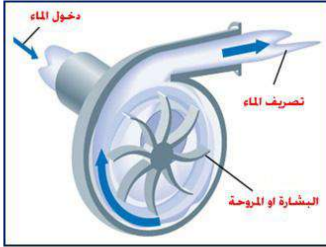
شكل 6-15 مبدأ عمل المضخة
