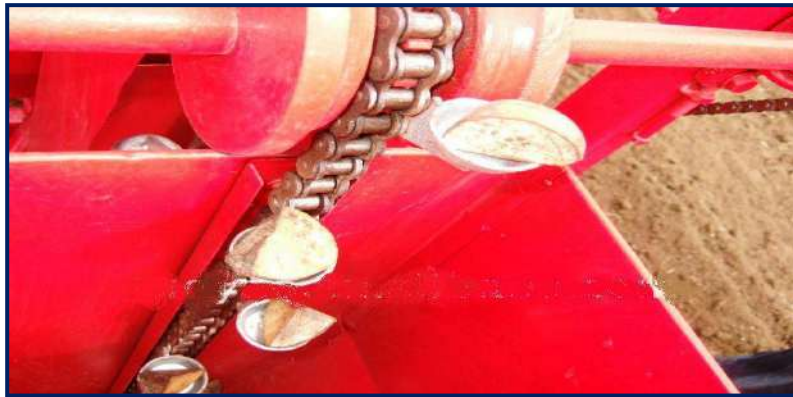
شكل 30-5 حمل كل كوب درنة واحدة
