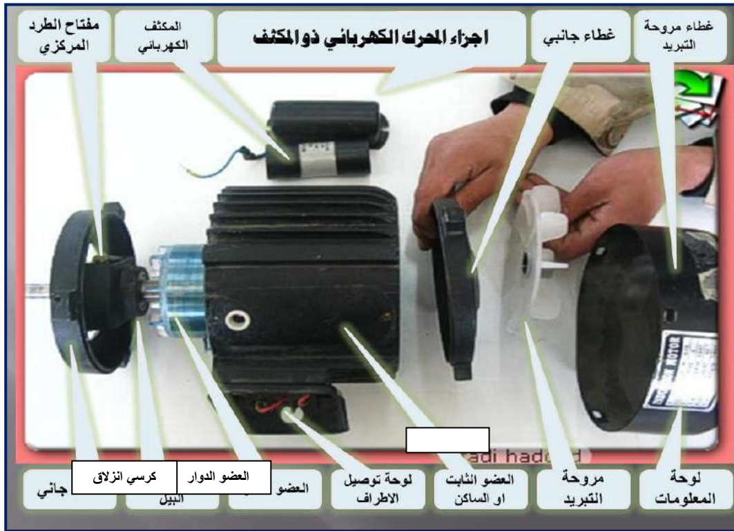
شكل 9-10 تسلسل فتح أجزاء المحرك الكهربائي
