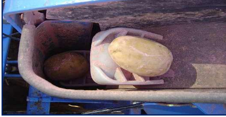
شكل 5-32 سقوط الدرنات في أكواب
