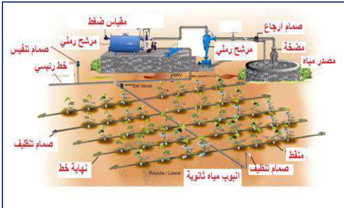
شكل 4-6 نموذج لشبكة الري بالتنقيط
