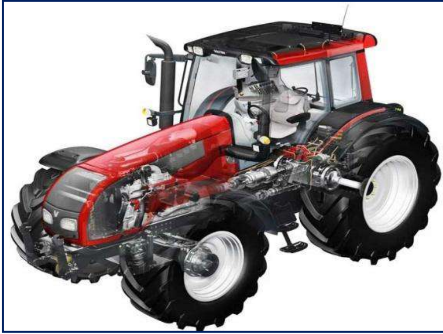
شكل 1-2 جرار زراعي يعمل بمحرك ديزل
