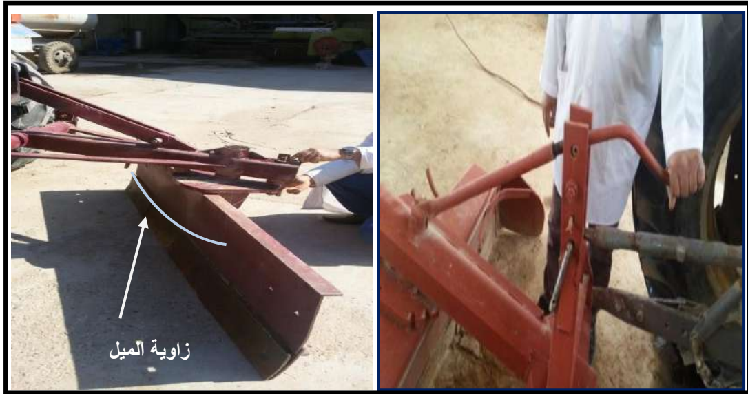
شكل 36-4 تقليل زاوية ميل آلة التسوية بوساطة العتلة اليدوية
