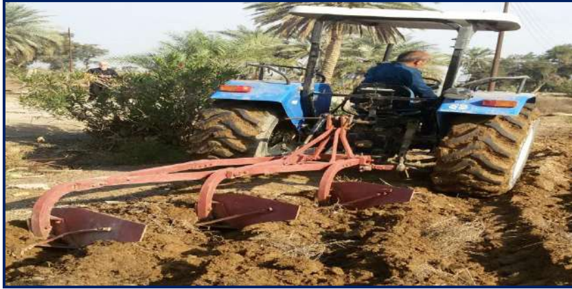
شكل 20-4 المحراث خلف الجرّار عند نزول عجلاتها اليمنى في أخدود الحرث
