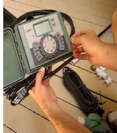
شكل 20-6 ربط التوصيلات الكهربائية مع مفتاح السيطرة
