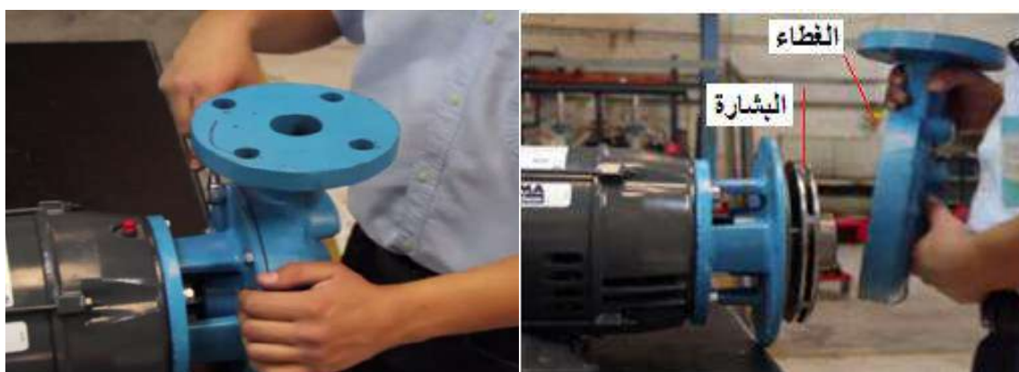
شكل 6-23 فتح بدن فتحة التصريف
