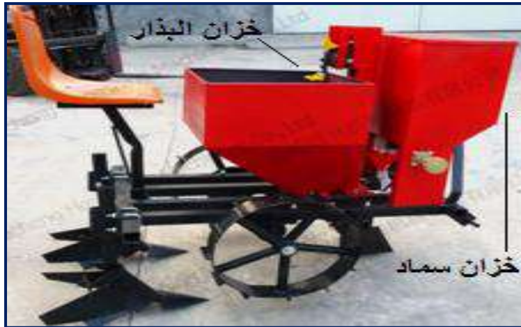
شكل 3-5 باذرة مزودة بخزان تسميد
