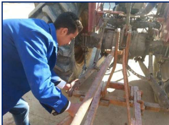
شكل 3-14 أرخاء ذراع الربط السفلية
