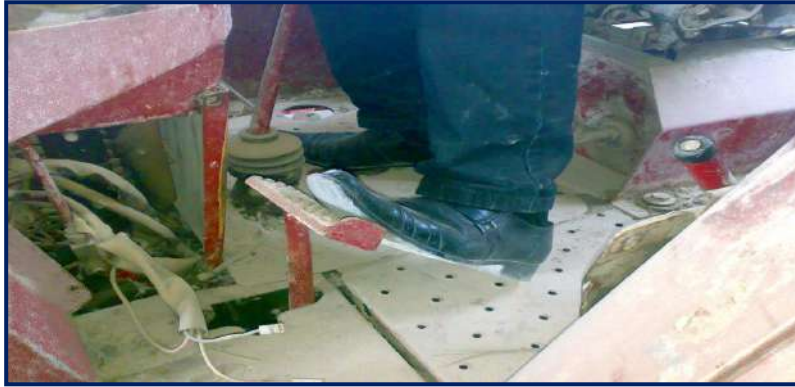
شكل 3-6 رفع القدم عن دواسة الفاصل ببطء
