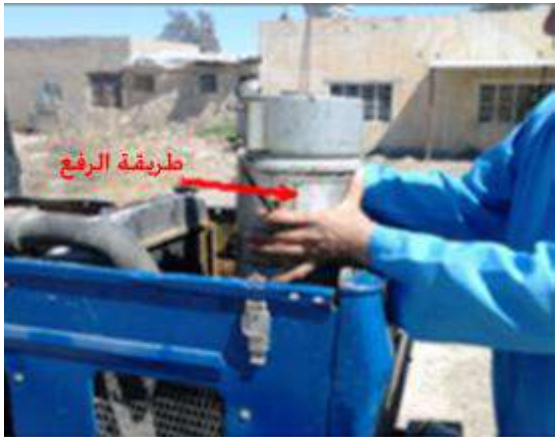
شكل 30-2 إخراج منقية الهواء من هيكل الساحبة.
