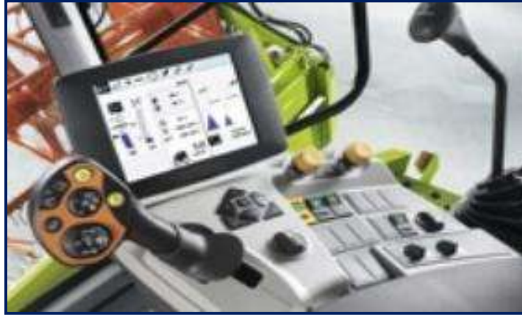
شكل 8-13 وحدة السيطرة الالكترونية على اجزاء الحاصدة والموجودة أمام السائق
