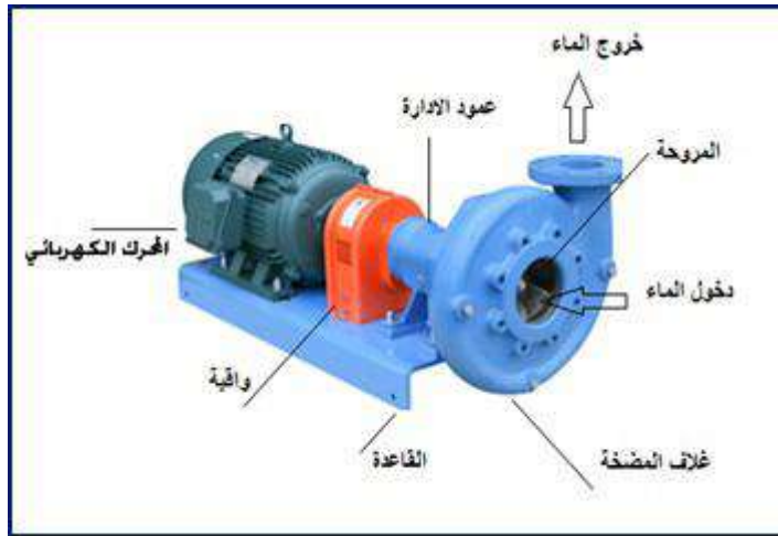
شكل 6-14 أجزاء المضخة الطاردة المركزية
