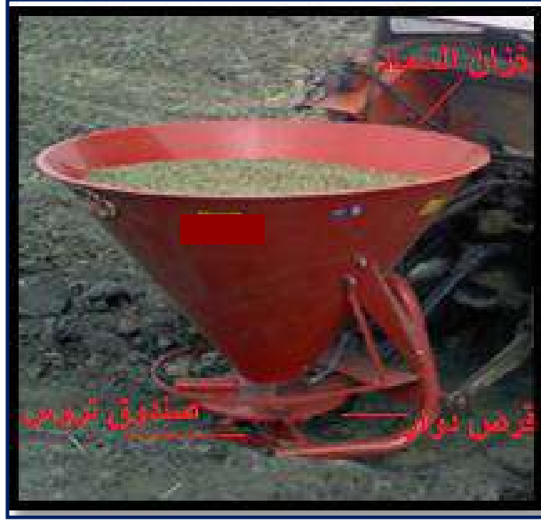
شكل 5-34 أجزاء ناثرة السماد الكيميائي ذات القرص الدوار
