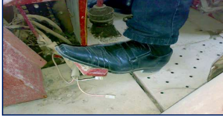
شكل 3-5 الضغط على دواسة الفاصل بواسطة القدم اليسرى
