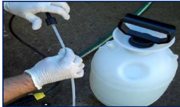
شكل 7-10 سحب أنبوبة خروج السائل إلى رأس المرشة
