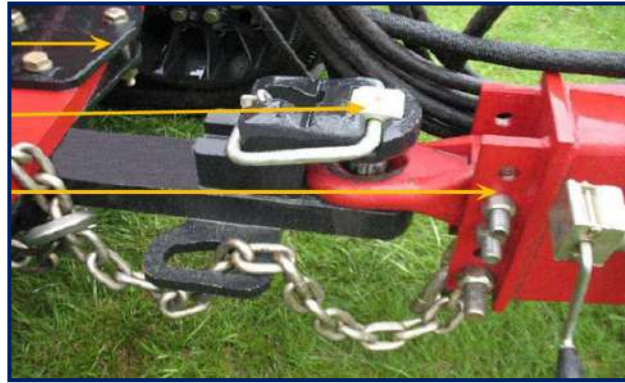
شكل 2-3 التأكد من ربط الآلات الزراعية بالجرّار
