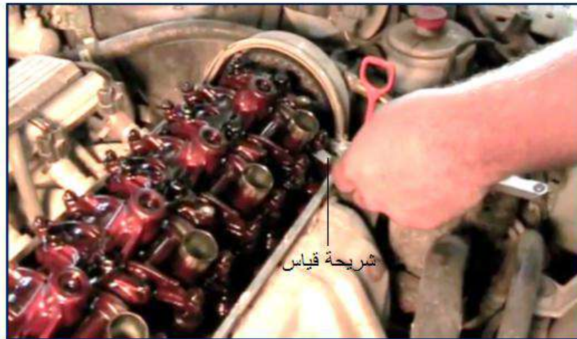
شكل 1-32 قياس خلوص صمام السحب باستعمال شريحة القياس
