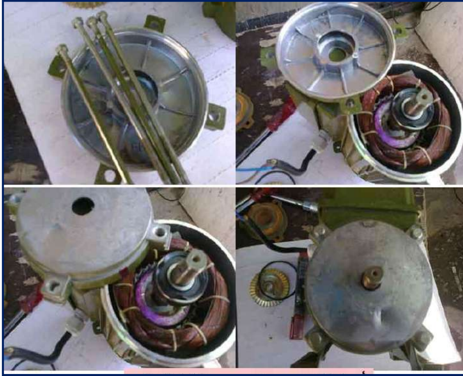
شكل 12-9 فتح براغي الغطاء الخارجي
