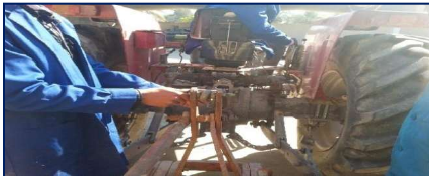
شكل 4-17 ربط الذراع التلسكوبية مع المحراث
