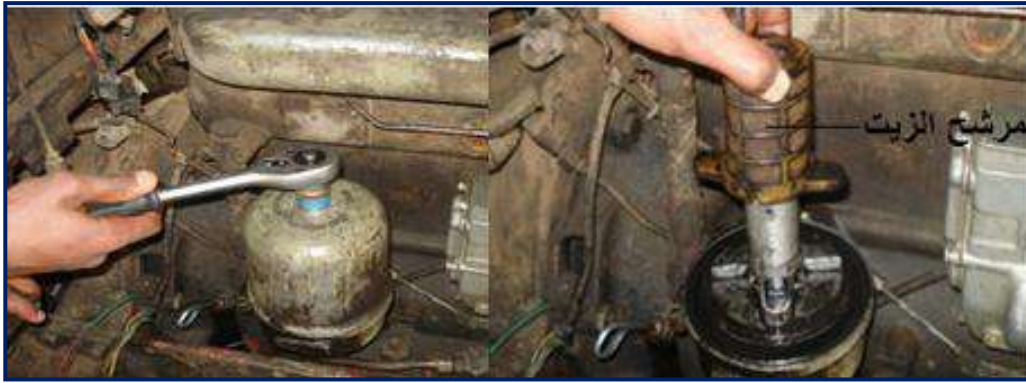
شكل 22-2 طريقة فتح مصفي الزيت
