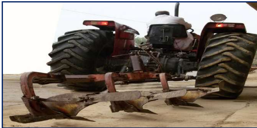
شكل 4-19 المحراث خلف الجرّار بعد إنزال الجرّار على أرض مستوية
