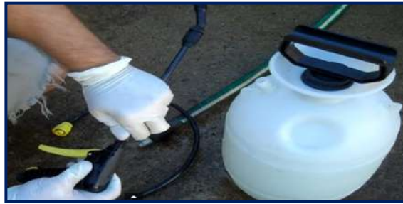
شكل 7-11 فصل صامولة رأس المرشحة
