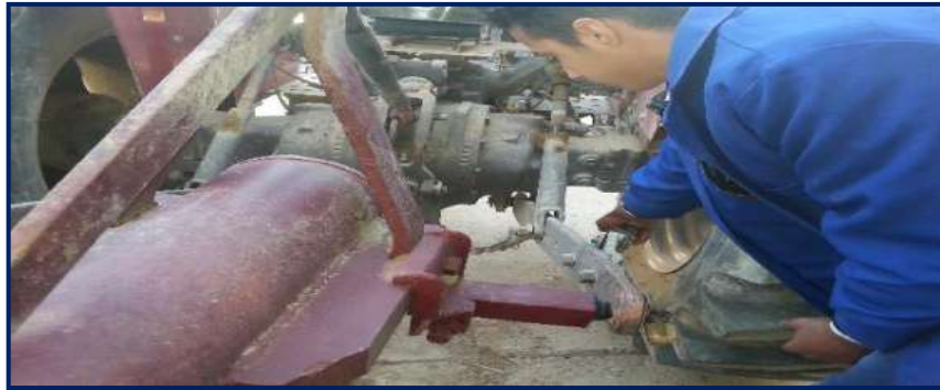
شكل 4-25 أرخاء اذرع الربط السفلية
