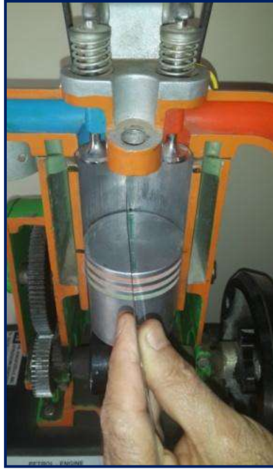
شكل 26-1 حساب قطر الاسطوانة
