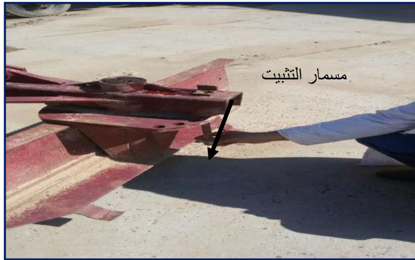
شكل 37-4 تثبيت زاوية الميل بوساطة المسمار الخاص
