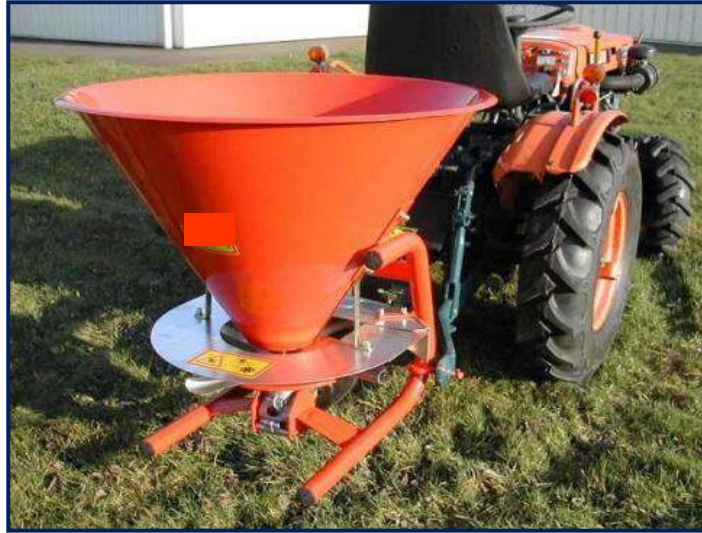
شكل 5-33 آلة نثر السماد الكيميائي بالطرد المركزي
