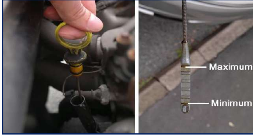
شكل 24-2 طريقة فحص مستوى الزيت
