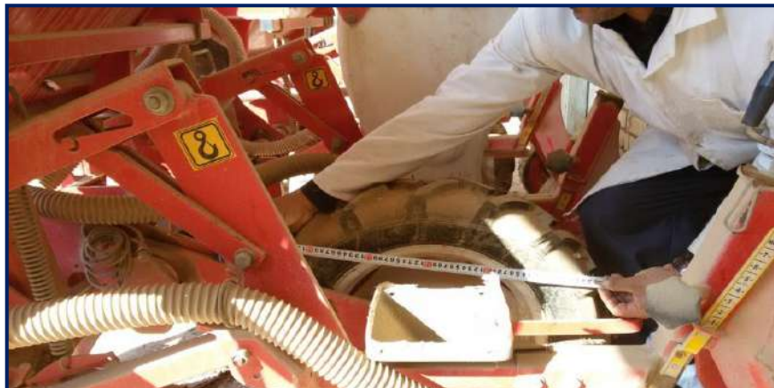
شكل 5-18 قياس قطر العجلة
