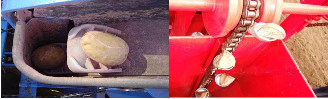
شكل 24-5 جهاز تلقيم الدرنات ذو الاكواب
