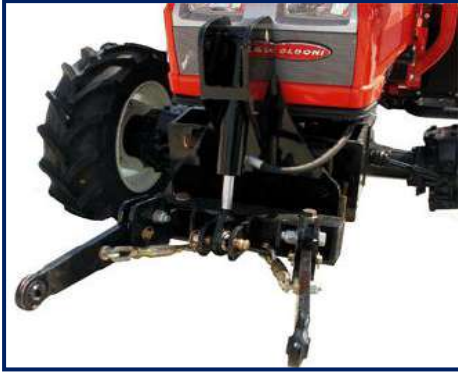
شكل 9-3 منظومة الرفع الهيدروليكية خلف الجرّار شكل 10-3 منظومة الرفع الهيدروليكية في مقدمة الجرّار
