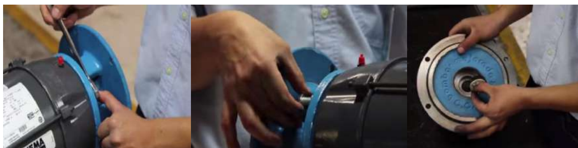
شكل 25-6 فصل بدن ربط البشارة من المحرك
