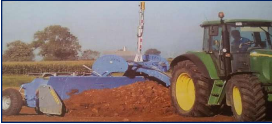
شكل 4-32 عمل آلة التسوية المربوطة بالجرار الزراعي
