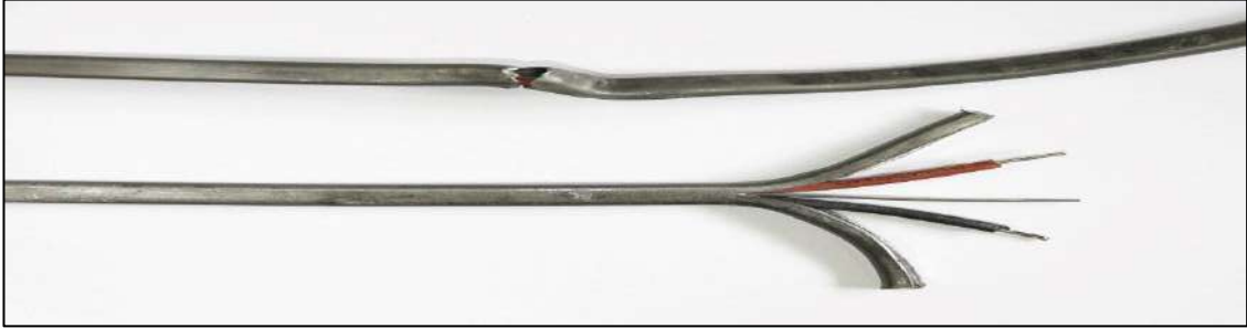
الشكل (5-1) تلف الموصل الكهربائي الناجم عن الحرارة
