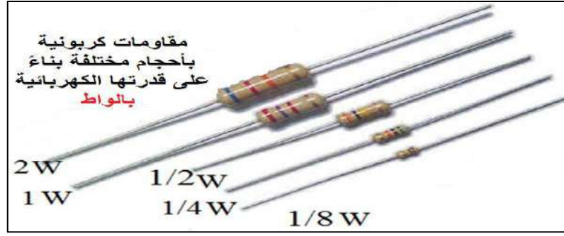
شكل (71-2) مقدار القدرة في المقاومات مختلفة الحجم
