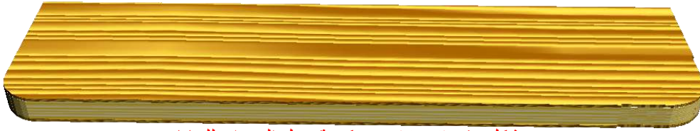
شكل رقم (4 - 6) يبين كيفية عمل الدوران للحافات
