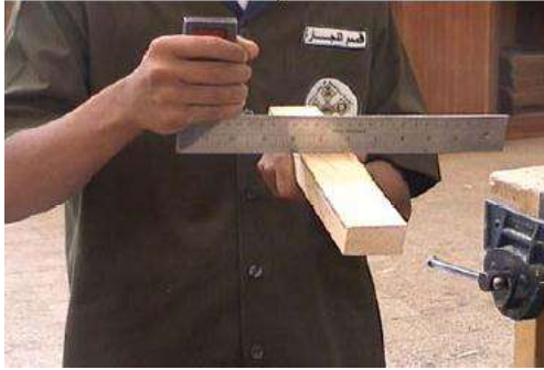
شكل (2-70) يبين كيفية ضبط استواء الأسطح بالزاوية
