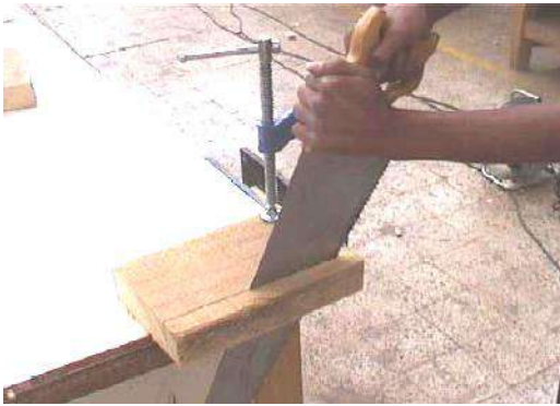
شكل رقم (2 - 37) يوضح طريقة نشر قطعة خشب
