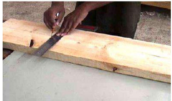
شكل (2 - 43) يبين كيفية تحديد القياس بواسطة الزاوية
