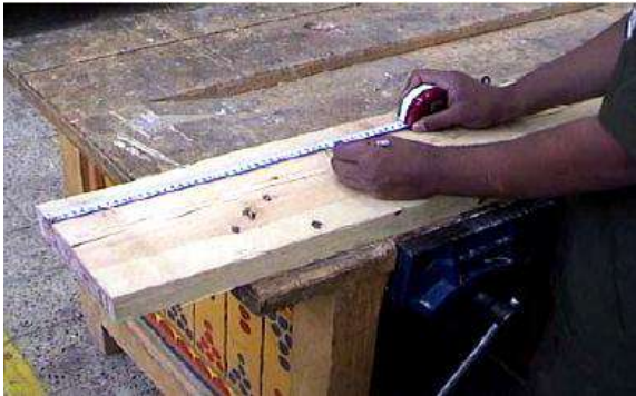
شكل (2 - 42) يبين كيفية أخذ القياس بواسطة المتر المعدني
