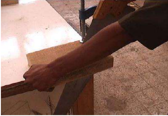
شكل (2 - 51) يبين كيفية مسك القطعة عند وصول الشق إلى النهاية
