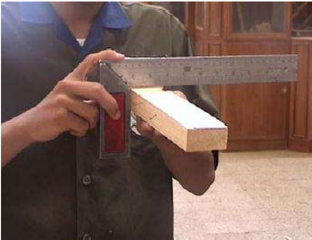
شكل رقم (2- 75) يبين كيفية ضبط دقة تعامد الوجه والحافة
