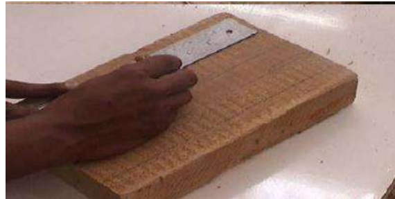
شكل (2 - 48) يبين كيفية تأشير قطعة الخشب بواسطة الزاوية القائمة
