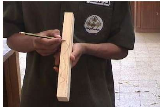
شكل رقم (2- 74) يبين كيفية تأشير الحافة بالقلم
