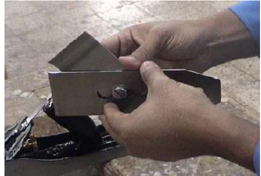
شكل رقم (2- 62) يبين كيفية تركيب سلاح الرنـدة
