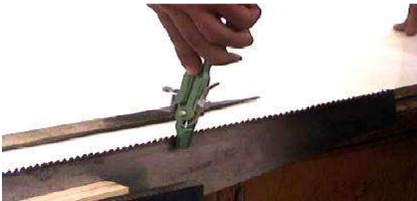
شكل رقم (2 - 40) يبين كيفية تقليم أسنان المنشار
