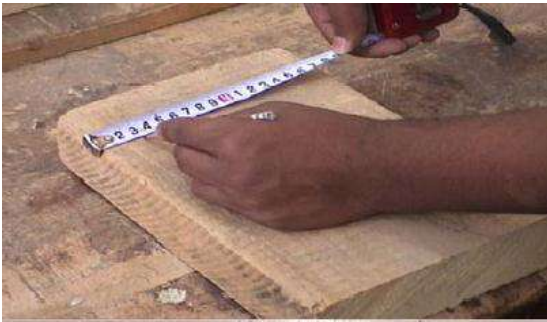
شكل (2 - 47) يبين كيفية تأشير قطعة الخشب بواسطة قلم الرصاص
