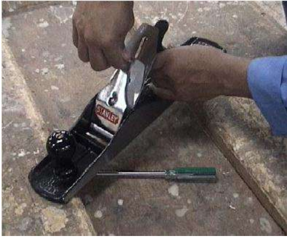
شكل رقم (2- 61) يبين كيفية تفكيك سلاح الرنـدة
