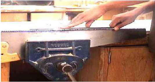
شكل رقم (2 - 39) يبين كيفية ربط المنشار بالمنكنة
