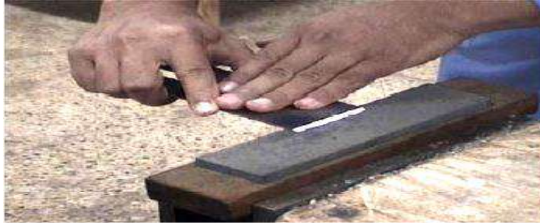
شكل رقم (2- 66) يبين كيفية إزالة بقايا البرادة
