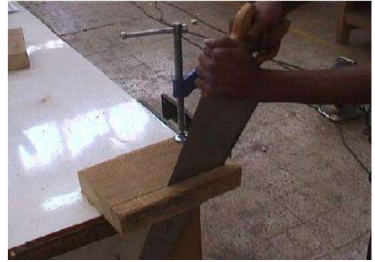
شكل رقم (2 - 50) يوضح طريقة تصحيح مسار المنشار
