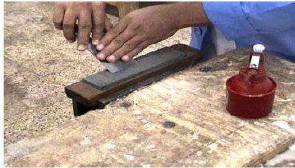
شكل رقم (2- 64) يبين كيفية ملامسة حافة السلاح للحجر
