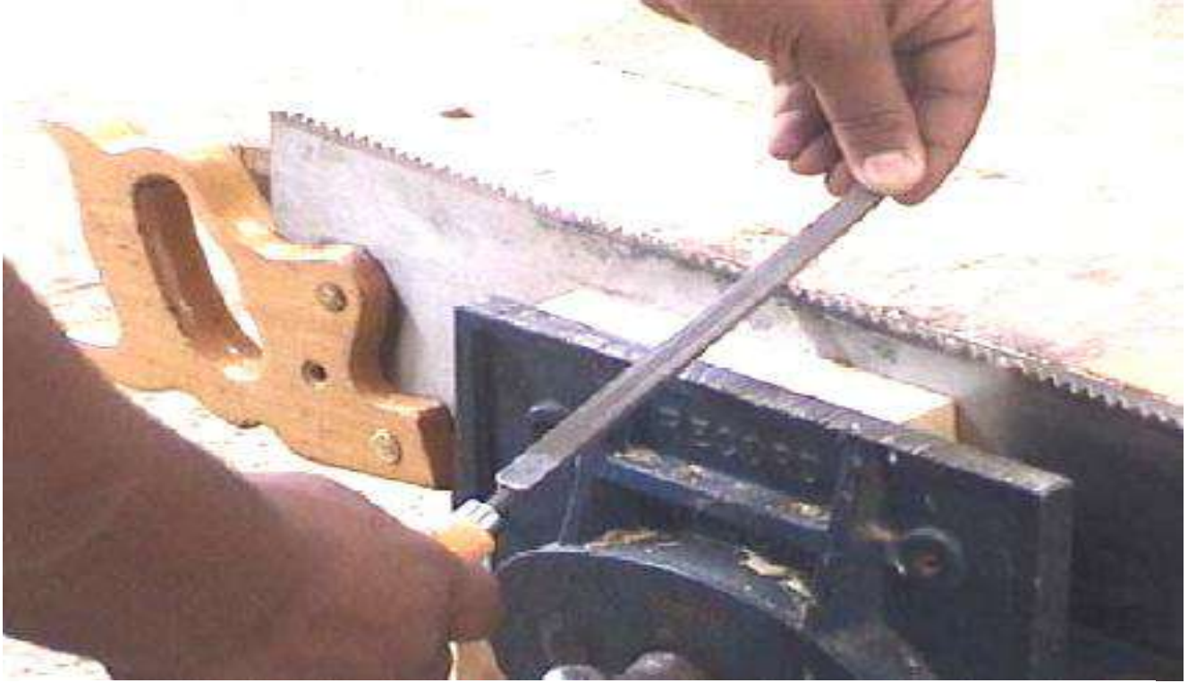
شكل رقم (2 - 41) يبين كيفية سن المنشار بواسطة المبرد المثلاث
