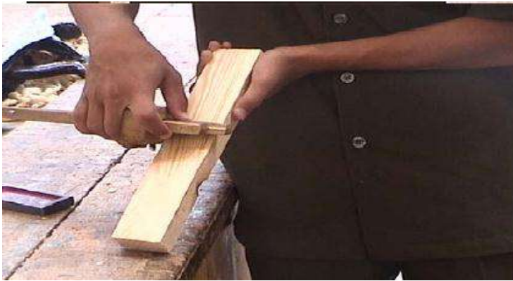
شكل رقم (2- 77) يبين كيفية ضبط العرض بواسطة الخطاط
