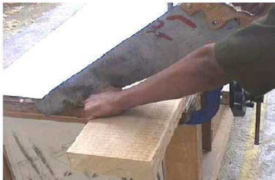
شكل (2 - 44) يبين كيفية قطع اللوح بمنشار القطع العرضي
