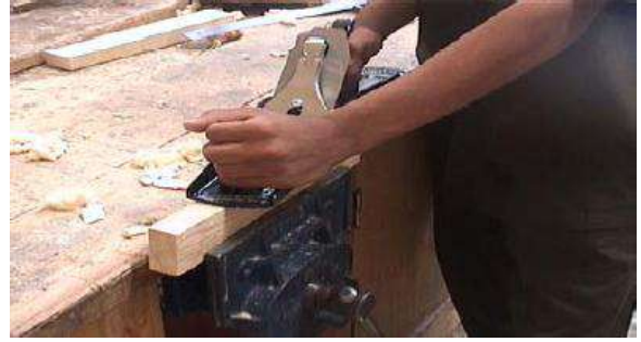
شكل رقم (2- 72) يبين كيفية تثبيت القطعة ومسح حافتها
