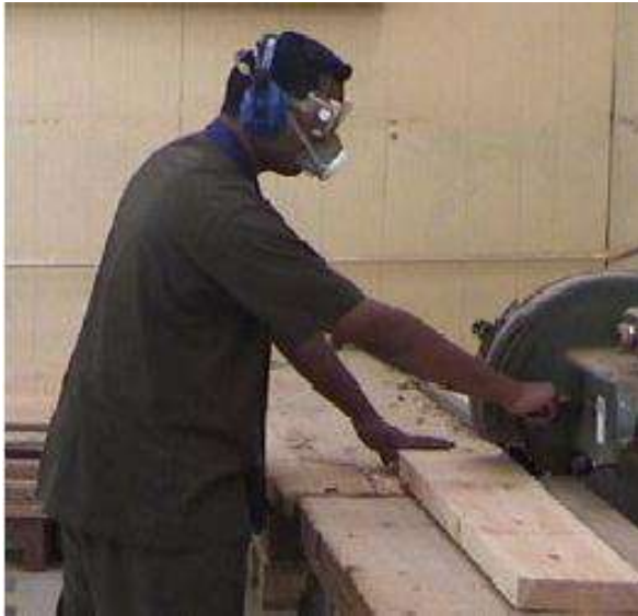
شكل رقم (1 - 7) يبين وضع الكمامات وواقيات الأذنين
