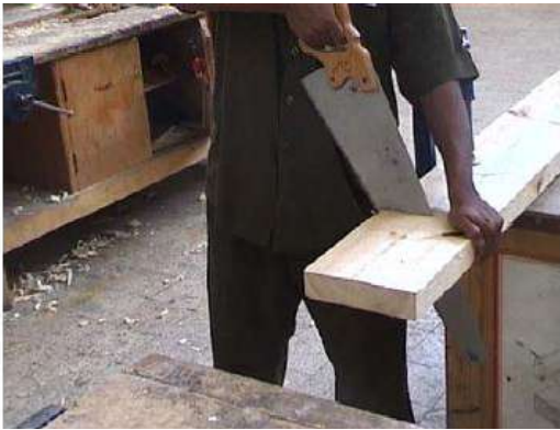
شكل رقم (2 - 46) يبين كيفية مسك قطعة الخشب المنشورة
