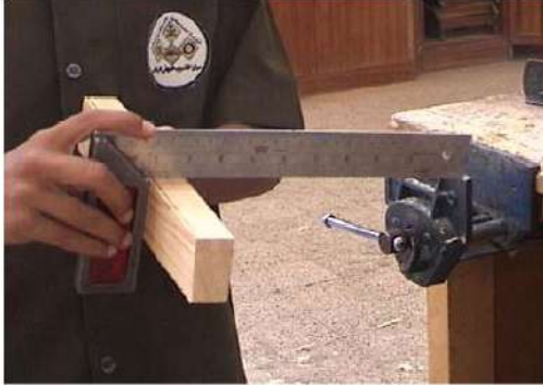
شكل (2- 73) يبين كيفية ضبط حافة القطعة بالزاوية
