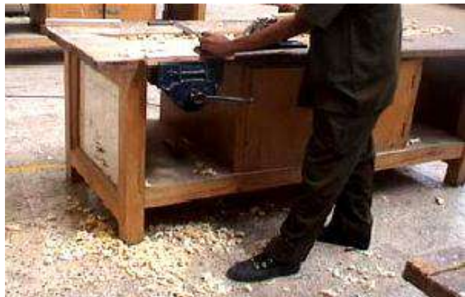
شكل رقم (2- 69) يبين كيفية مسك الرندة عند بدأ المسح
