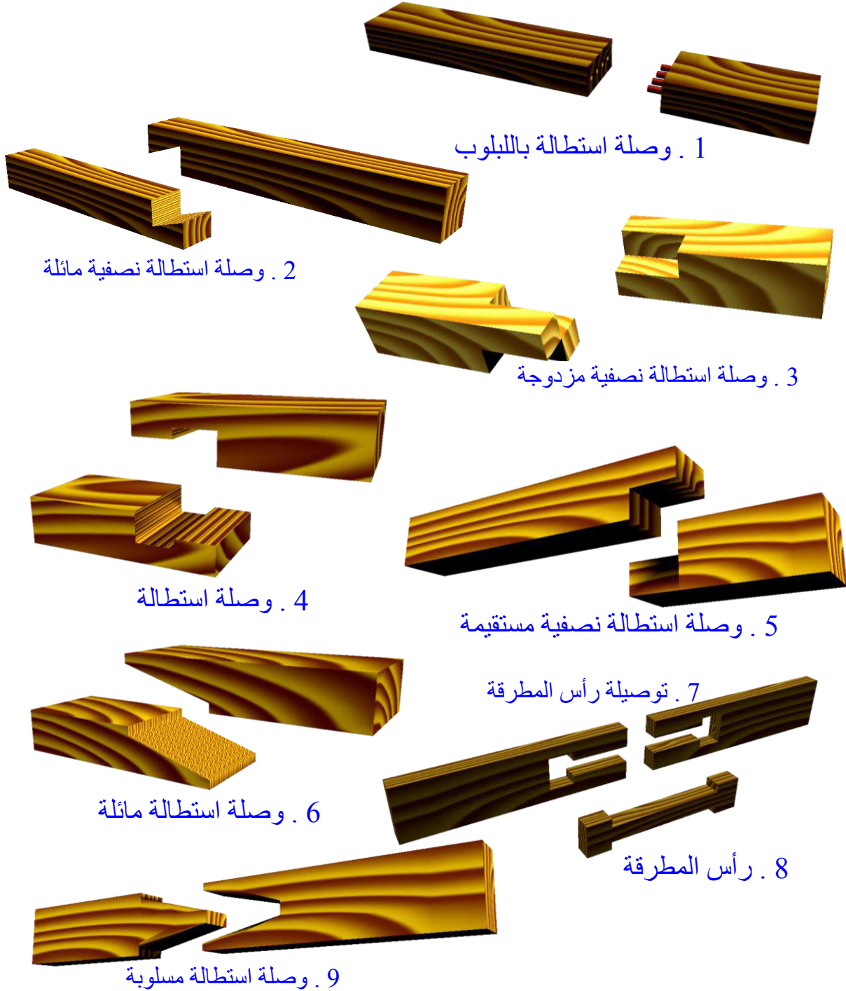
شكل (3 - 6) أهم أنواع وصلات الاستطالة
