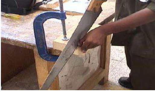
شكل (2 - 49) يبين كيفية تثبيت القطعة وطريقة الشق الطولي
