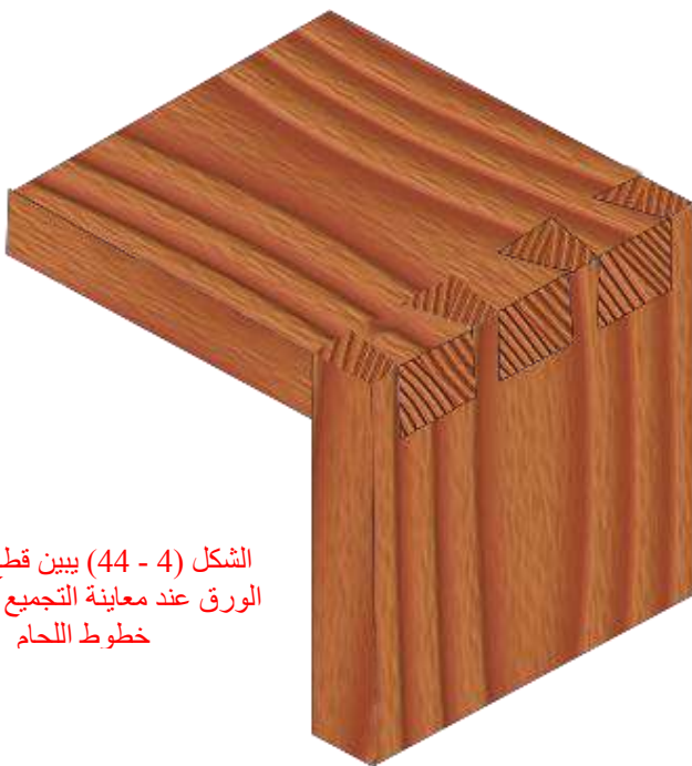
الشكل (4 - 43) يبين تشبيقة ذيل الحمام التي تربط بين جنب وظهر الحافظة
