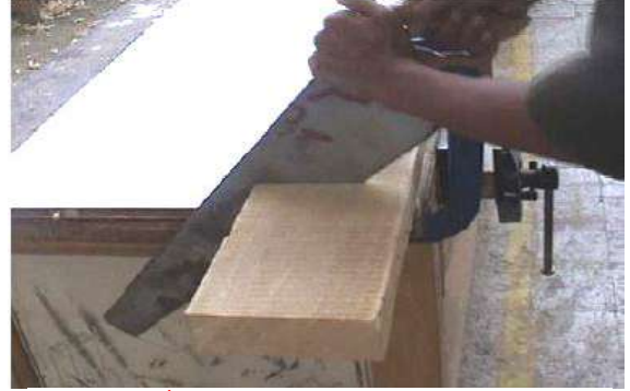
شكل رقم (2 - 45) يبين كيفية ميلان رأس المنشار
