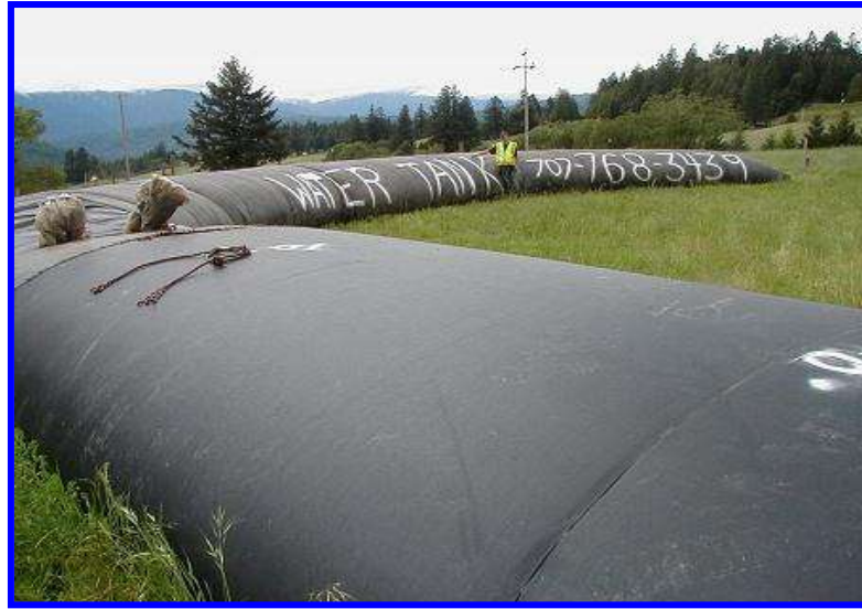
شكل 61. خزان مرن سعة 100م 3 يعتبر وسيلة فعالة لخزن المياه واستخدامها عند الحاجة.
