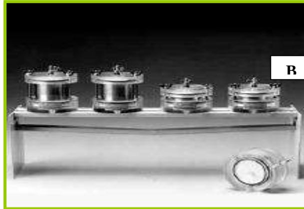
شكل 70: أجهزة استخلاص منحنى مواصفات رطوبة التربة: A - قدر استخلاص الضغط يظهر في داخله قرص استخلاص ، B - خلايا ضغط
