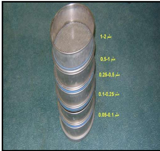
شكل 15. سلسلة مناخل نحاسية متدرجة الأقطار (الأعلى) و نسق من المناخل البرونزية تستخدم لفصل الرمل بطريقة النخل الرطب (الأسفل).
