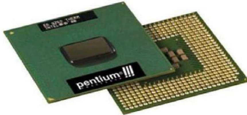
الشكل 3-6 المظهر الخارجي لأحد أنواع المعالج الدقيق بنتيوم III
