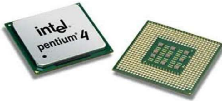
الشكل 4-6 المظهر الخارجي لأحد أنواع المعالج الدقيق بنتيوم 4
