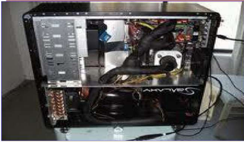
شكل 2-16 تبريد المعالج باستعمال الضاغطات Compressors
