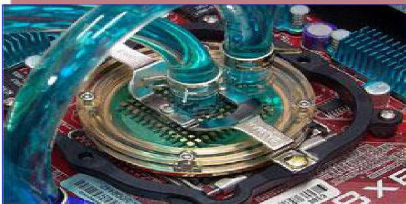
شكل 2-14 تبريد المعالج بالماء
