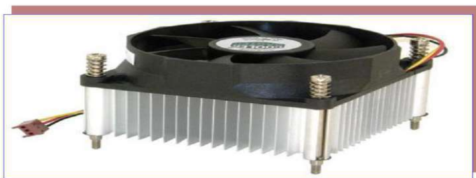
شكل 12-2 المبرد الحراري ملحق بمروحة تبريد
