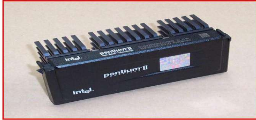
الشكل 2-6 المظهر الخارجي لأحد أنواع المعالج الدقيق بنتيوم II
