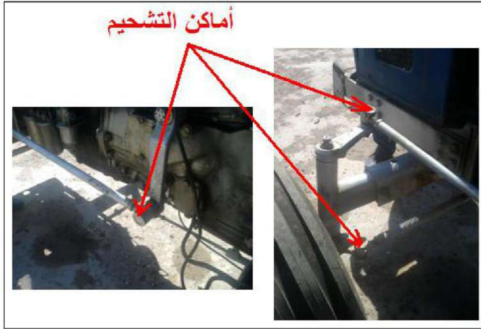
الشكل 3-4 الأماكن المطلوب تشحيمها في الساحة الزراعية.
