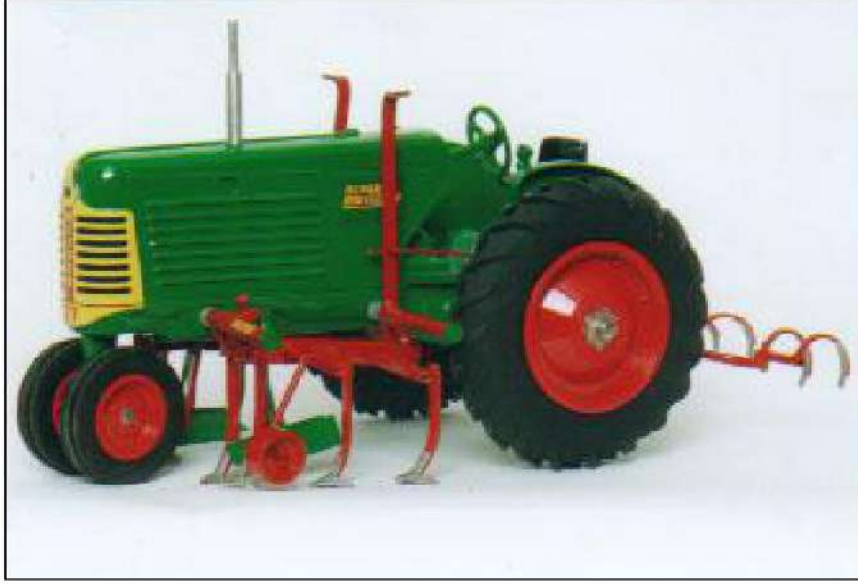
الشكل 2-13 هيكل تعليق المعدات الوسطي لآلة العزق.
