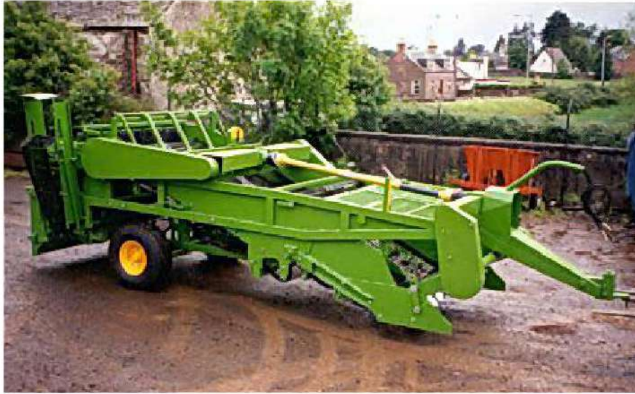
الشكل 21-2 قالعة نصف معلقة ذات السلسلة الناقلة.
