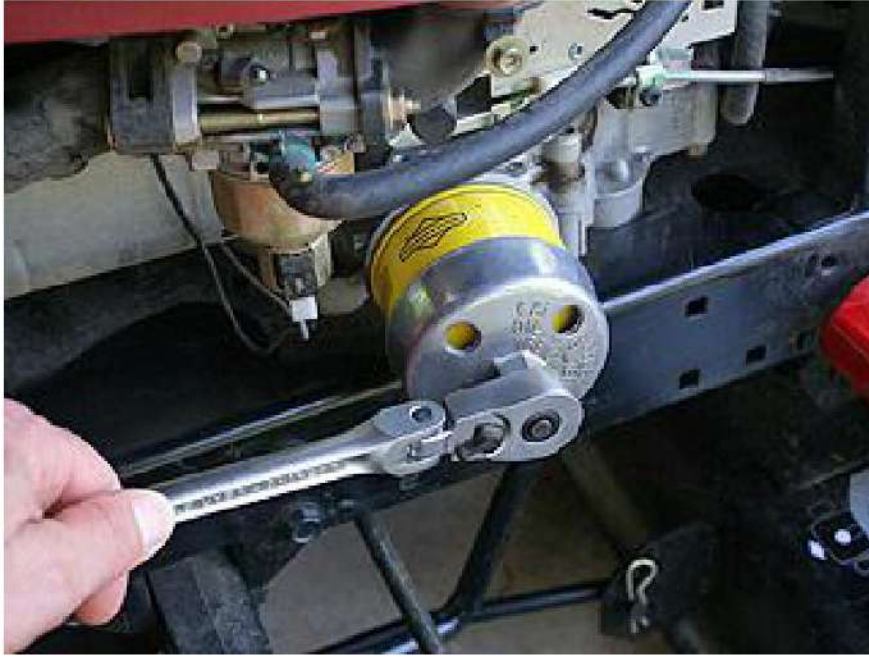
الشكل 5-2 تبديل منقية الزيت للساحة الزراعية.
