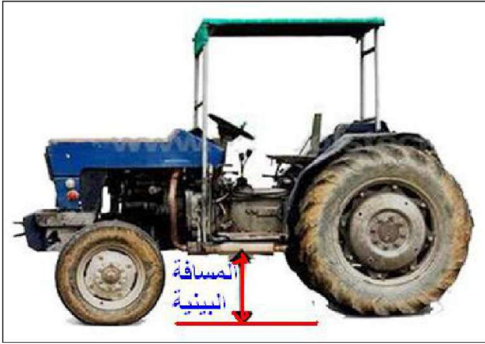
الشكل 11-1 المسافة البينية (Clearance) بين السطح السفلي للساحبة وسطح التربة.
