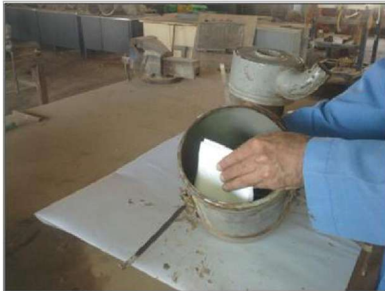
الشكل 3-12 تنظيف حوض منقية الهواء ذات الحمام الزيتي.
