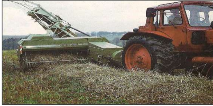
الشكل 1-7 كابسة أعلاف مسحوبة تدار بواسطة عمود الإدارة الخلفي للساحبة.
