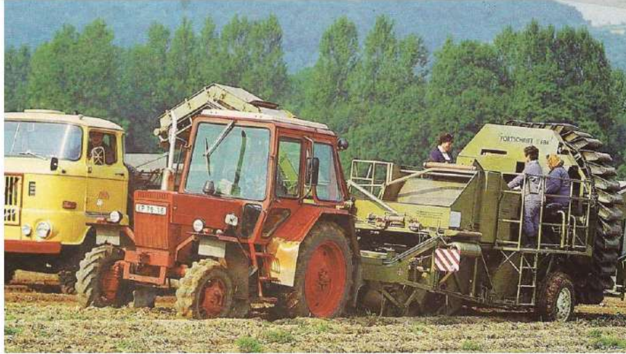
الشكل 1-4 ساحة زراعية تسحب وتدير قاعة بطاطا بواسطة عمود الإدارة الخلفي للساحة.
