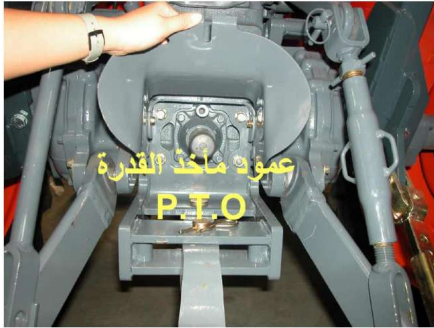
الشكل 11-4 عمود مأخذ القدرة الذي يدار بواسطة عتلات القيادة.
