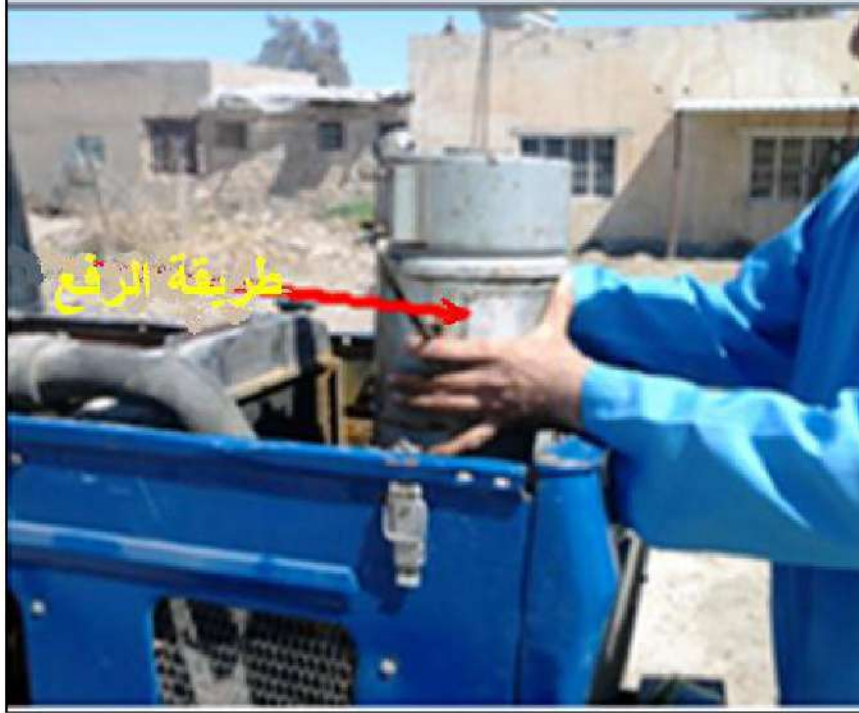
الشكل 10-3 طريقة فصل منقية الهواء عن الساحبة.
