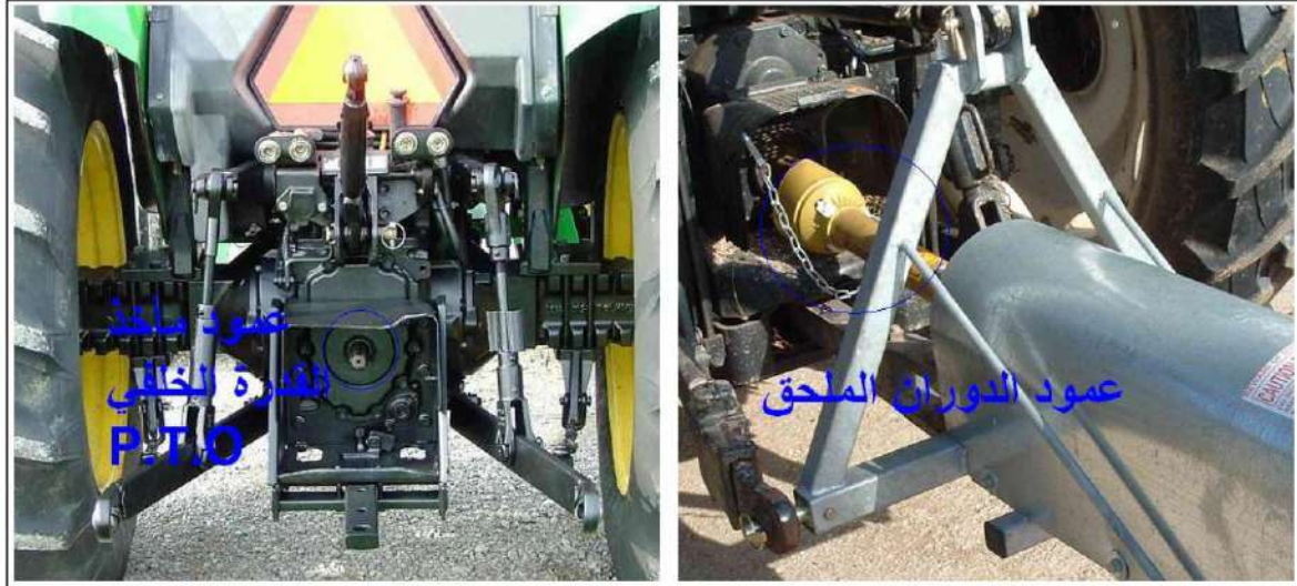
الشكل 4-12 تركيب عمود الدوران الملحق في عمود مأخذ القدرة الخلفي.
