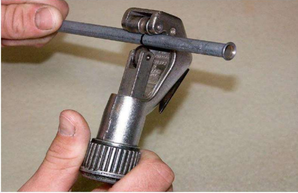
الشكل 8-23 : قطع أنبوب الزيت عن طريق قاطعة الأنابيب
