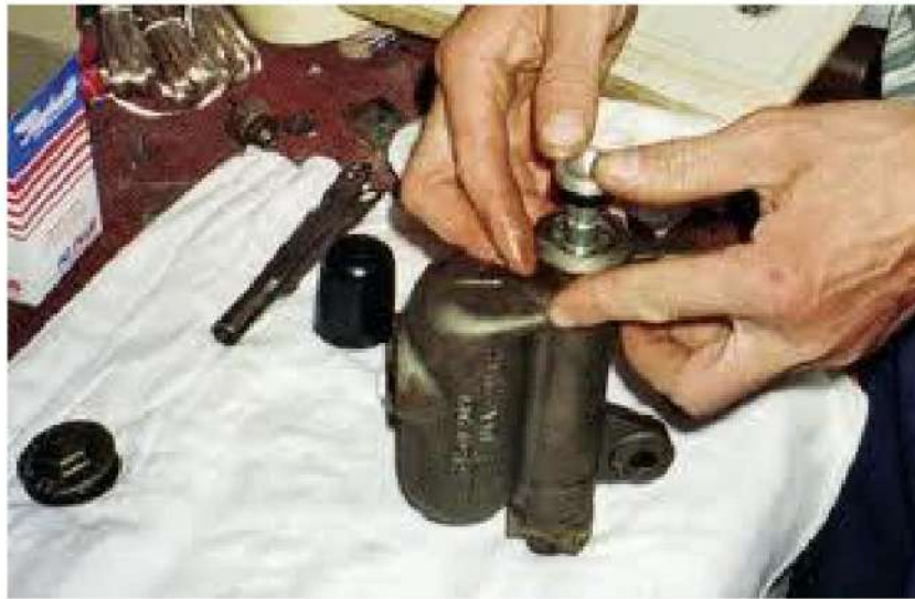
الشكل 8-16 إعادة تجميع الأجزاء الداخلية للأسطوانة.
