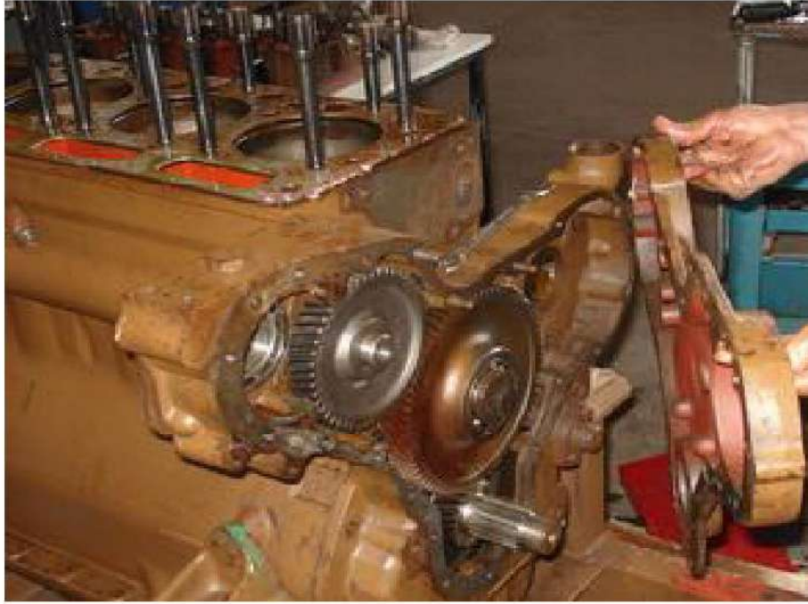
الشكل 17-1 رفع الأحزمة وغطاء المسننات
