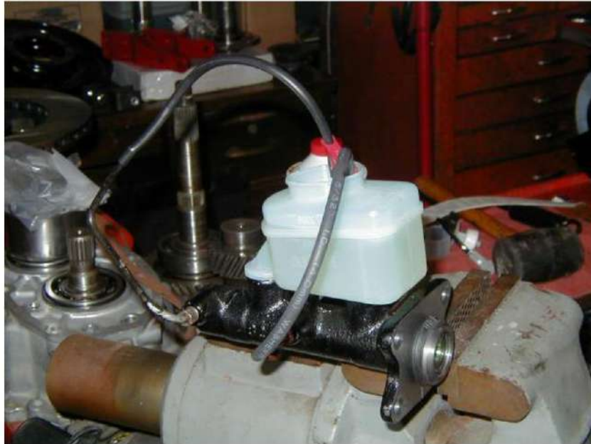
الشكل 8-18 ملء الخزان بالزيت.
