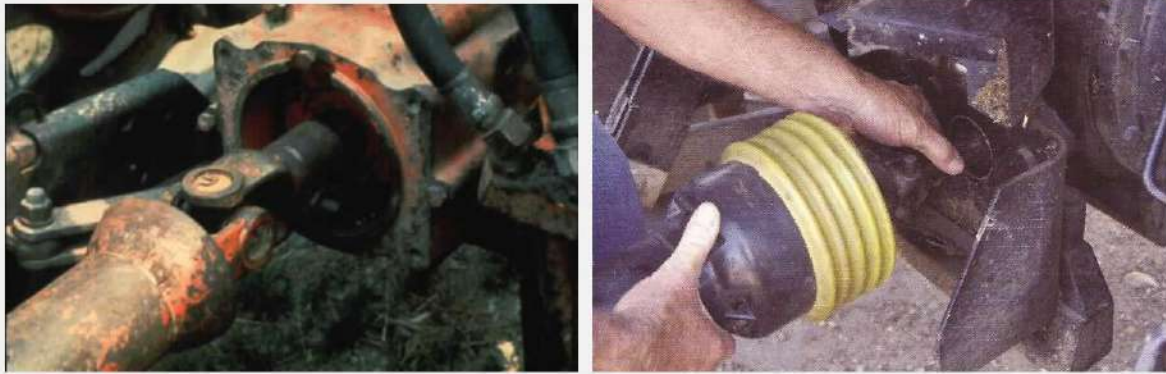
الشكل 20-7 : طريقة ربط القارنات بين عمود مأخذ القدرة وعمود الدوران.
