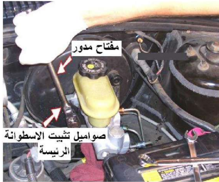
الشكل 8-9 تحرير الأسطوانة الرئيسية من صواميل التثبيت.
