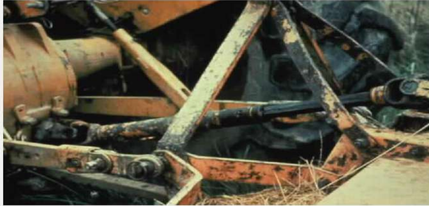
الشكل 22-7 : الطريقة غير السليمة وغير الآمنة في الربط.
