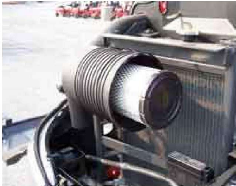
الشكل 2-23 منظفة الهواء الجافة.
