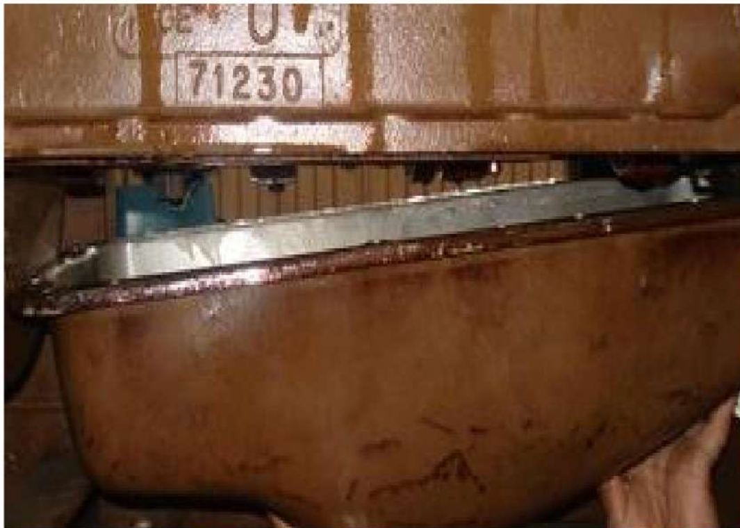
الشكل 20-1 : تفرغ الزيت وفتح غطاء خزان الزيت لغرض مشاهدة عمود المرفق.
