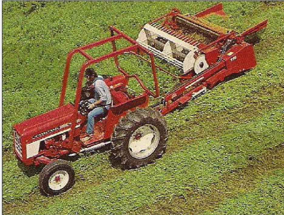
الشكل 26-7 ساحة زراعية ذات عمود سحب متحرك تسحب محشة قطع الأعلاف الخضراء عن طريق عمود مأخذ القدرة.
