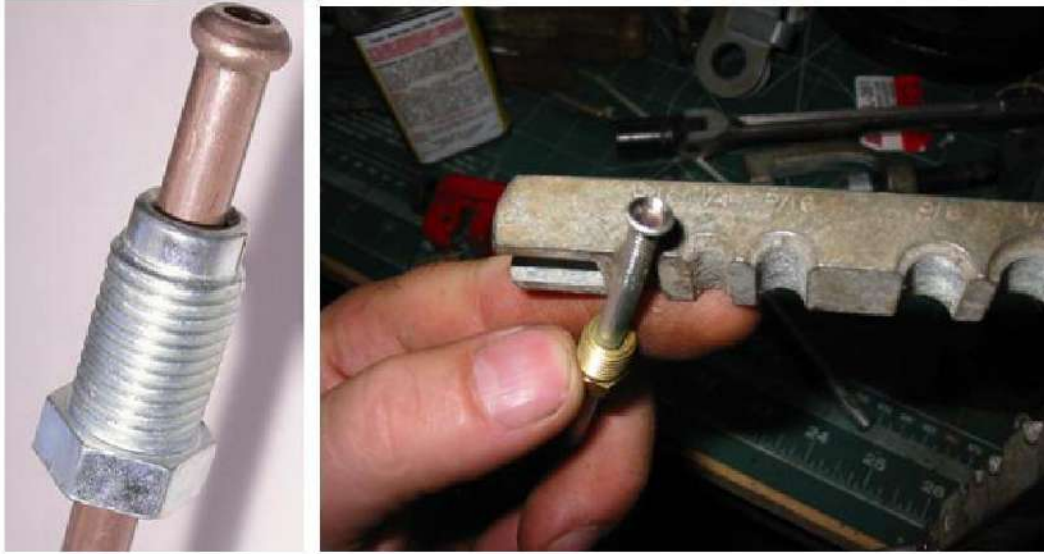
الشكل 29-8 فتح الأنبوب والتأكد من عملية التشكيل.
