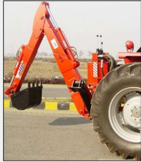
الشكل 2-7 فعل الجهاز الهيدروليكي في خلف الساحبة الزراعية ومقدمتها.
