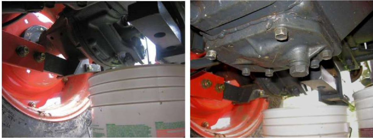
الشكل 4-15 : تفريغ زيت صندوق السرعات في حاوية الزيت
