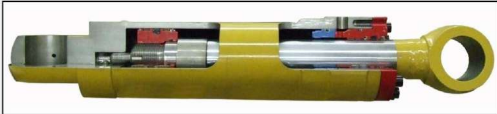
الشكل 11-7 مقطع في أسطوانة هيدروليكية أحادية الفعل.
