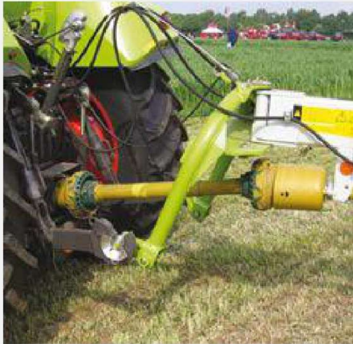
الشكل 21-7 : طريقة ربط عمود الإدارة والأغلفة الواقية.
