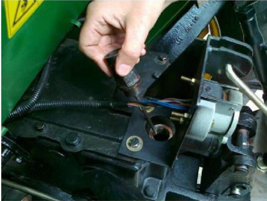
الشكل 4-11 فحص مستوى الزيت في صندوق السرعات
