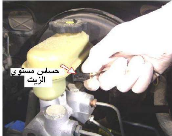
الشكل 7-8 فصل حساس مستوى الزيت.
