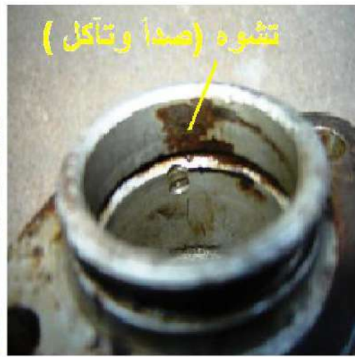
الشكل 8-13 ملاحظة أي تشوه في سطح الأسطوانة الداخلي.
