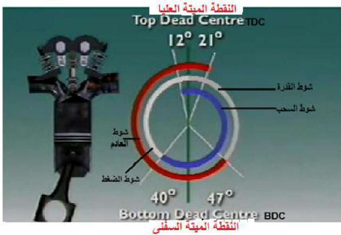
الشكل 1-31: مخطط توقيت الصمامات.
