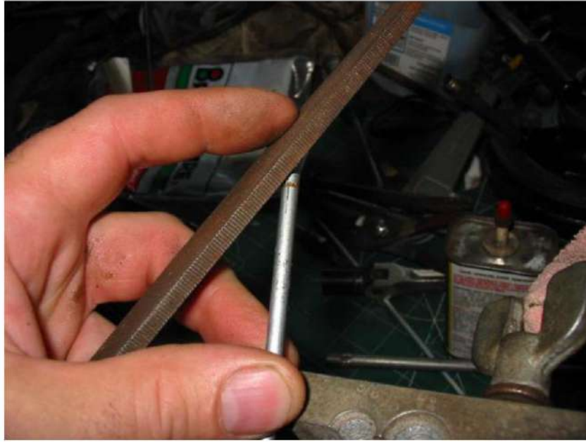
الشكل 8-25 برادة الطرف المقطوع
