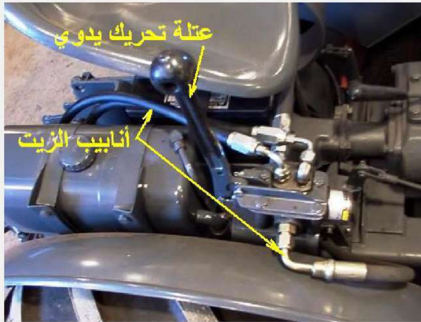
الشكل 7-10 صمام السيطرة الموجه للزيت
