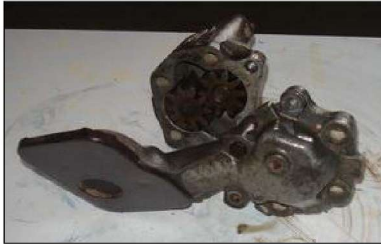
الشكل 2-12 فتح مضخة الزيت.
