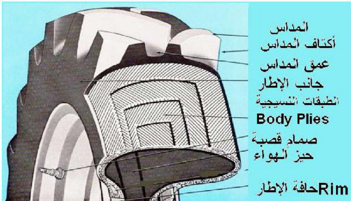
الشكل 6-6 مقطع في الإطار القاند للساحبة الزراعية
