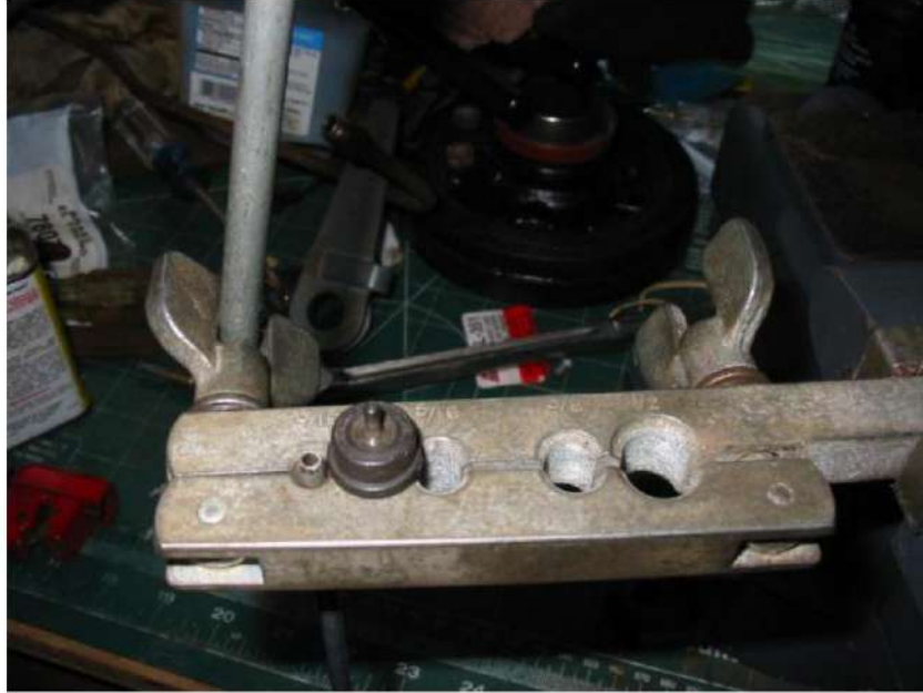
الشكل 27-8 : ربط الأنبوب في الماسك
