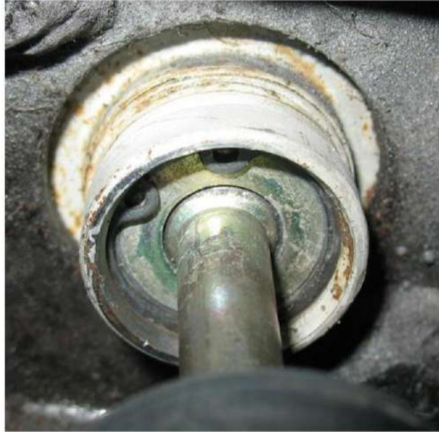
الشكل 8-17 تثبيت حلقة الحصر لمنع خروج المكابس.
