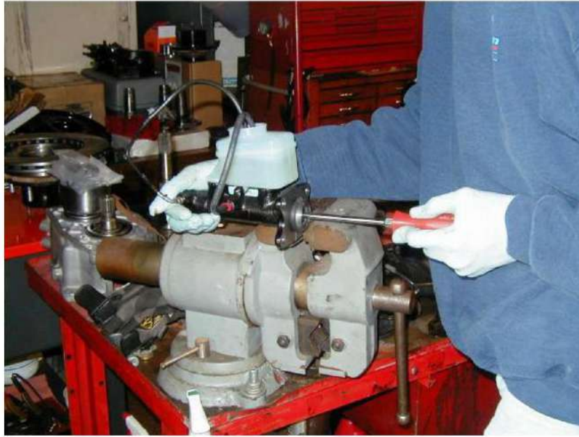
الشكل 8-19 إخراج الهواء من الأسطوانة الرئيسية.
