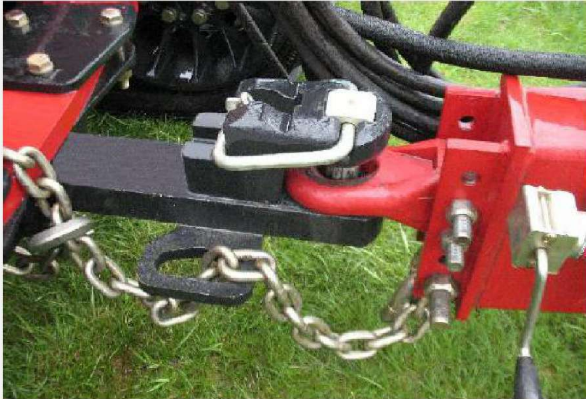
الشكل 27-7 السحب عن طريق عتلة السحب الثابتة.
