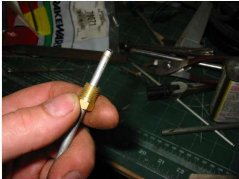
الشكل 8-26 إدخال صامولة التثبيت
