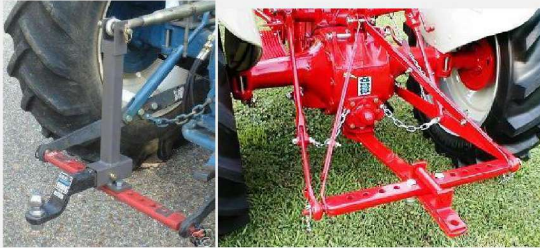
الشكل 25-7 عمود السحب المتحرك
