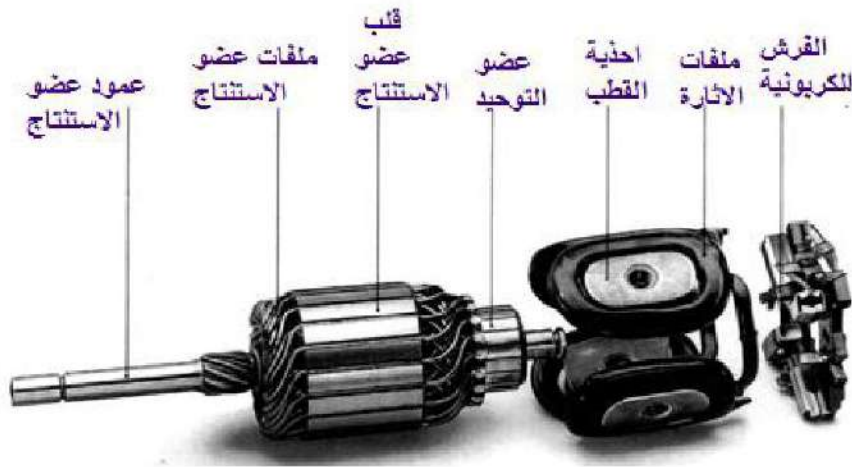
الشكل 2-30 الأجزاء الرئيسية لمحرك بدء الإدارة الكهربائي
