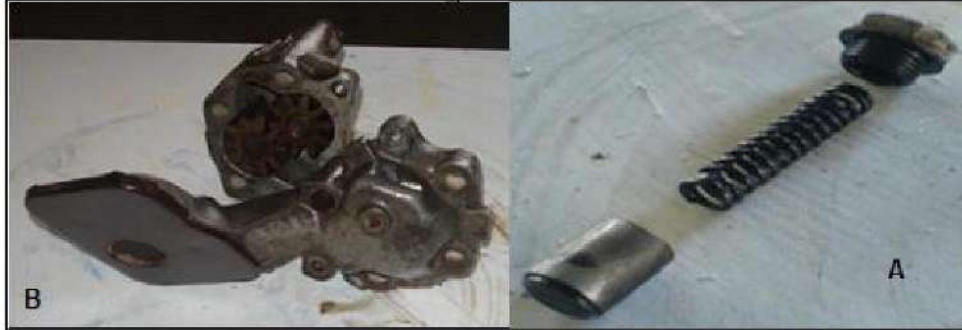
الشكل 2-15 A تفكيك صمام الأمان في مضخة الزيت. B تفكيك مضخة الزيت
