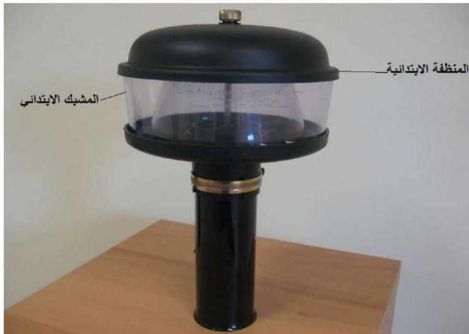
الشكل 2-21 منقية الهواء الابتدائية.
