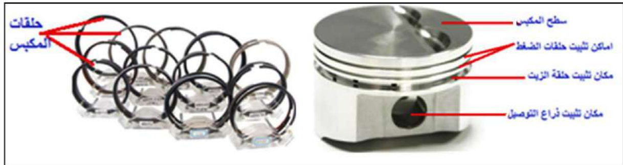
الشكل 11-1 المكبس وحلقات المكبس
