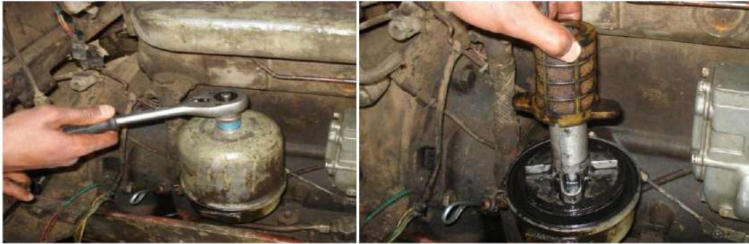
الشكل 2-10 طريقة فتح مصفي الزيت
