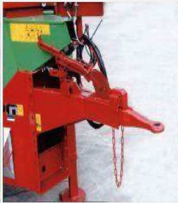
الشكل 7-28 توسيط الساحبة لربط الحمل نحو خط مركز المحور
