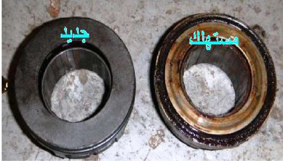
الشكل 13-3 كرسي كريات الفاصل وتمييز القطعة المستهلكة.
