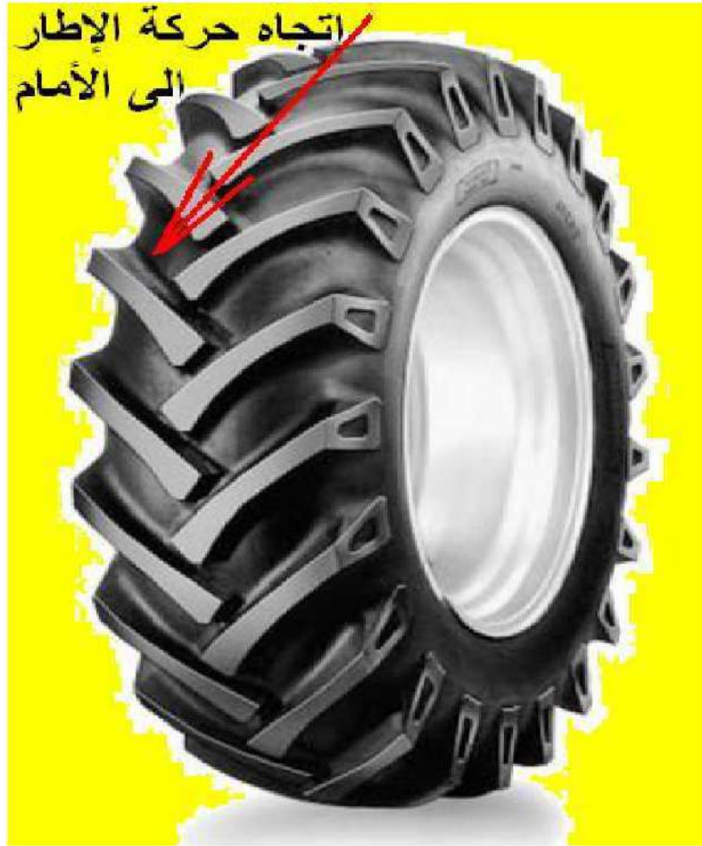
الشكل 6-9 اتجاه أخاديد إطار السحب
