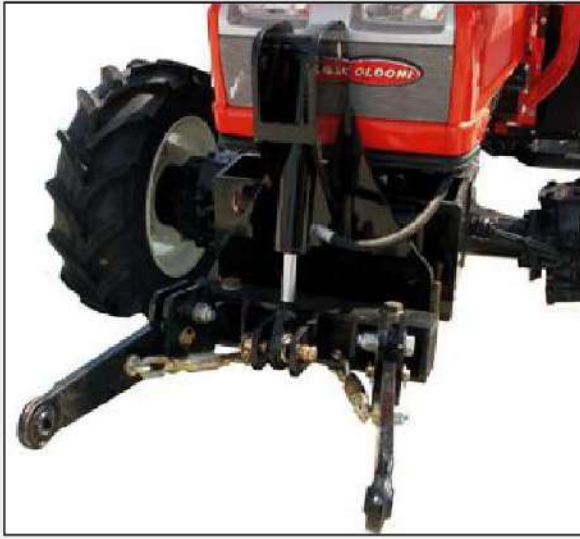
الشكل 2-7 فعل الجهاز الهيدروليكي في خلف الساحبة الزراعية ومقدمتها.
