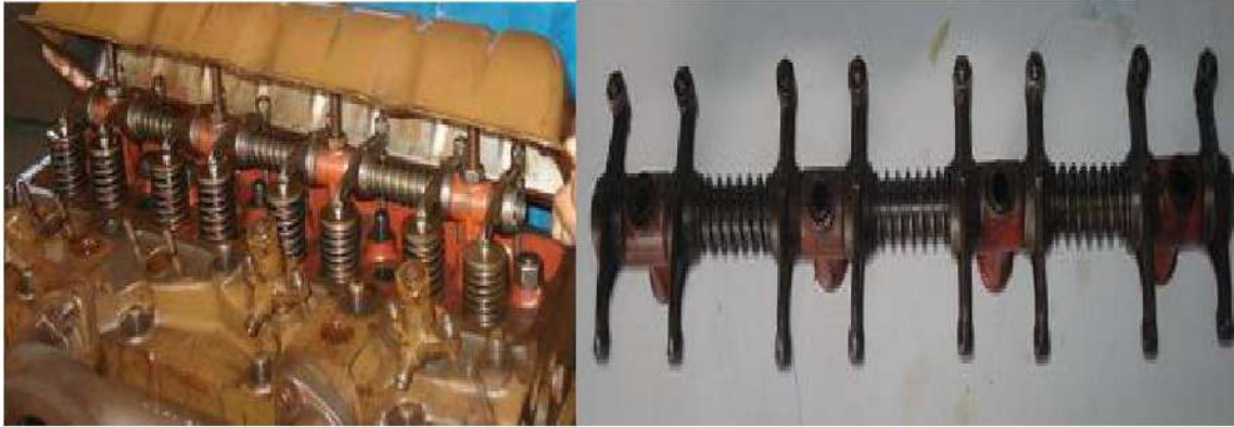
الشكل 18-1 رفع غطاء كتلة رأس الأسطوانات ومجموعة المطارق.
