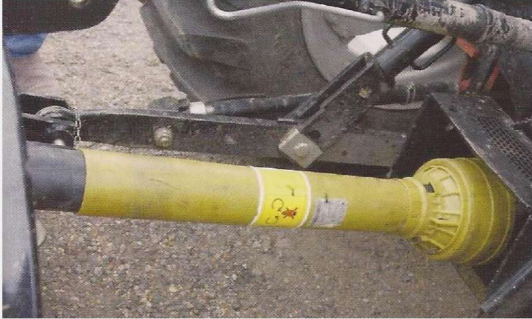
الشكل 17-7 العمود الواصل لحركة عمود مأخذ القدرة من الساحبة إلى الآلة الزراعية.
