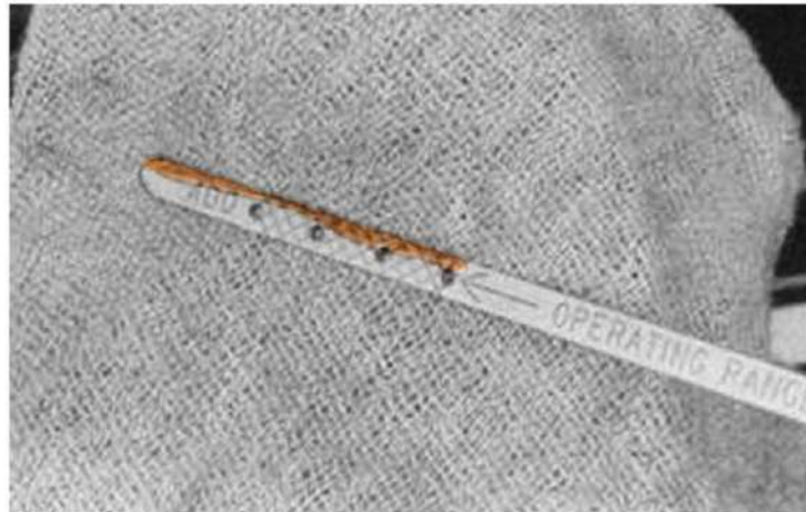
الشكل 4-13 : مسح عصا قياس مستوى زيت صندوق السرعات
