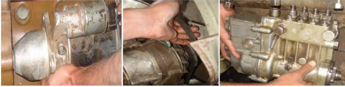
الشكل 19-1 رفع الملحقات عن المحرك.
