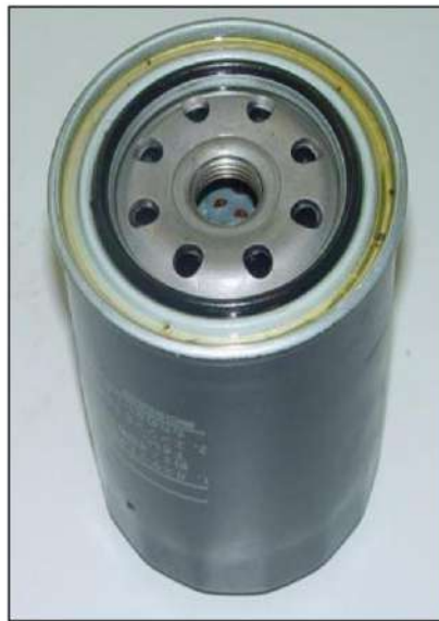
الشكل 14-2 مرشح زيت قابل للتبديل.
