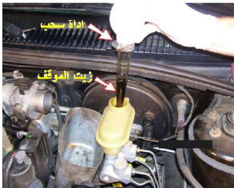
الشكل 6-8 تفريغ الزيت
