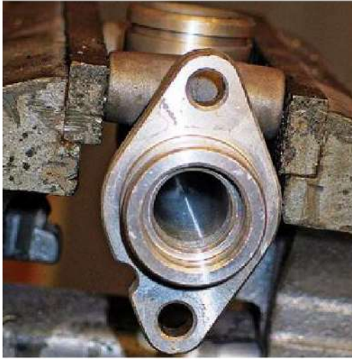
الشكل 8-13 ملاحظة أي تشوه في سطح الأسطوانة الداخلي.
