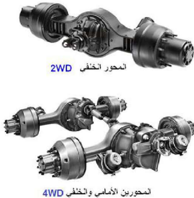
الشكل 1-5 الجهاز التفاضلي مثبت على المحاور
