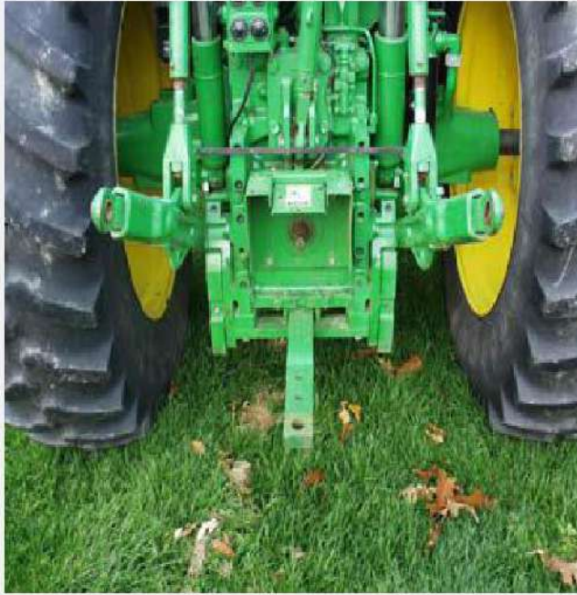
الشكل 7-28 توسيط الساحبة لربط الحمل نحو خط مركز المحور
