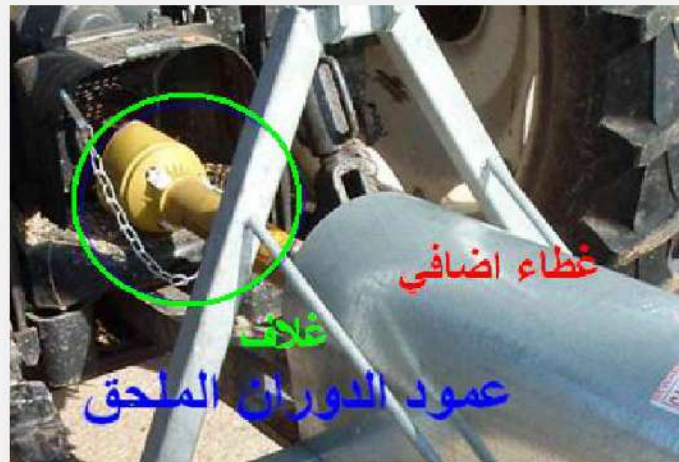
الشكل 7-23 : استعمال أغلفة وقاية إضافية عند ربط الآلات الزراعية مع عمود مأخذ القدرة.
