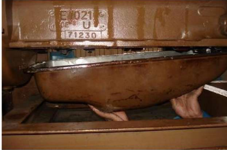
الشكل 2-11 طريقة فتح خزان الزيت.
