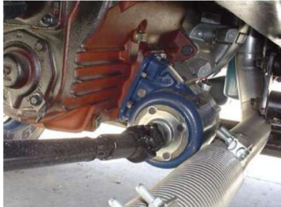
الشكل (2-37) عمود الإدارة الخلفي (P.T. O) بعد اتصاله بالوصلة المرنة
