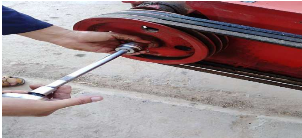
الشكل (4-39) طريقة فحص كراسي تحميل البكرات واستبدالها
