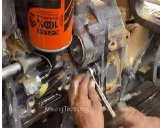
شكل (5-2) تفكيك جزئي للبراعي الخاصة حول الغطاء الفاصل
