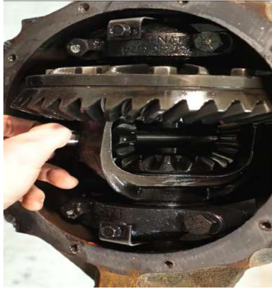
شكل(30-2) فتح الشفتات الجانبين واستخراجها يكون الصندوق التفاضلي
