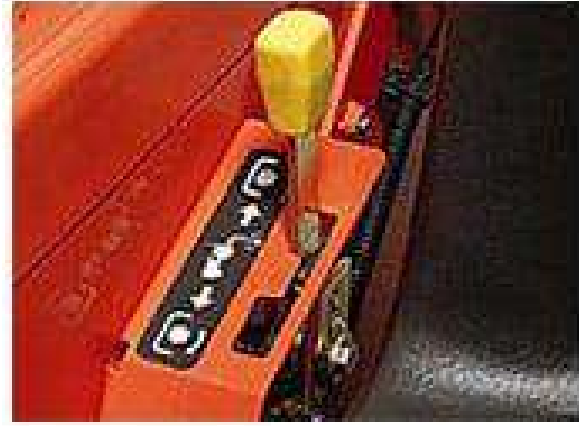
الشكل (48-2) عتلة هيدروليكية الخاصة برفع أو خفض الذراع الهيدروليكي
