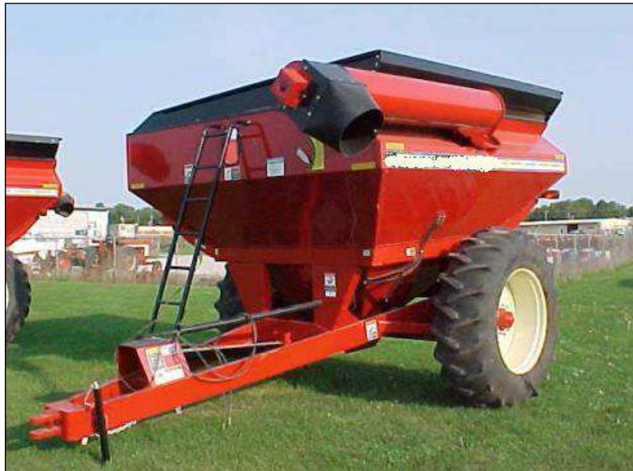
الشكل (5-5) مقطورة زراعية مزودة ببريمة تستعمل لنقل الحبوب.
