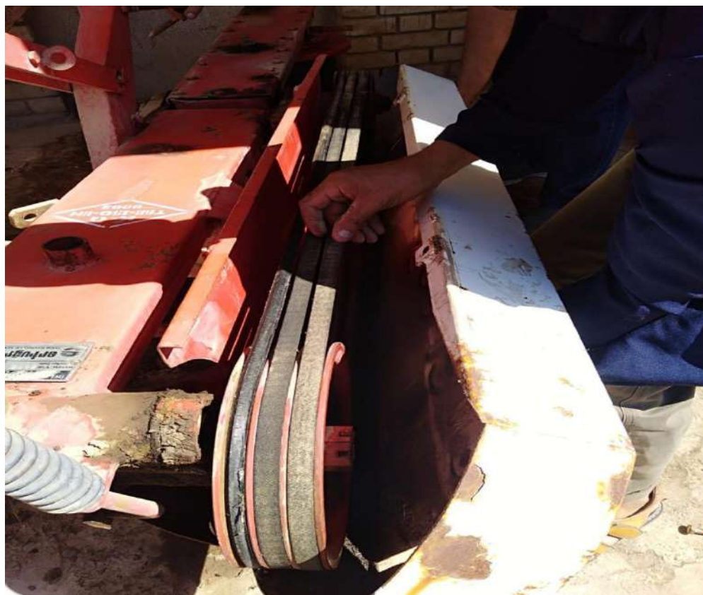
الشكل (4-38) طريقة فحص سيور نقل الحركة واستبدالها
