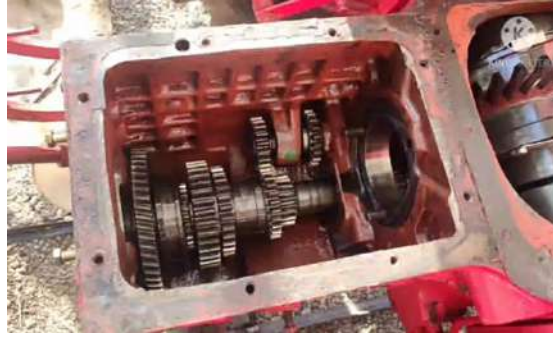
الشكل (21-2) ارجاع الأعمدة التي تحمل التروس
