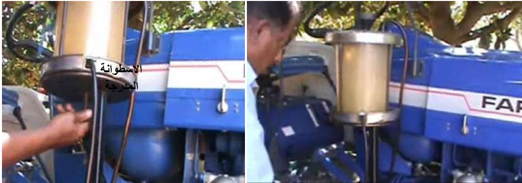
شكل (2-1) تثبيت الاسطوانة المدرجة على الساحة الزراعية
