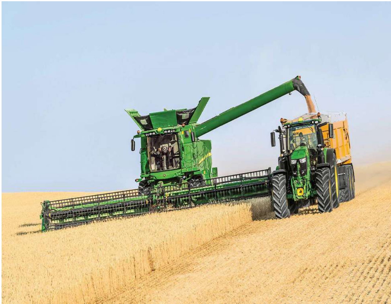
الشكل (4-17) تفريغ الحبوب من خزان الحاصدة إلى عربة النقل
