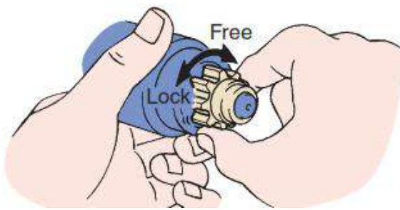
شكل (1-59) افحص ملفات محرك بدء الحركة شكل (1-60) فحص ترس محرك
