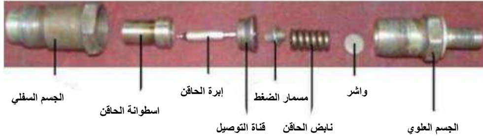
شكل (18-1) أجزاء الحاقن الميكانيكي
