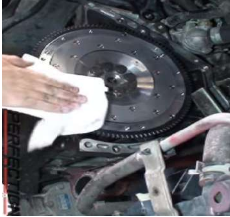
شكل (2-7) عدم وصول أي زيوت أو شحوم الى الفاصل
