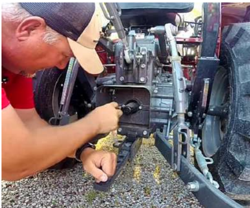
الشكل (39-2) تهيئة وتجهيز عمود P.T.O
