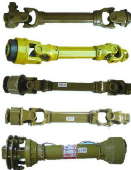
شكل(2-45) اختيار عمود إدارة خلفي مناسب
