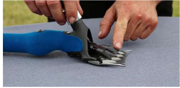
شكل(53-5) التأكد من ولوج المسامير المخروطية في الثقوب المخصصة لها مع زيادة الضغط بواسطة صامولة الضغط
