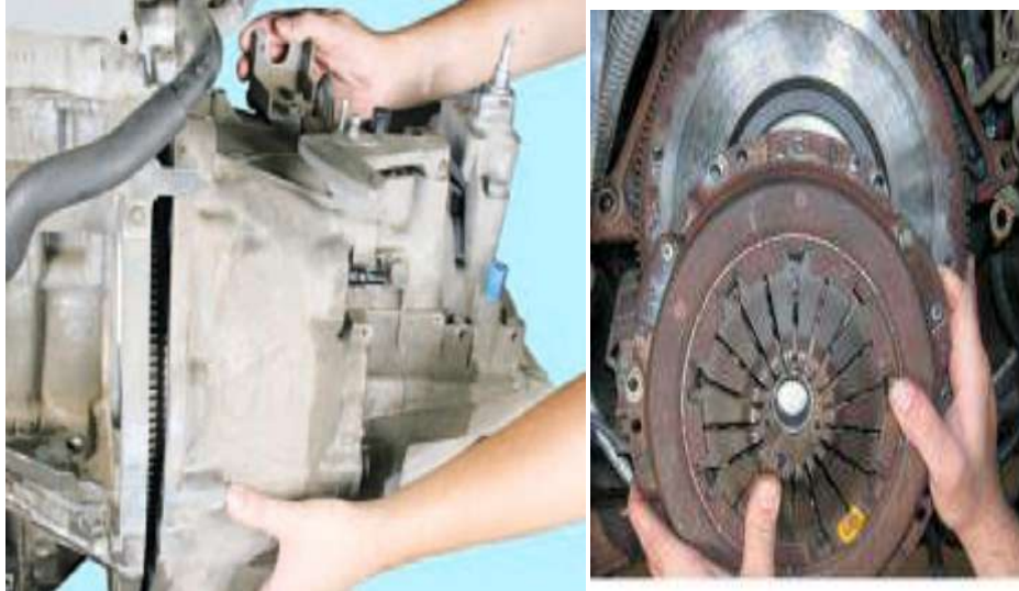
شكل (6-2) فصل الفاصل (Clutch) يعني فصل جهاز الفاصل عن المحرك
