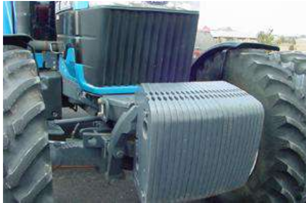
شكل (3-59) ثقلات من حديد الزهر يمكن تغييرها بسهولة وفقاً لاحتياجات الوزن
