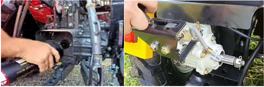
الشكل (2-4) اختبار P.T.O بعد ربطه مع عمود الإدارة الخلفي
