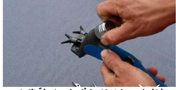
شكل (5-47) ارخاء ( فتح ) صامولة التحكم بضغط المشط الامامي
