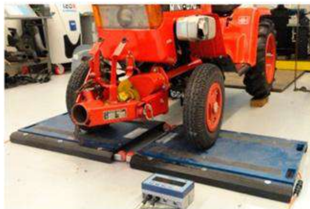
شكل (3-69) قياس قوة رد الفعل على الاطارات الامامية
