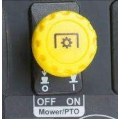
الشكل (49-2) تشغيل مأخذ (P.T.O) بسرعة 450rpm إلى 1000 rpm
