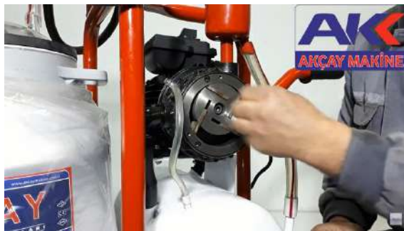
شكل(5-35) تحريك الجزء الدوار للتأكد من انزلاق الألواح
