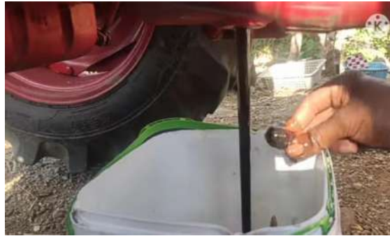
شكل (2-11) تفريغ الزيت من صندوق التروس
