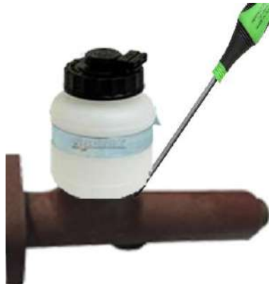
شكل (29-1) فتح لولب تثبيت غطاء البلاستيكي من جسم الاسطوانة
