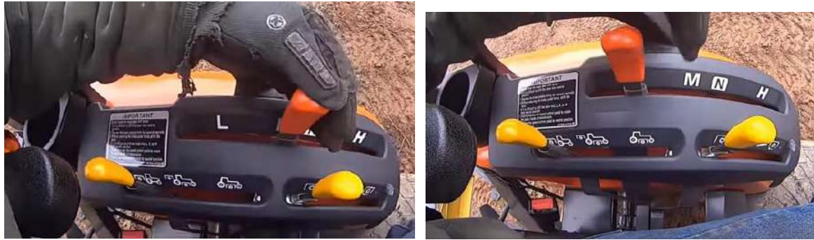
الشكل (2-43) تشغيل الجهاز الهيدروليكي
