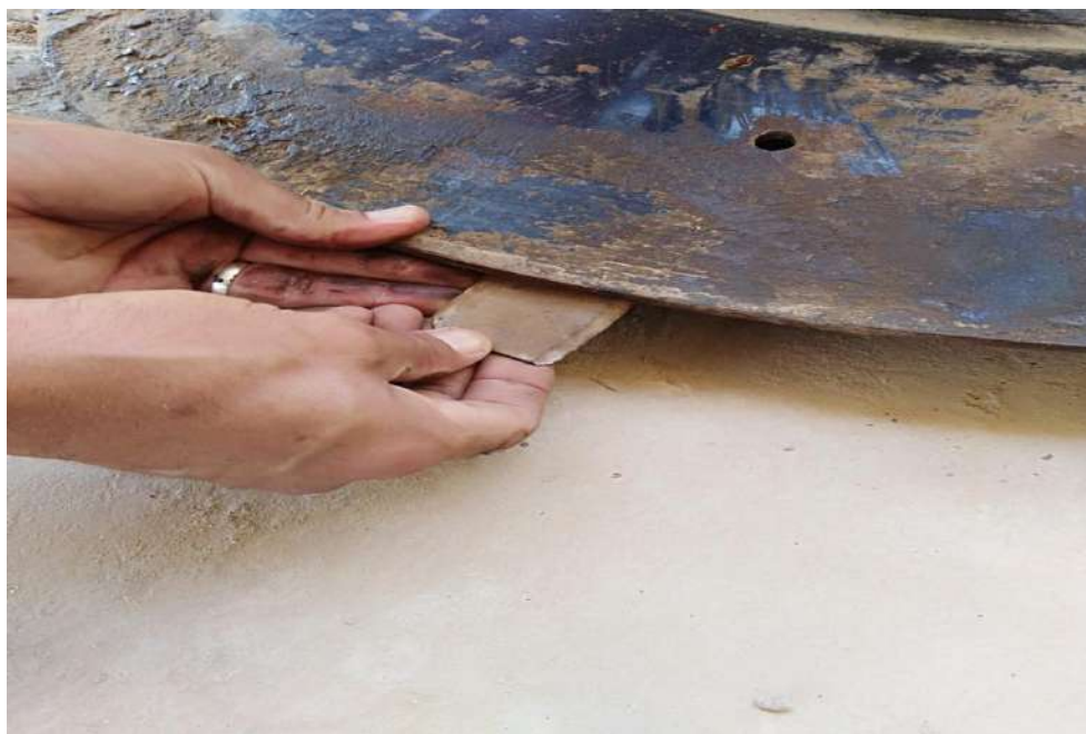
الشكل (4-40) طريقة فحص الشفرات واستبدالها
