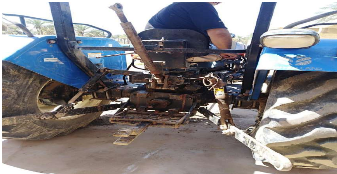
الشكل (4-30) طريقة ارجاع الساحبة لربط المحشة
