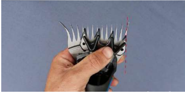
شكل (54-5) تحريك المشط المتحرك الى اقصى اليمين يدويا للتأكد من وصوله الى ابعد نقطة
