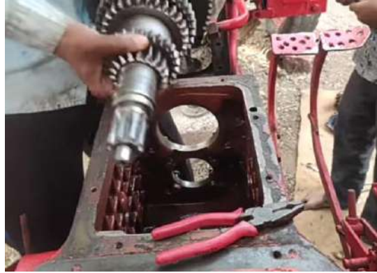
شكل (2- 16) يمثل خطوات استخراج الأعمدة
