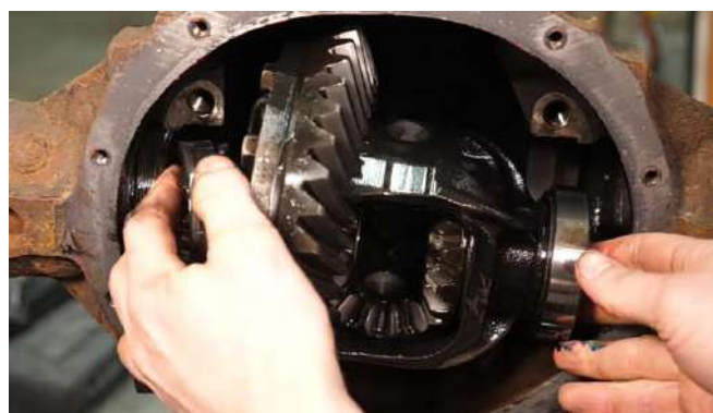
شكل (2-31) فتح مثبتات أغطية الكراسي ورفع ترس التاج مع حامل التروس الفرعية
