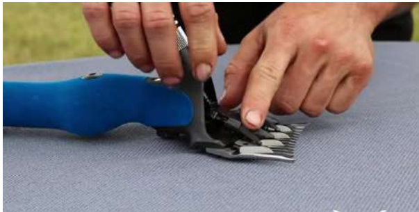
شكل(5-52) الضغط يدوياً على شوكة الحركة مع ضب صامولة الضغط بصورة بسيطة
