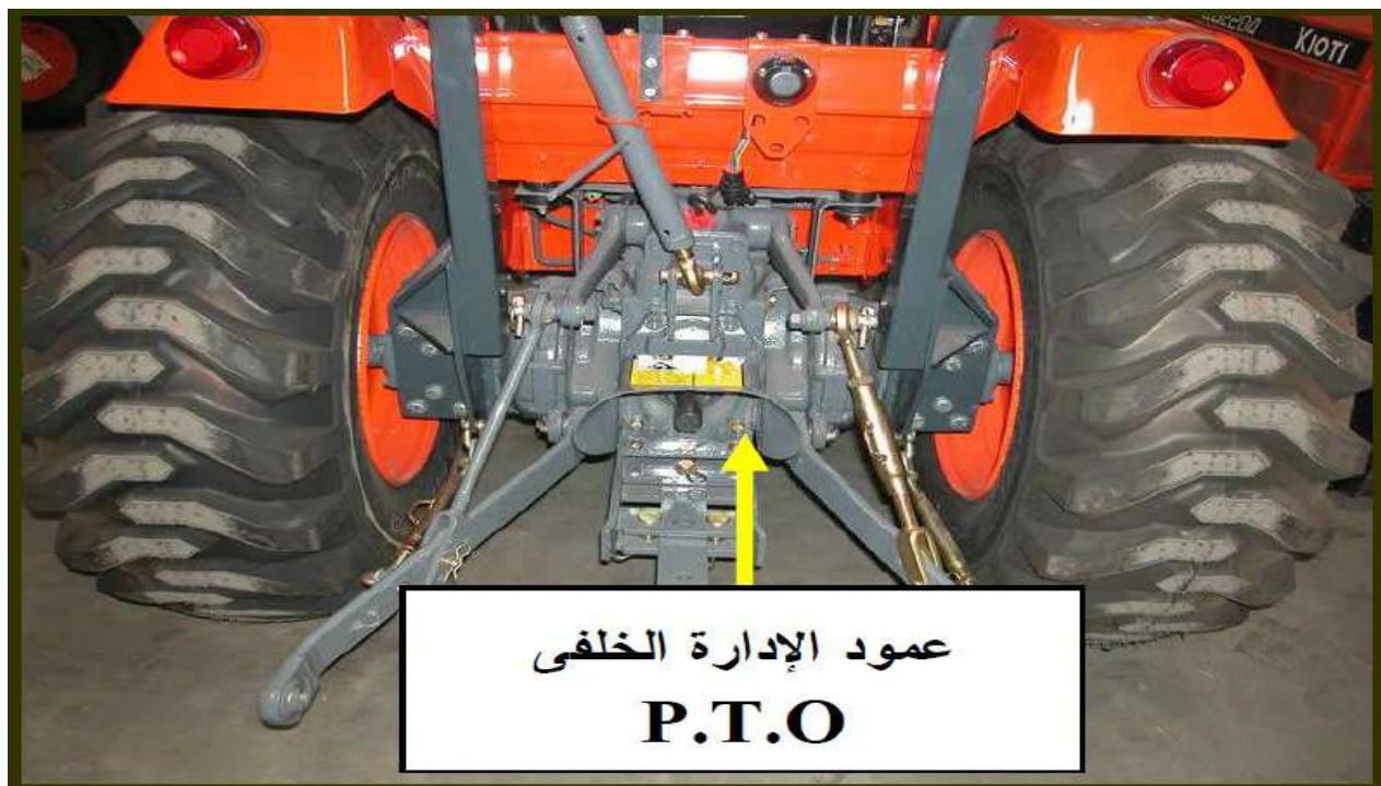
الشكل (36-4) عمود نقل الحركة الموجود في الساحبة الزراعية
