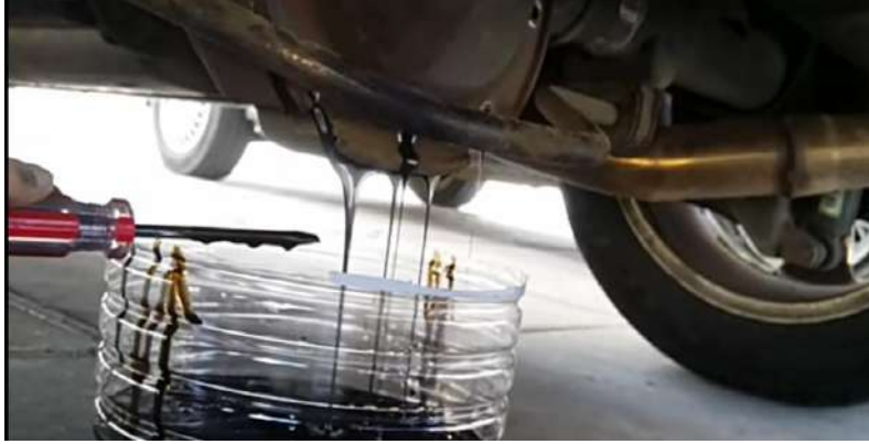
الشكل (29-2) تفريغ الزيت الموجود داخل جهاز الفرقي
