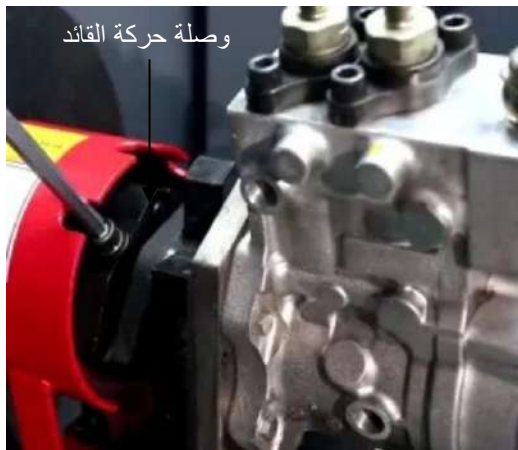
شكل (11-1) ربط وصلة تحريك مضخة
