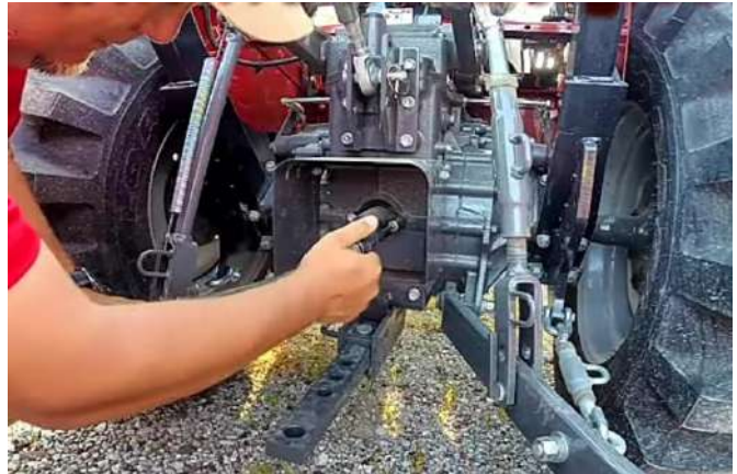
الشكل (39-2) تهيئة وتجهيز عمود P.T.O
