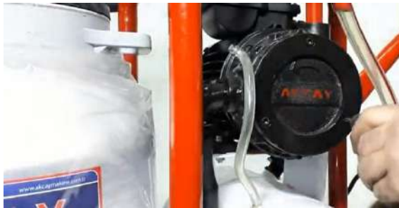
شكل (5-29) فتح براغي غطاء المضخة
