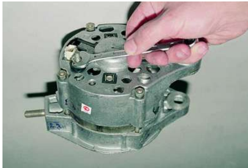
شكل (1-65) فتح صامولة تثبيت منظم الفولت
