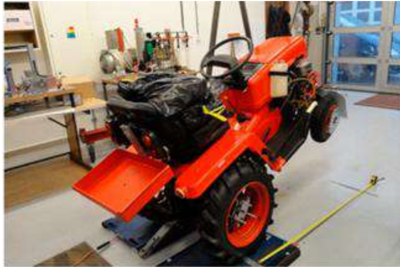
شكل (72-3) تعليق المحور الامامي بغرض تحديد ارتفاع مركز الثقل
