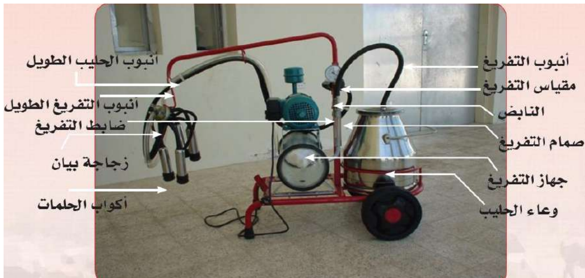
شكل (5-9) ماكينة الحلابة الفردية المتنقلة
