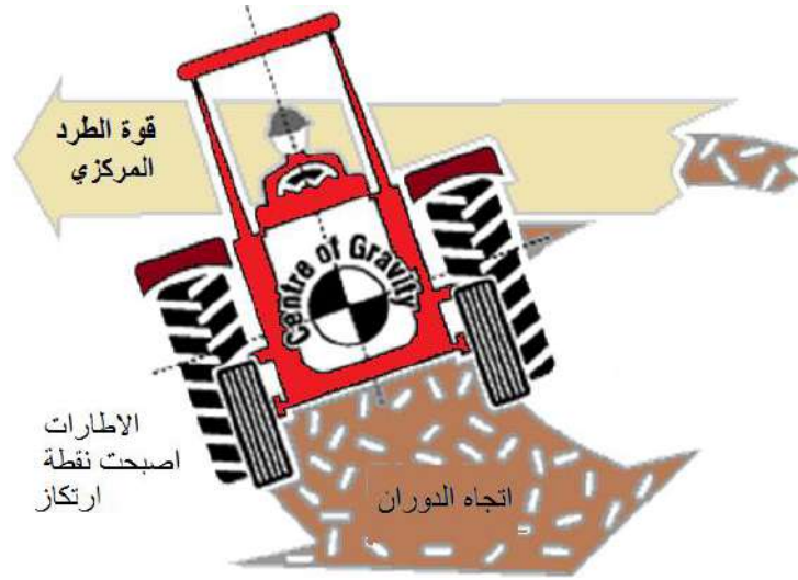
شكل (3-61) تأثير قوة الطرد المركزي عند الاستدارة بطريق منحنى
