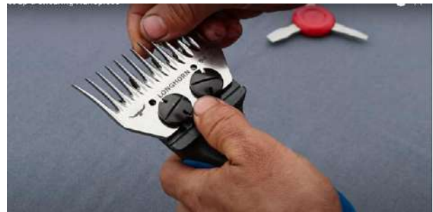
شكل(5-49) تثبيت المشط الخلفي بصورة افقيه مع ترك مسافه قليله عن القاعدة
