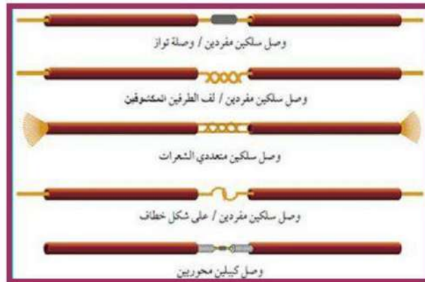
الشكل ( 1 – 27 ) التوصيل بين الأسلاك الكهربائية باللحام
