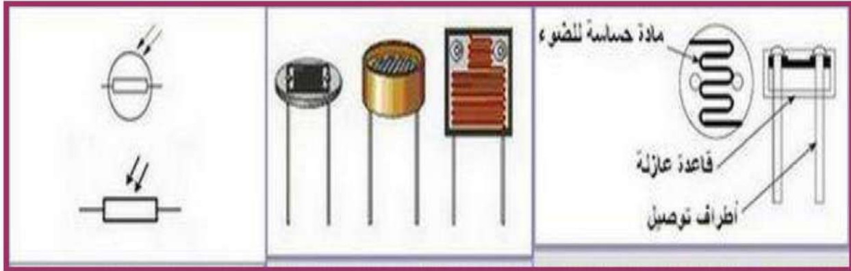
الشكل ( 2 - 14 ) رمز وشكل المقاومة الضوئية
