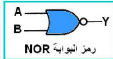
الشكل ( 7 - 9 ) رمز البوابة NOR وجدول الحقيقة
