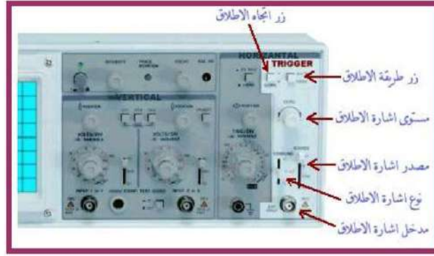
الشكل ( 1 - 16 ) مفاتيح الاطلاق لراسم الاشارة
